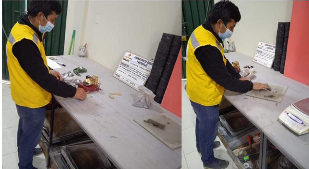
Figura 23 : Ensayos límites de atterberg en laboratorio CONGEOMAT
