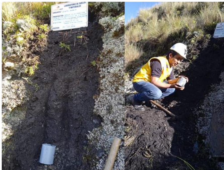
Figura 22 : extracción de muestra inalterada
