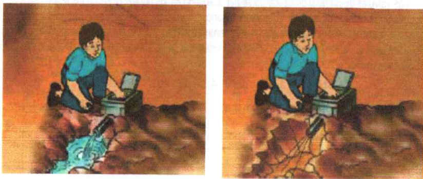
FIGURA 1.5 - OPERACIÓN DE VÁLVULAS EN LÍNEA DE CONDUCCIÓN
