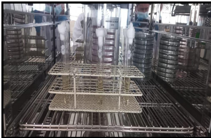
Figura N°12: Incubación de las muestras a 37^{\circ}\text{C}
