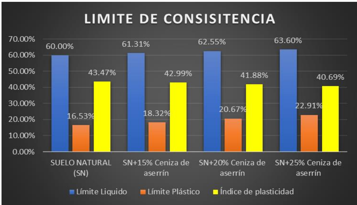
Figura 17: Grafico del Ensayo de Atterberg con la incorporación de Ceniza de Aserrín
