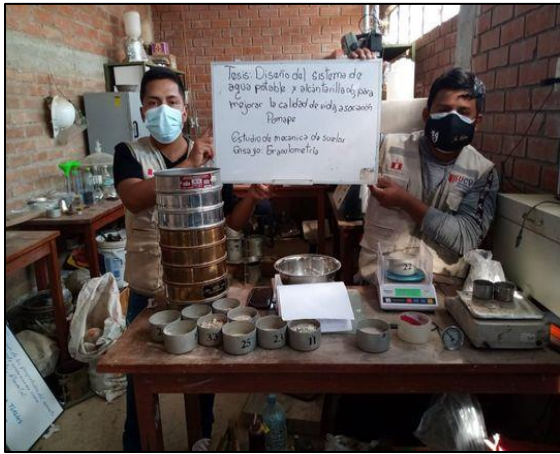
Figura 20: Ensayo de granulometría
