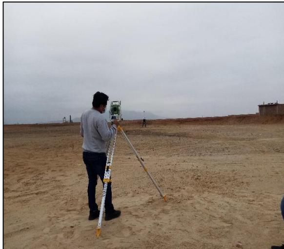
Figura 04: Levantamiento topográfico de zona de estudio
