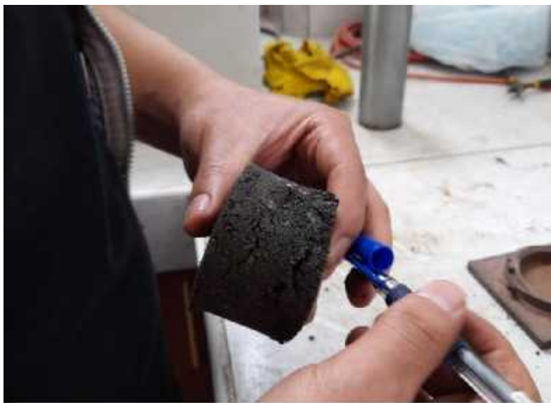
Figura 49. Briqueta 2 deformada después del ensayo
