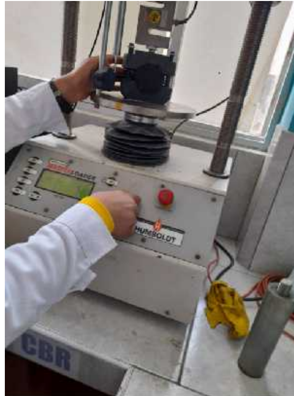
Figura 46. Briqueta N°1 – Ensayo Marshall
