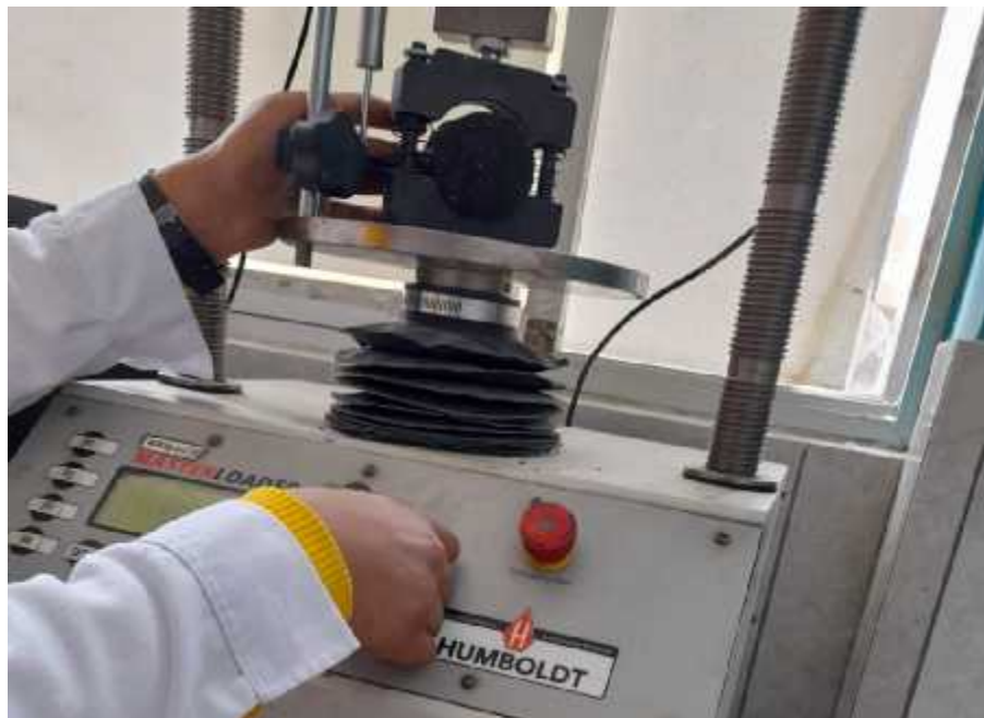
Figura 47. Briqueta N°2 – Ensayo Marshall
