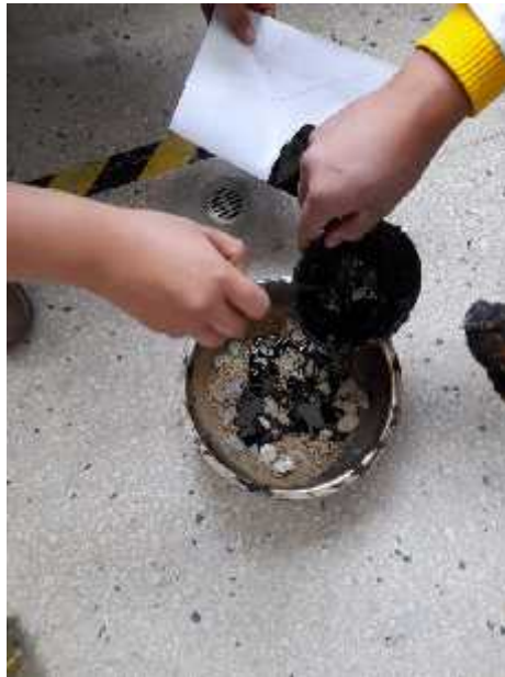
Figura 43. Adición de asfalto a la mezcla
