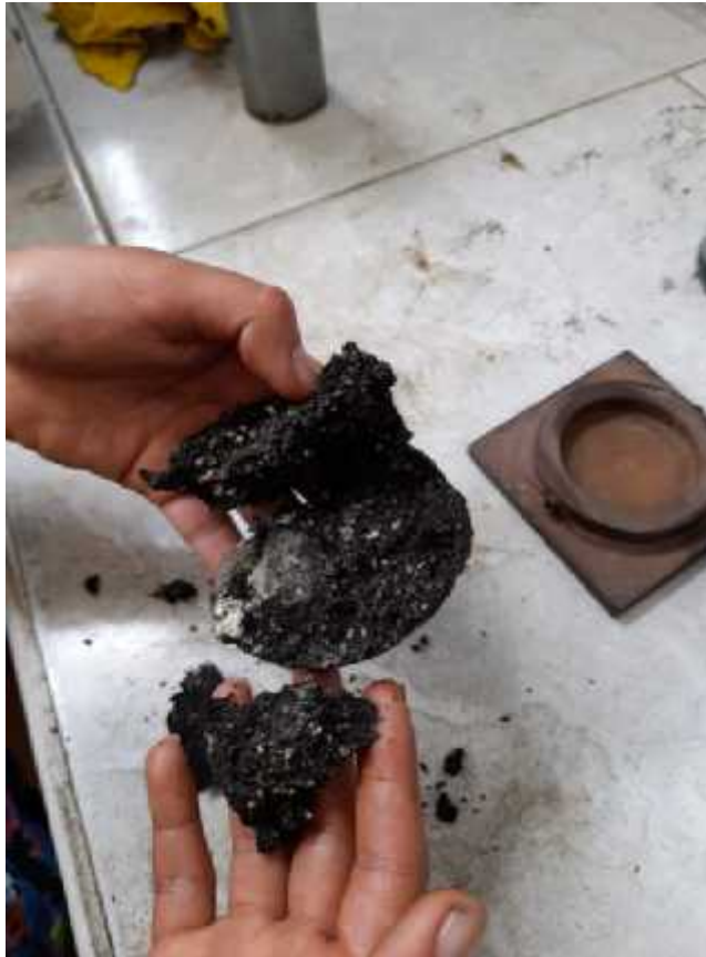
Figura 48. Briqueta 1 deformada después del ensayo
