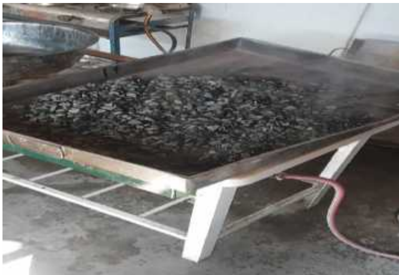
Figura 39. Lavado y secado del agregado grueso
