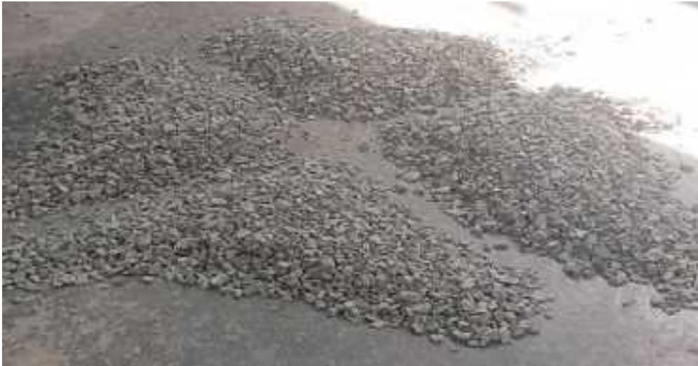
Figura 38. Se cuartea el agregado grueso
