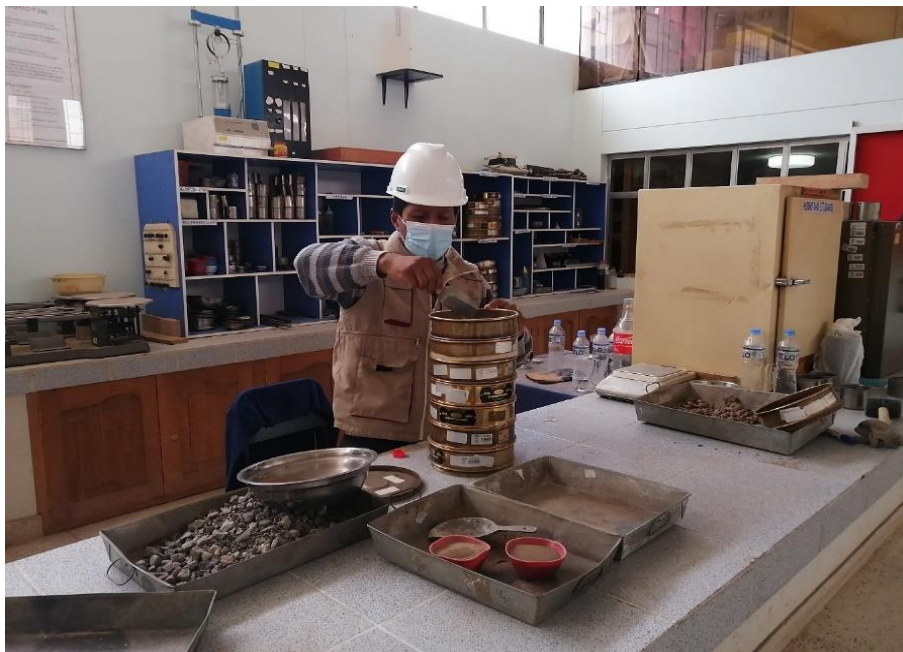
Tamizado para obtener granulometría
