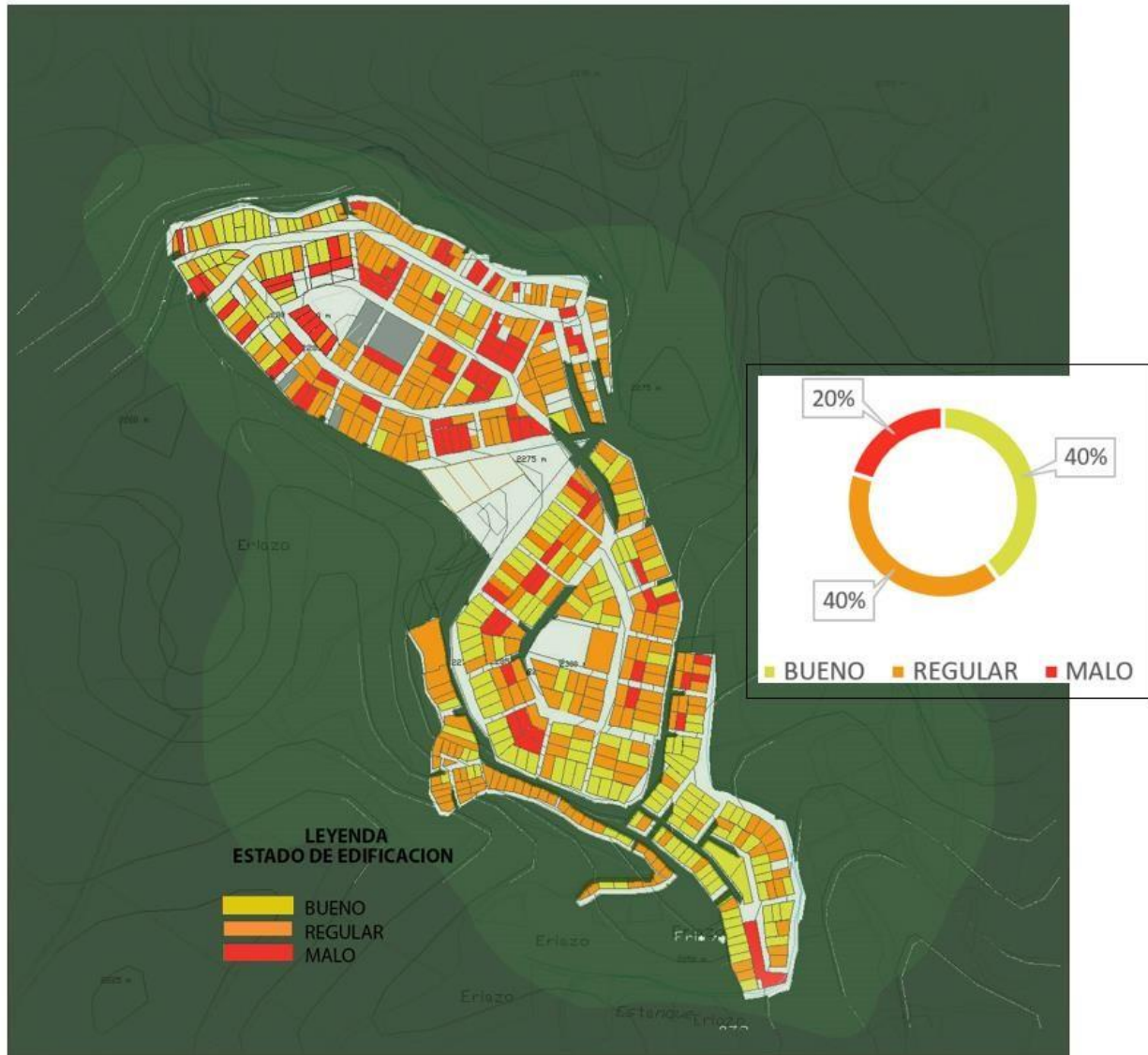
Figura24: Estado de edificación - Sector de estudio.
