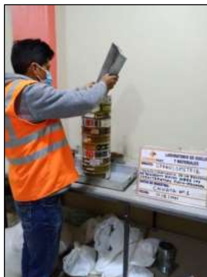
Figura 13. Ensayo granulométrico de la muestra de suelo
