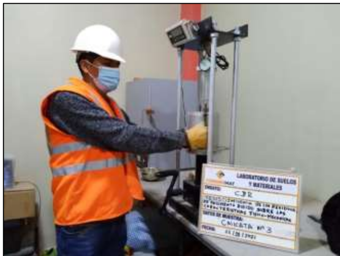
Figura 20. Aplicación de la carga en la prensa CBR
