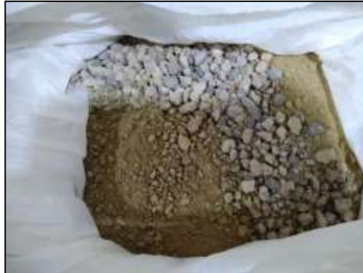
Figura 12. Mezclado de la muestra de suelo y los residuos de pavimento rígido
