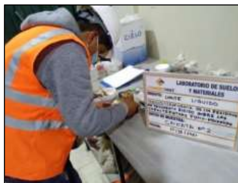
Figura 14. Obtención del límite líquido de la muestra de suelo Fuente. Toma propia
