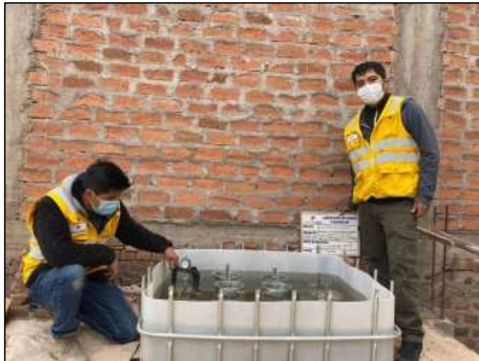
Figura 18. Sumergimiento de los especímenes para el ensayo de CBR
