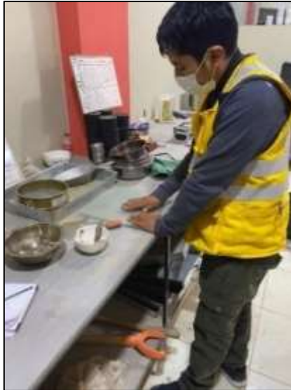
Figura 15. Elaboración de los bastoncitos con la muestra de suelo
