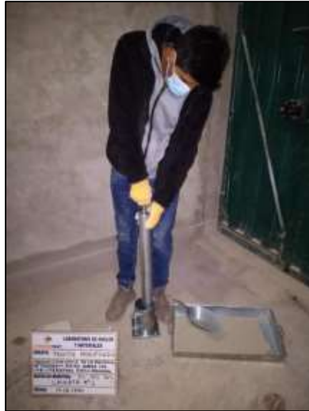
Figura 16. Ensayo de Proctor Modificado
