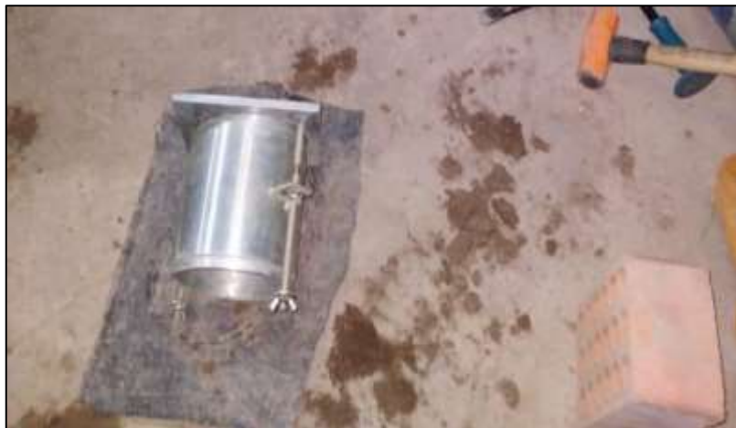
Figura 19. Escurrimiento del agua del molde previo al ensayo de CBR
