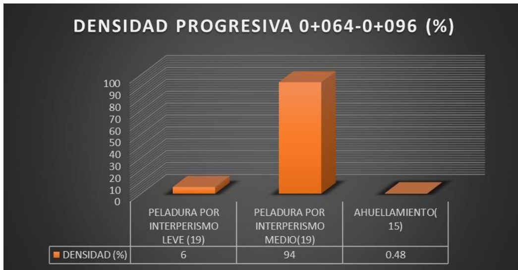
Figura N°4.-Fallas presentes- Tramo 3-(0+064 – 0+096)
