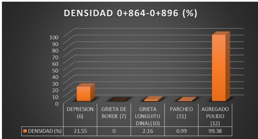
Figura N°29.-Fallas presentes- Tramo 28-(0+864 – 0+896)
