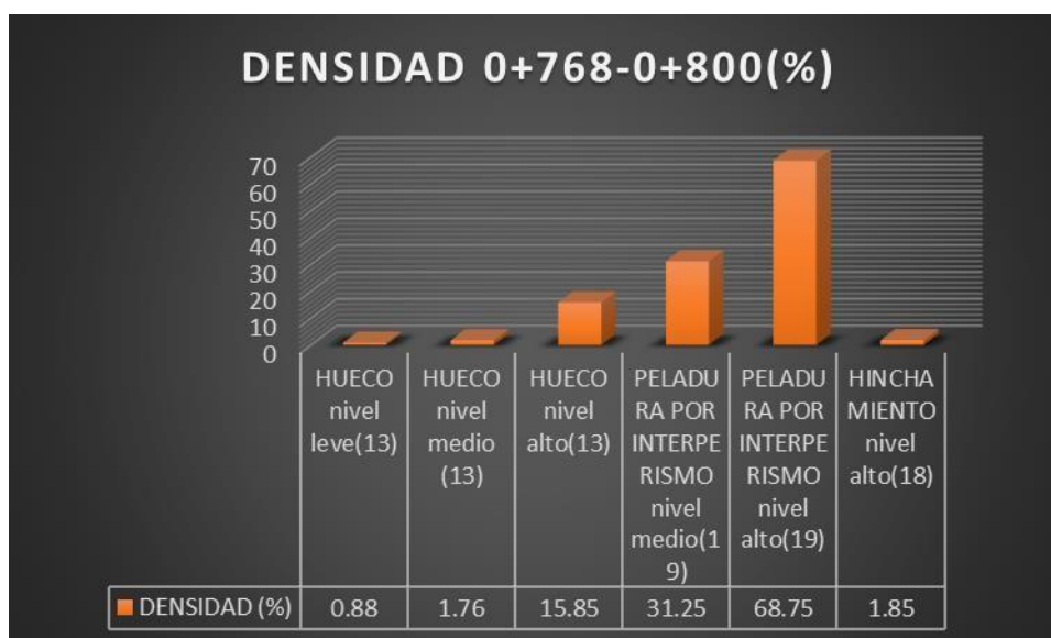
Figura N°26.-Fallas presentes- Tramo 25-(0+768 – 0+800)
