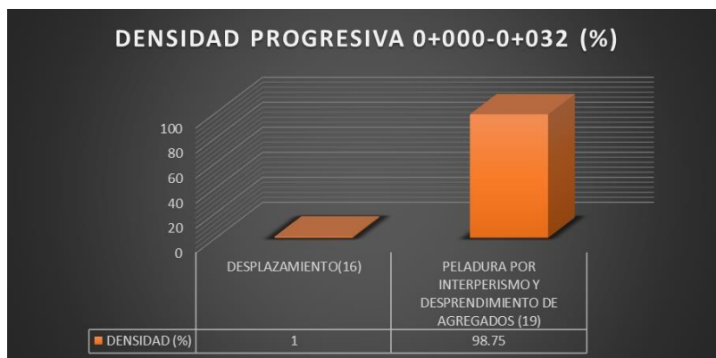
Figura N°1.-Fallas presentes- Tramo 1-(0+000 – 0+032)
