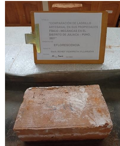
Figura 32. Ensayo de presencia de eflorescencia a las unidades de albañilería en la ladrillera 3.
