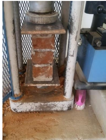
Figura 35. Ensayo de resistencia a compresión axial en pilas de albañilería en la ladrillera 2.
