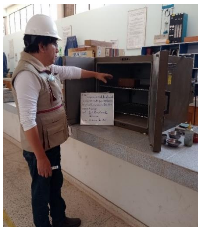
Figura 19. Ensayo de absorción a los ladrillos artesanales en la ladrillera 2.
