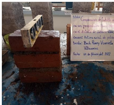
Fotografía 17. Nivelación de la pila de ladrillo artesanal.
