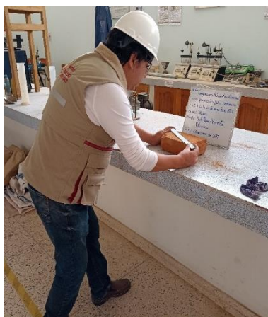
Figura 15. Ensayo de alabeo a las unidades de albañilería en la ladrillera 2.
