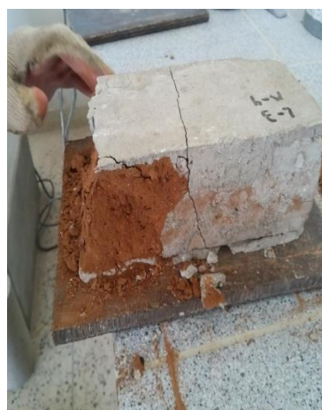
Figura 39. Resultado de falla del ladrillo artesanal puesto a compresión axial de la ladrillera 2.
