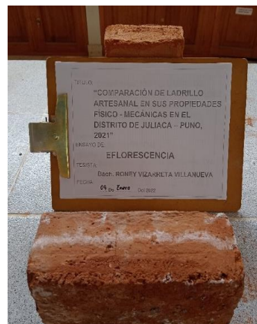
Figura 31. Ensayo de presencia de eflorescencia a las unidades de albañilería en la ladrillera 2.
