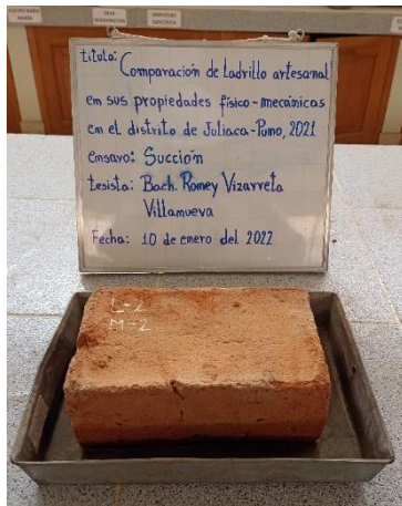
Figura 22. Ensayo de succión a las unidades de albañilería en la ladrillera 1.
