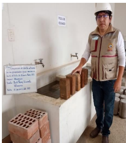
Figura 18. Ensayo de absorción a los ladrillos artesanales en la ladrillera 1.
