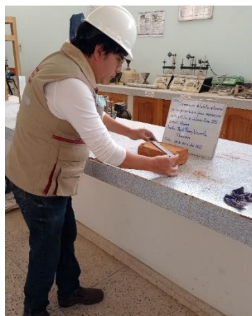
Figura 27. Ensayo de variación dimensional a las unidades de albañilería en la ladrillera 2.
