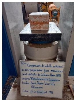
Fotografía 8. Ensayo de resistencia a compresión del ladrillo artesanal.
