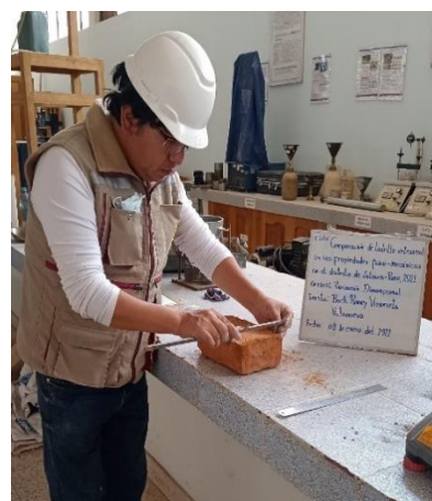
Figura 28. Ensayo de variación dimensional a las unidades de albañilería en la ladrillera 3.
