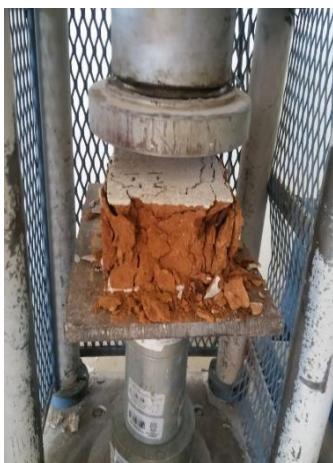
Figura 38. Rotura de la unidad de albañilería del ladrillo artesanal en la ladrillera 1.
