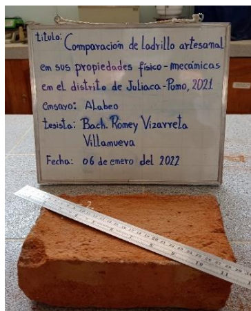
Figura 14. Ensayo de alabeo a las unidades de albañilería en la ladrillera 1.
