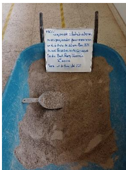
Fotografía 16. Mezcla para la elaboración de mortero.
