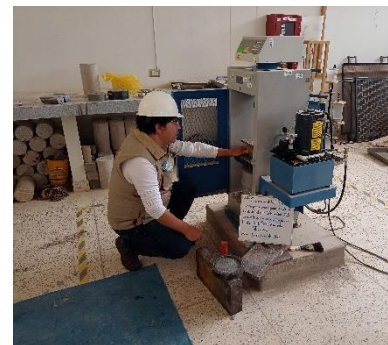
Fotografía 18. Ensayo de Compresión a la unidad de albañilería – ladrillo artesanal.
