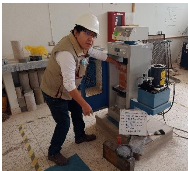
Fotografía 7. Ensayo de rotura axial en pilas de ladrillos
