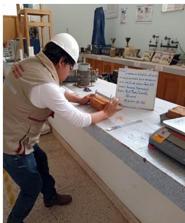
Figura 26. Ensayo de variación dimensional a las unidades de albañilería en la ladrillera 1.
