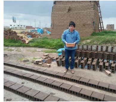
Fotografía 3. Moldeo y secado de ladrillo artesanal a campo abierto
