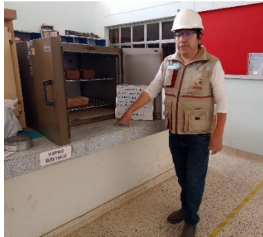
Fotografía 10. Secado de Ladrillos en horno a 110°C.
