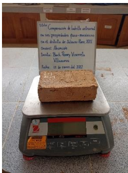
Fotografía 13. Medición inicial del peso del ladrillo.
