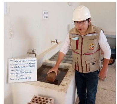
Fotografía 9. Saturación de los ladrillos artesanales para ensayo de absorción.
