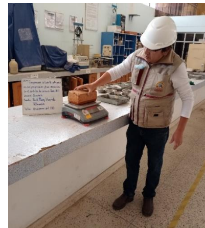
Figura 24. Ensayo de succión a las unidades de albañilería en la ladrillera 3.
