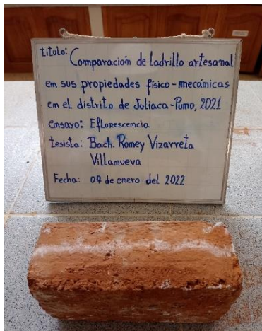
Figura 30. Ensayo de presencia de eflorescencia a las unidades de albañilería en la ladrillera 1.
