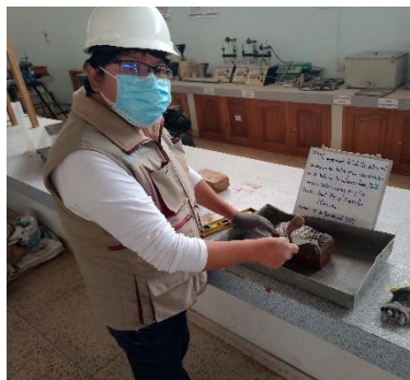
Fotografía 14. Elaboración de la pila de ladrillo.
