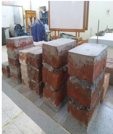
Figura 34. Pilas de albañilería de ladrillos artesanales de la ladrillera 1.
