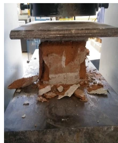
Figura 40. Ensayo de rotura a compresión del ladrillo artesanal de la ladrillera 3.
