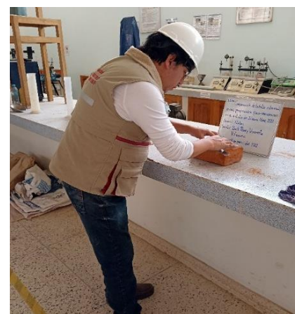
Figura 16. Ensayo de alabeo a las unidades de albañilería en la ladrillera 3.
