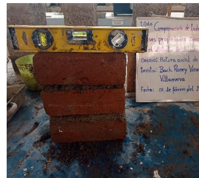
Fotografía 15. Nivelación de la pila de ladrillo.
