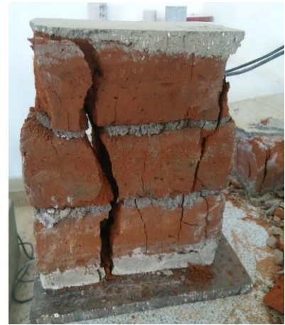
Figura 36. Rotura de axial en pilas de albañilería de ladrillos artesanales en la ladrillera 3.
