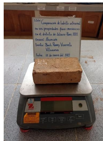
Figura 20. Ensayo de absorción a los ladrillos artesanales en la ladrillera 3.
