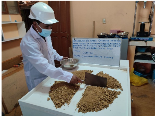
Figura 19. Obtención de la muestra del cuarteo.
