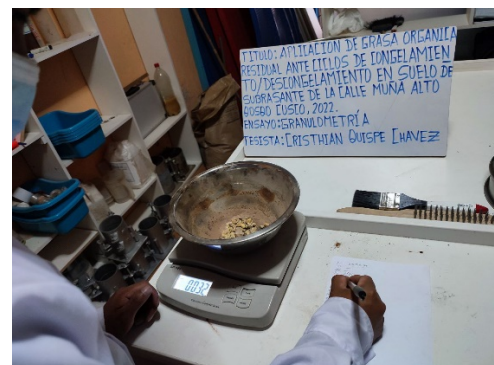
Figura 18. Registro o anote del suelo retenido en cada tamiz.
