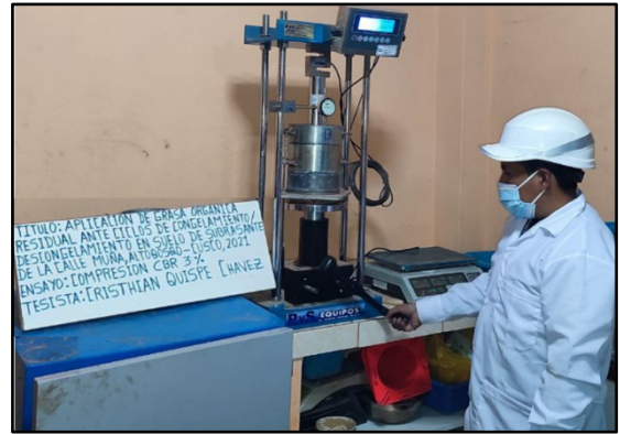
Figura 30. Prueba de resistencia del CBR en la prensa.
