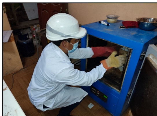
Figura 36. Secado en horno del suelo dosificado al 0%, 3%, 6% y 9% de grasa orgánica residual.
