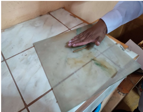
Figura 27. Adelgazamiento del rollito hasta un diámetro de 3.2mm (1/8pulg).
