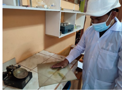
Figura 26. Amasado del suelo hasta que pierda humedad.
