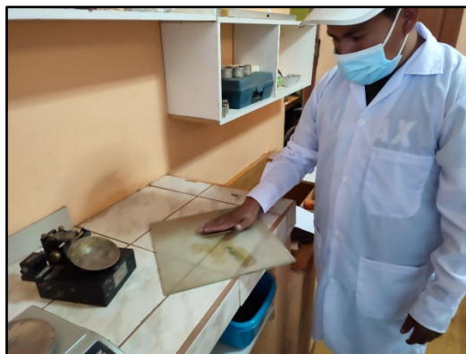
Figura 6. Prueba de limite plástico.
