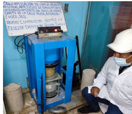
Figura 64. Colocación de la probeta en el equipo de compresión.
