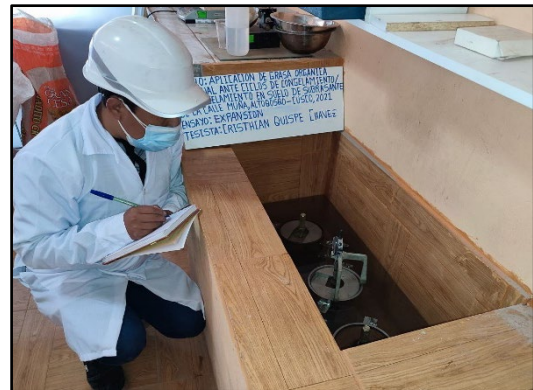
Figura 33. Lectura de expansión de las dosificaciones 0%, 3%, 6% y 9%.
