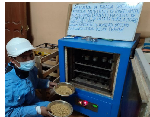
Figura 12. Secado en horno a una temperatura de 110 \pm 5^\circ .
