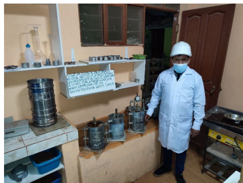
Figura 35. Después de 4 días se drena por 15 minutos aproximadamente.
