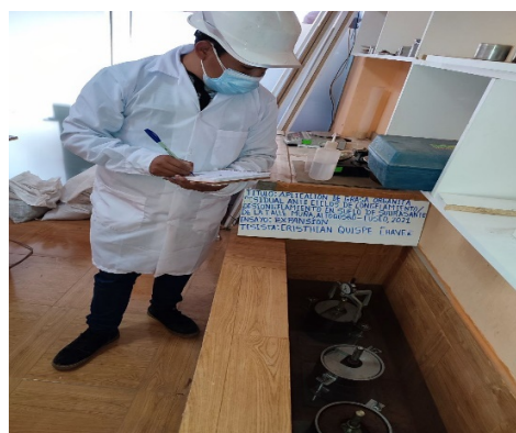
Figura 41. Lectura de la expansión del suelo.
