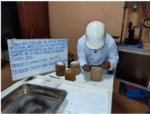
Figura 63. Medida de las dimensiones de las probetas.
