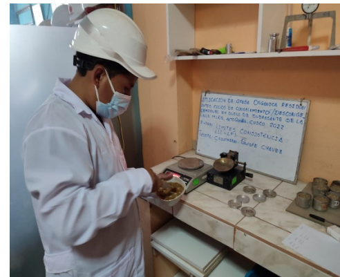
Figura 22. Mezclar con una espátula hasta tener una consistencia homogénea.
