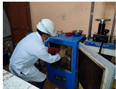
Figura 58. Secado en el horno de las probetas.
