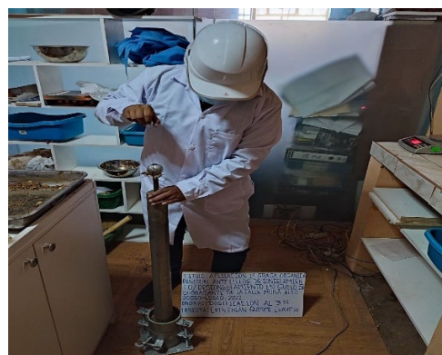
Figura 40. Golpes aplicados con el pisón en toda el área del molde.
