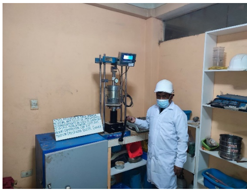
Figura 48. Prueba de resistencia del CBR en la prensa.
