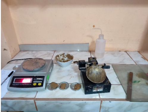
Figura 25. Se trabaja con el material del límite líquido se toma 20g aproximadamente.
