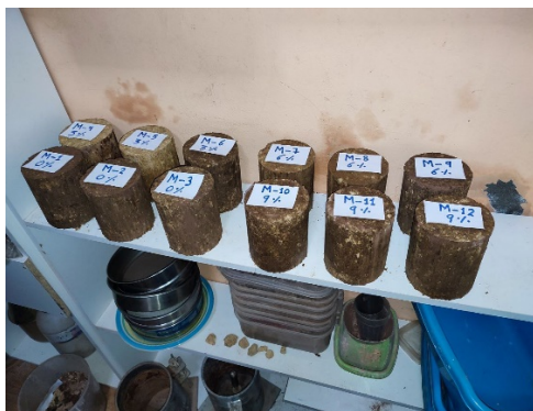
Figura 57. Probetas con las distintas dosificaciones.
