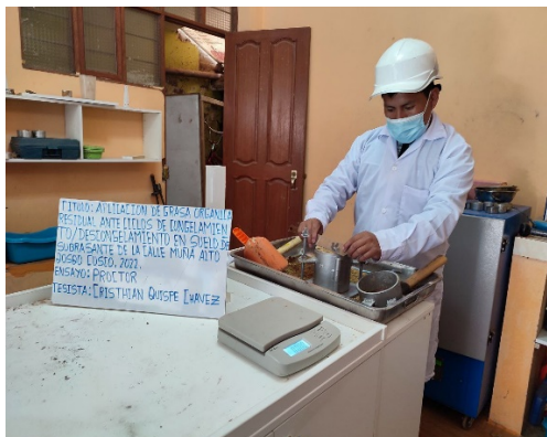
Figura 45. Enrasado del molde con una regla metálica
