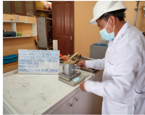
Figura 32. Registrado del peso del suelo más molde.
