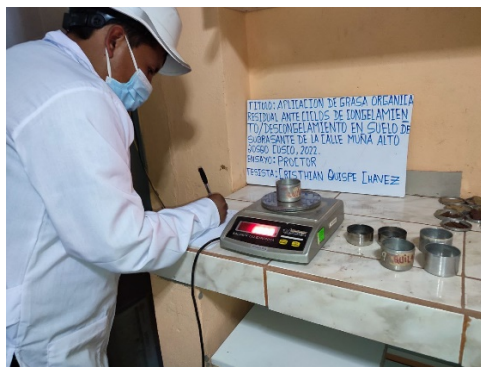
Figura 33. Pesado para el contenido de humedad.
