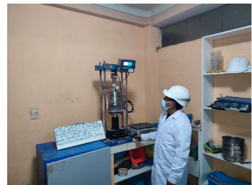
Figura 36. Prueba de resistencia del CBR en la prensa.
