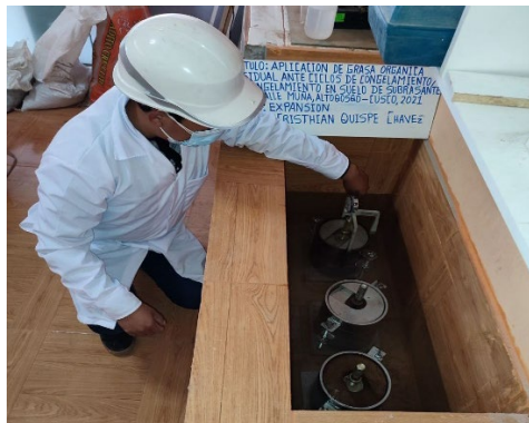
Figura 53. Lectura de la expansión del suelo.
