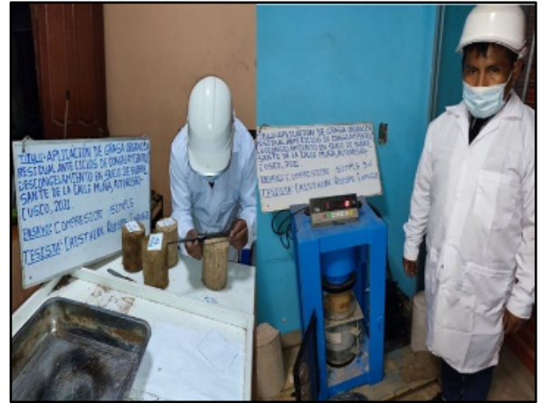
Figura 45. Ensayo de compresión simple de las probetas dosificadas.
