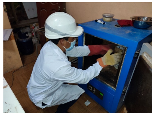
Figura 34. Llevado la muestra de suelo al horno para su contenido de humedad.
