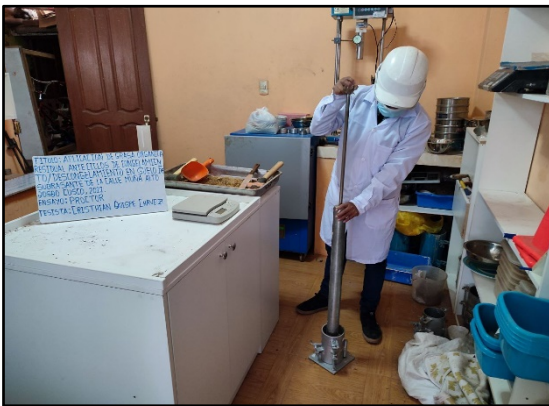
Figura 38. Compactación del suelo dosificado.
