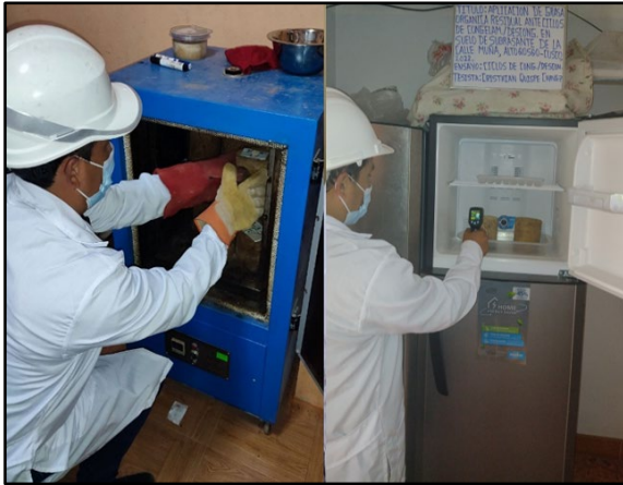
Figura 44. Ciclos de congelamiento y descongelamiento de las probetas dosificadas.
