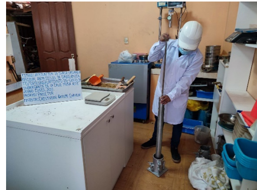
Figura 52. Golpes aplicados con el pisón en toda el área del molde.
