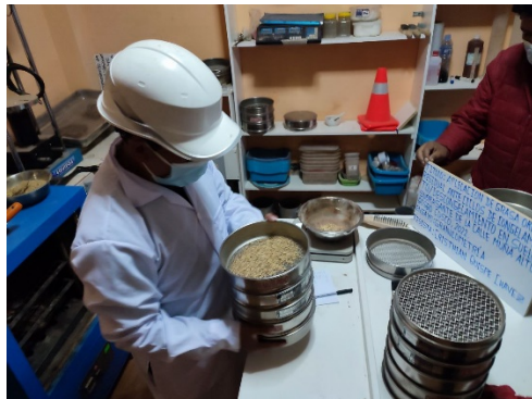
Figura 15. Tamizado de la muestra de suelo.
