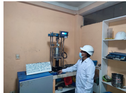
Figura 54. Prueba de resistencia del CBR en la prensa.
