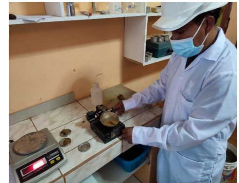
Figura 24. Movimiento de la cazuela con la ayuda de la manivela.
