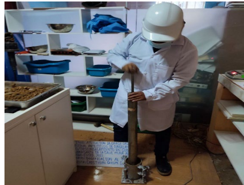
Figura 44. Golpes aplicados con el pisón en toda el área del molde.
