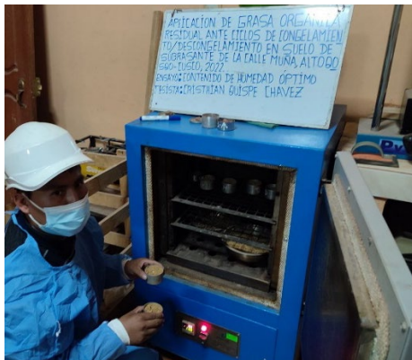
Figura 9. Secado en horno para la humedad a una temperatura de 110 \pm 5^\circ .
