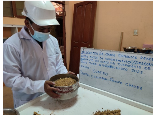
Figura 20. Tamizar en la malla N°40 aproximadamente 250g de suelo.
