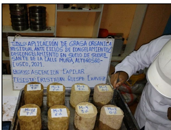
Figura 41. Medida de la altura de la ascensión capilar.
