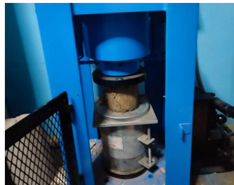
Figura 66. Falla de la probeta.
