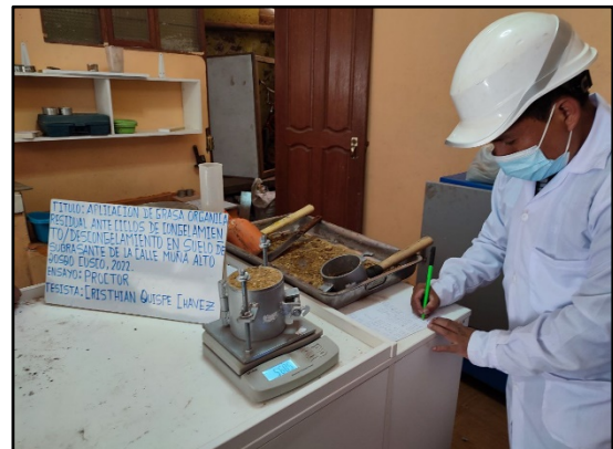
Figura 39. Lectura del suelo dosificado más molde.
