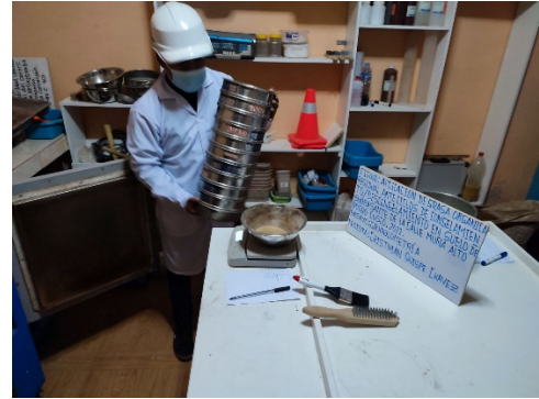
Figura 14. Tamizado de la muestra de suelo.
