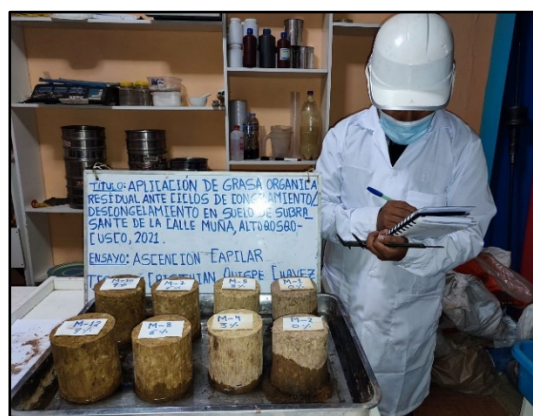
Figura 42. Registro de la lectura de la ascensión capilar.
