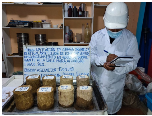
Figura 60. Registro de las lecturas de ascensión capilar.
