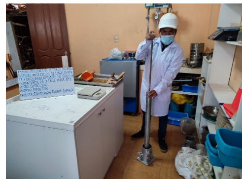
Figura 30. Golpes aplicados con el pisón en toda el área del molde.
