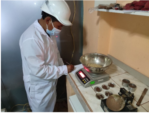
Figura 13. Pesado del suelo lavado y secado en horno.
