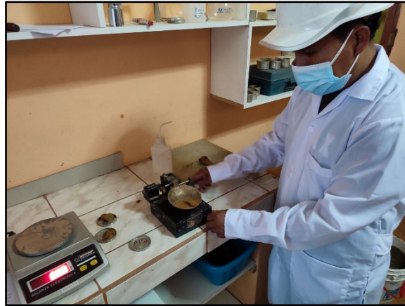
Figura 5. Prueba de limite líquido.
