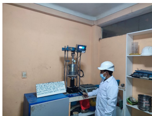
Figura 42. Prueba de resistencia del CBR en la prensa.
