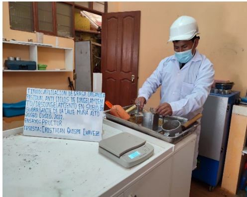
Figura 31. Enrasado del molde con una regla metálica.
