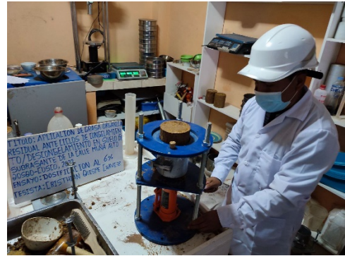
Figura 56. Obtención de probetas de la prensa extractora.
