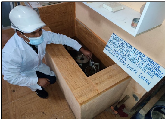
Figura 32. Colocación del aparato medidor de expansión.
