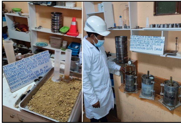
Figura 29. Moldes CBR con la adición de grasa orgánica residual (3%, 6% y 9%).
