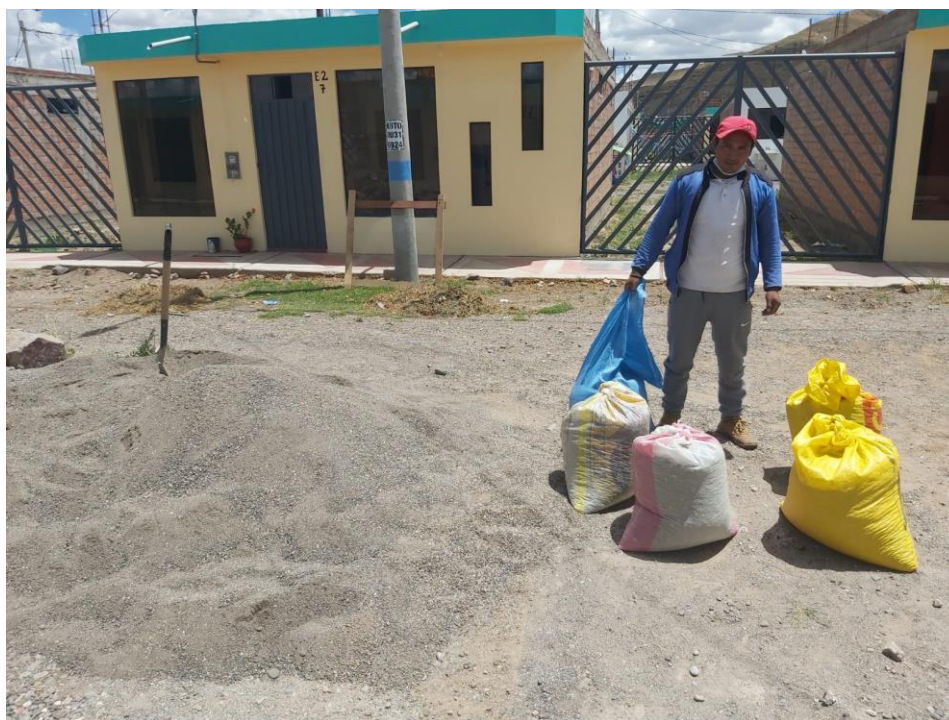
Figura 16: Material fino sobrante después del zarandeo.
