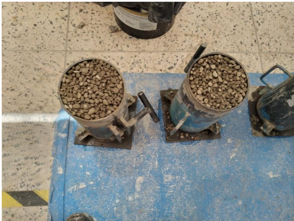
Figura 28: Muestras de probetas terminadas con adición de plastificante.
