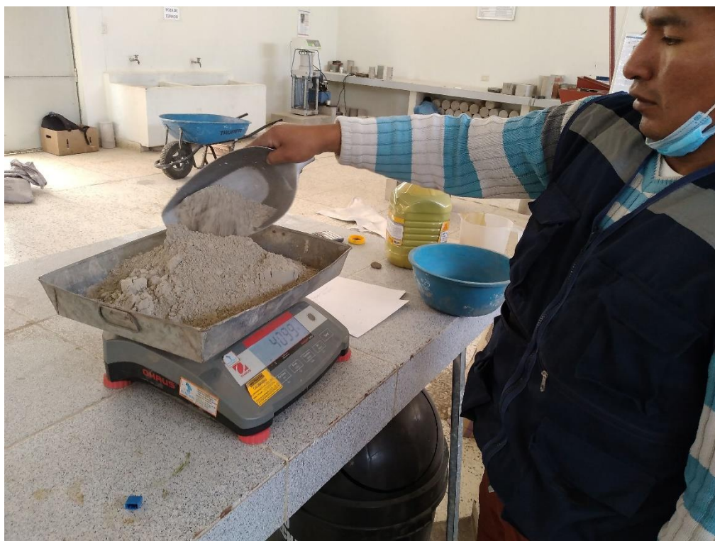
Figura 17: Realizando el pesado de cemento.
