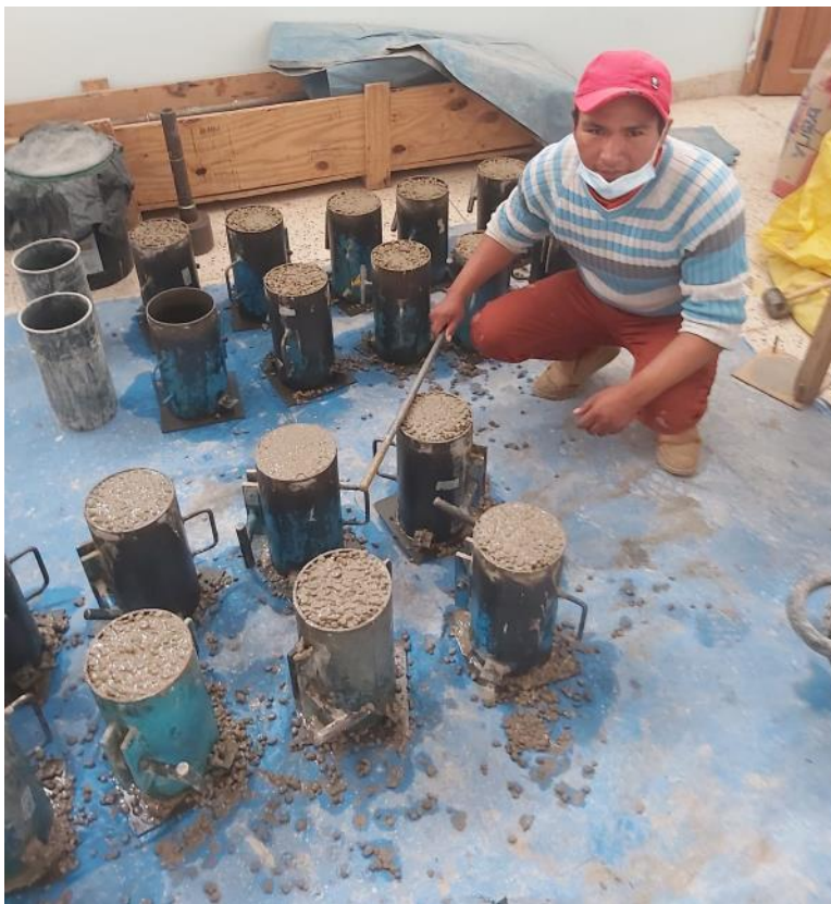
Figura 30: Vaciado de mezcla en moldes cilíndricos.
