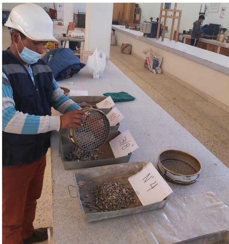
Figura 08: Seleccionando material de 3/8" para realizar los ensayos.
