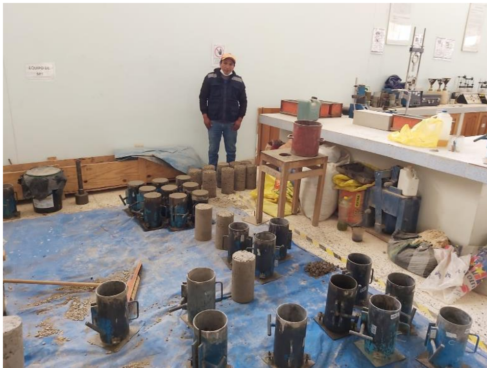
Figura 32: Desmoldando las probetas.
