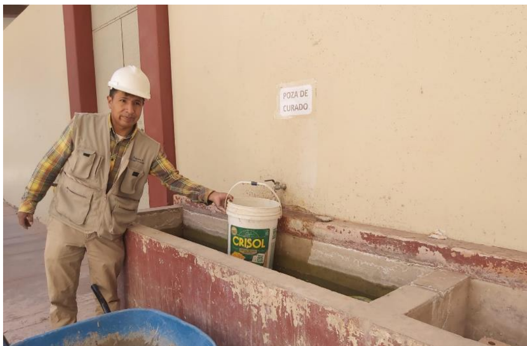
Figura 33: Preparando la poza de curado.
