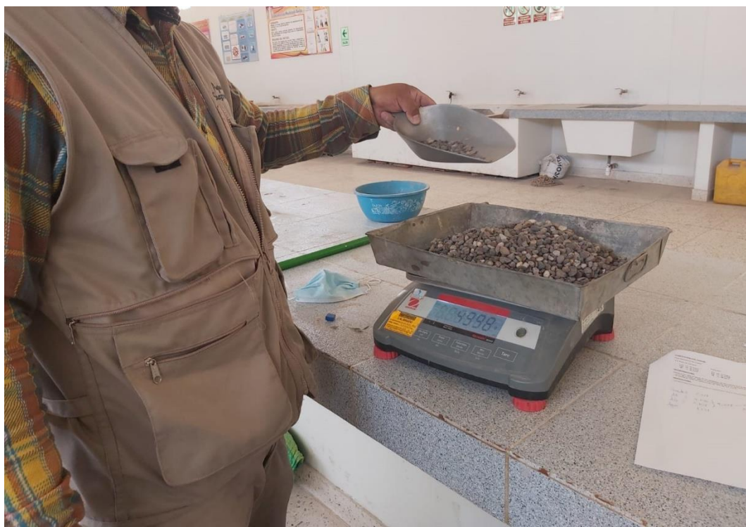
Figura 18: Realizando el pesado de agregado grueso.
