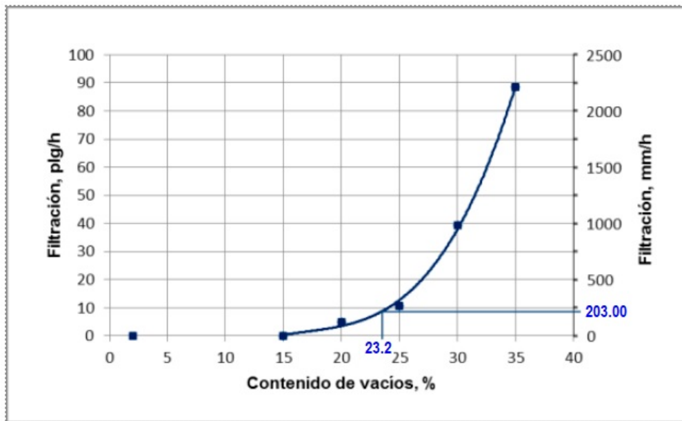
Figura 6: Curva de Relación Porcentaje de vacíos vs Filtración
