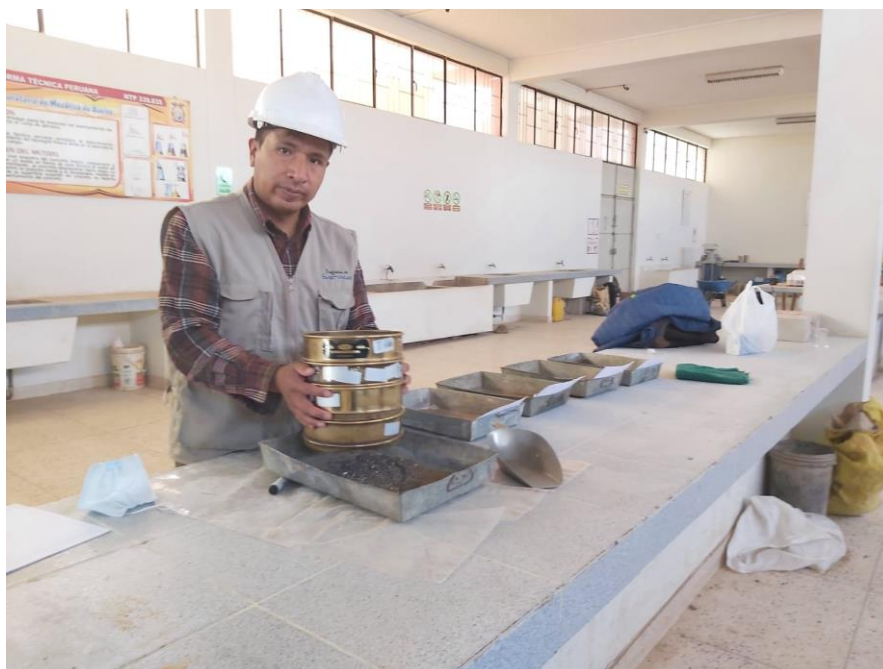
Figura 07: Realizando el tamizado de material fino para el ensayo.
