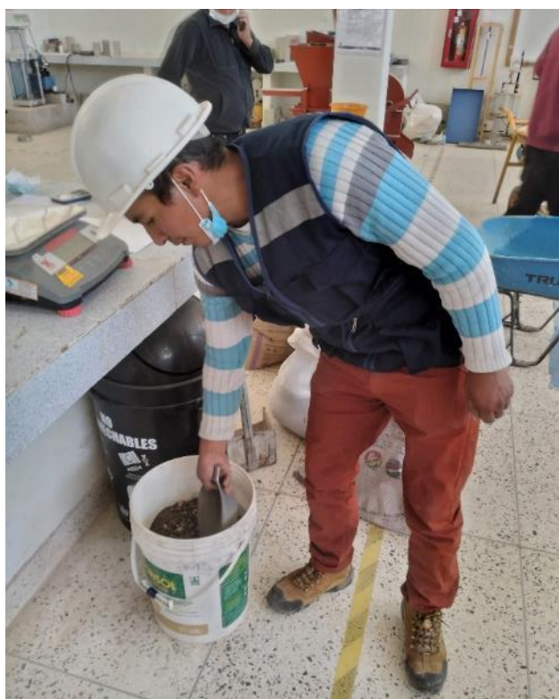
Figura 19: Acumulando material pesado de agregado grueso.
