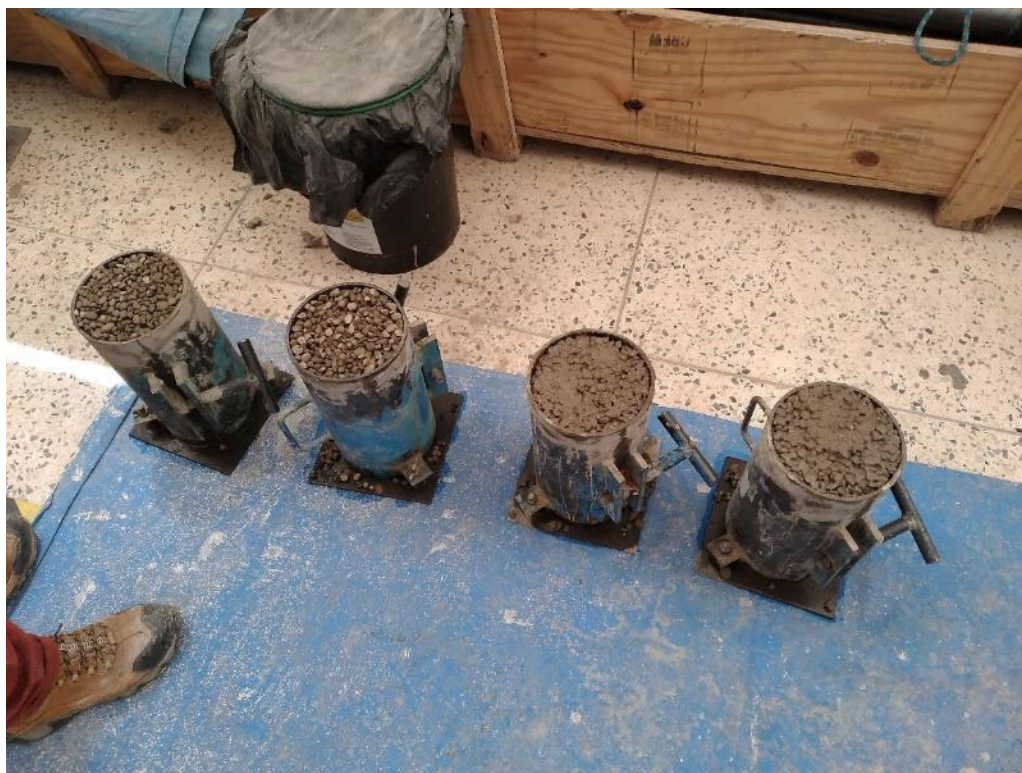
Figura 29: Primeras muestras con/sin adición de plastificante.
