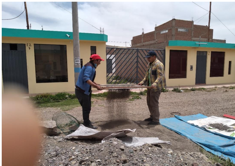
Figura 10: Zarandeando agregado grueso por la malla de \frac{3}{8} " para retenerlo, previamente paso por la malla \frac{1}{2} " para eliminar material mayor a esta medida.
