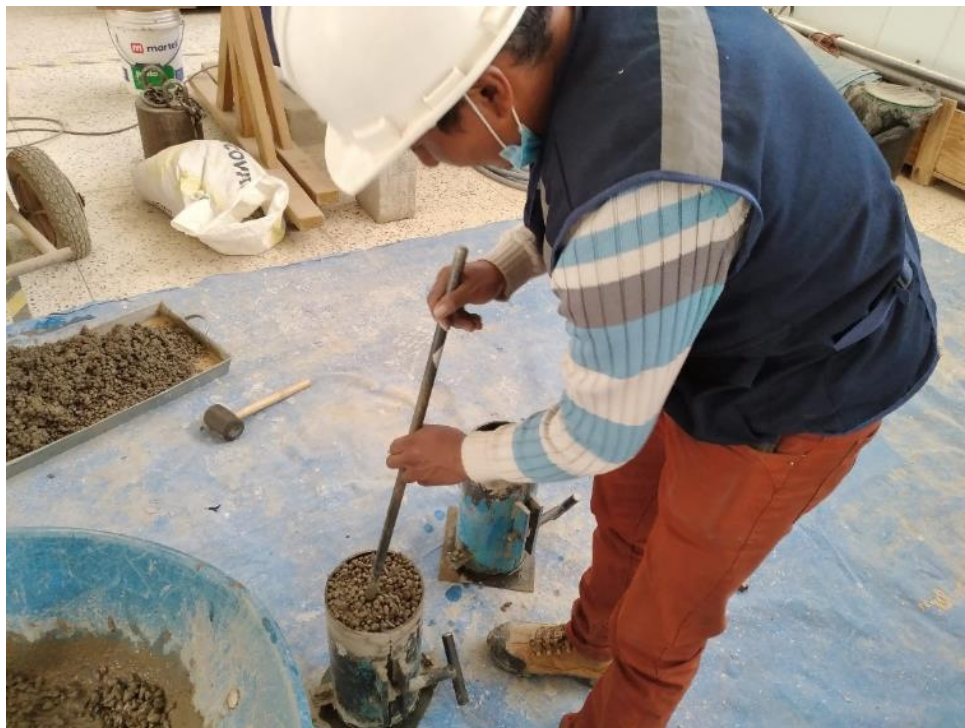
Figura 26: Realizando el último varillado.
