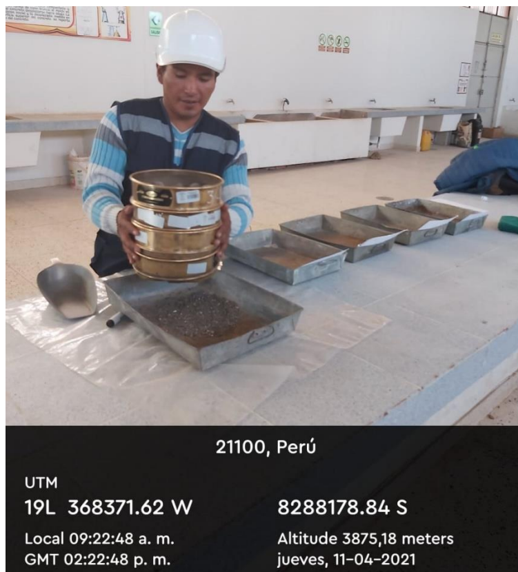
Figura 05: Realizando el tamizado de material fino para el ensayo.
