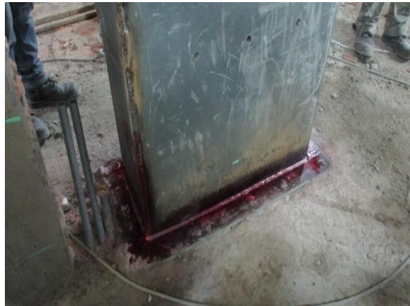
Figura 25. Ensayo de Tinta Penetrante
