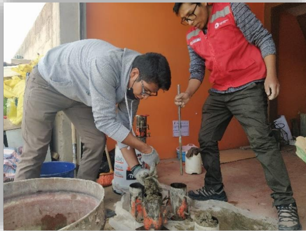
Fotografía 20. Vaciado de concreto en los moldes.
