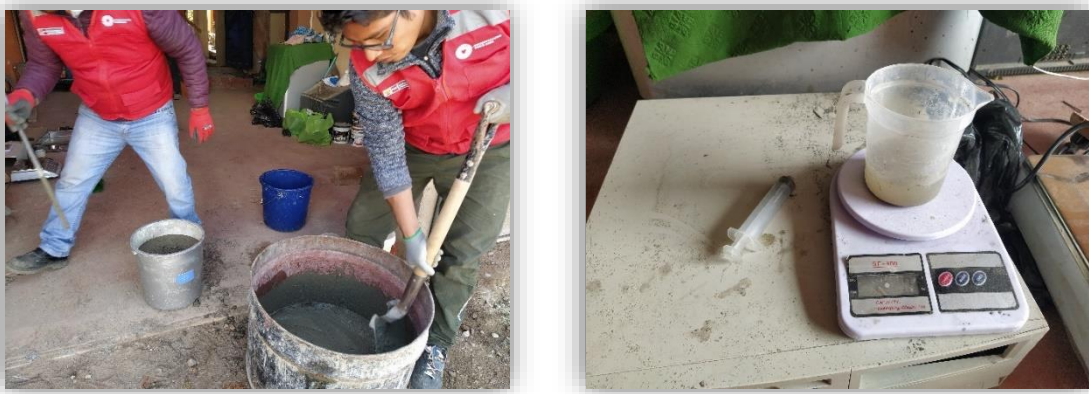
Figura 21. ensayo de exudación del concreto con adición de relave minero
