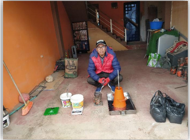
Fotografía 14-15. Preparación para el diseño de mezclas con el relave minero.
