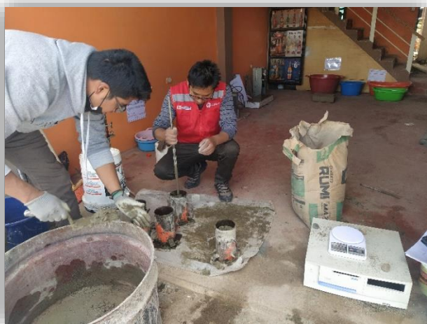
Fotografía 20. Vaciado de concreto en los moldes.
