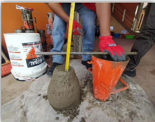
Fotografía 17. Ensayo del asentamiento en el concreto 210kg/cm2
