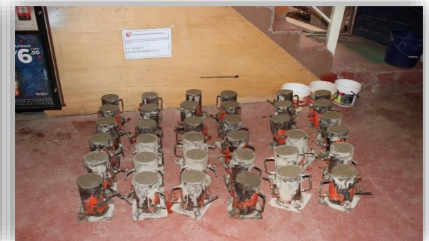
Fotografía 27-28. Moldes de probetas para el ensayo a compresión del concreto.
