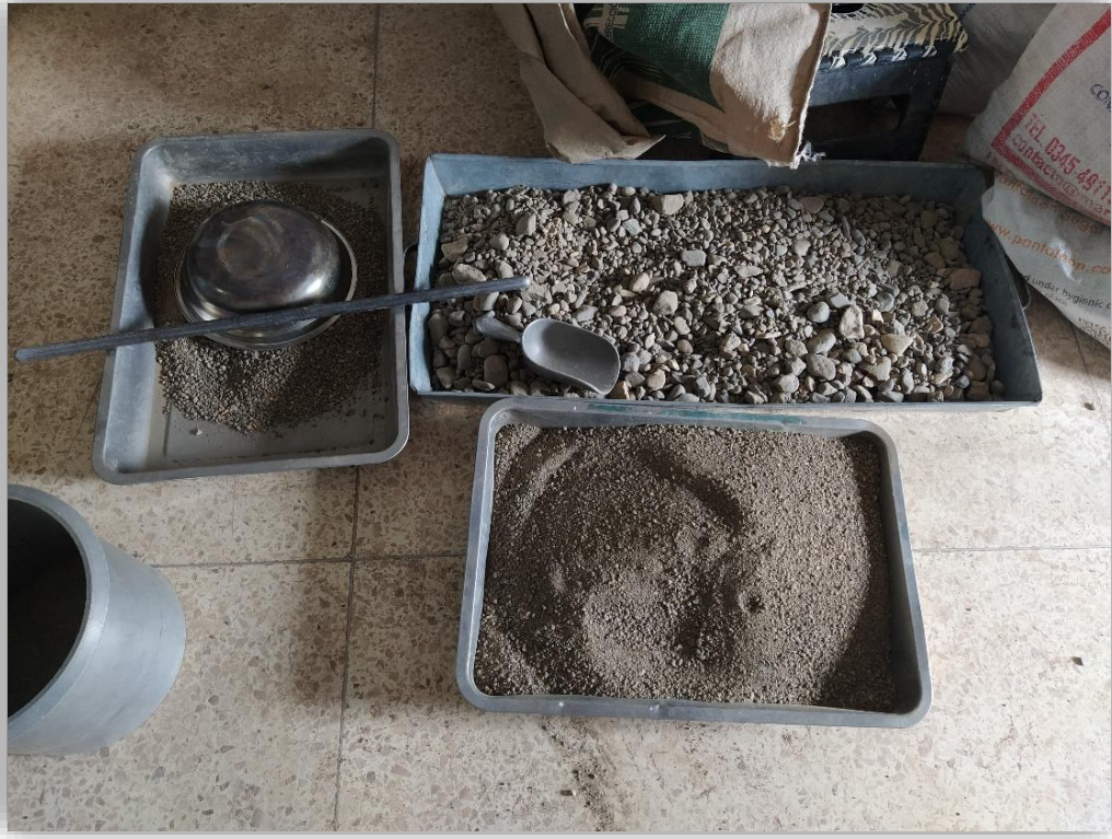
Fotografía 6. Separación de la arena gruesa y fina.
