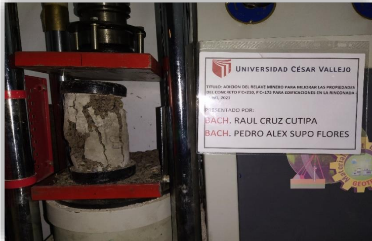
Fotografía 40. Proceso de rotura ensayo a compresión.
