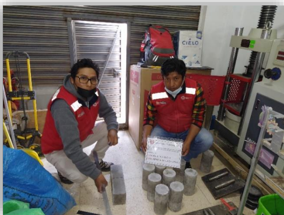
Fotografía 38-39. Proceso de recolección de datos peso y medidas de los testigos en laboratorio
