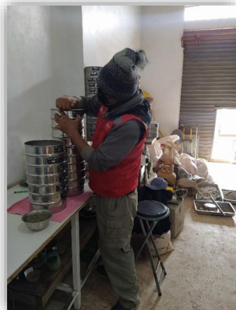
Fotografía 8. Tamizado del agregado grueso
