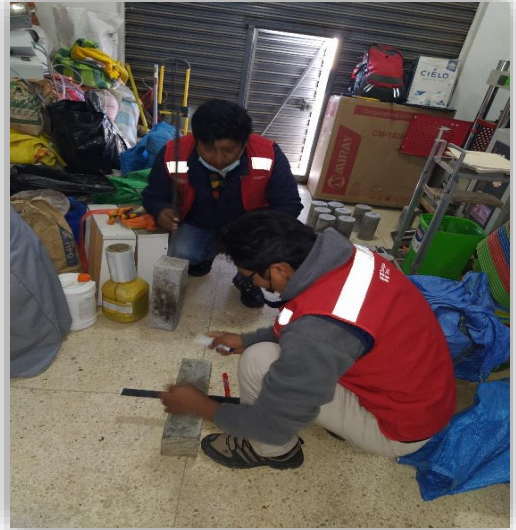
Fotografía 34-35. Briquetas para el ensayo a compresión en laboratorio edad de 28 días.
