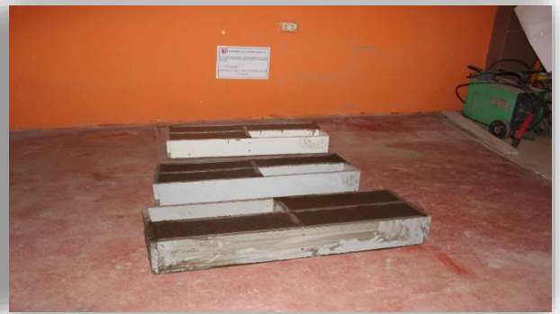
Fotografía 25-26. Vaciado de concreto F'c= 175 kg/cm 2 con adición de relave minero en moldes para compresión y flexión.
