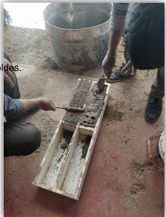
Fotografía 21. Vaciado moldes para flexión.
