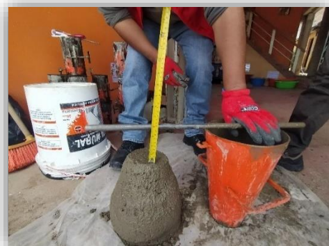
Figura 19. Diseño de mezclas y el slump (asentamiento) del concreto.
