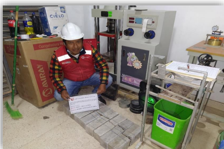
Fotografía 42. Resultados de las roturas de vigas ensayo a la flexión 28 días.
