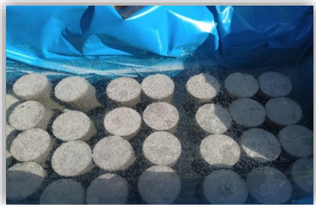
Fotografía 31-32. Proceso de curado 7, 14, 28 días de probetas cilíndricas.
