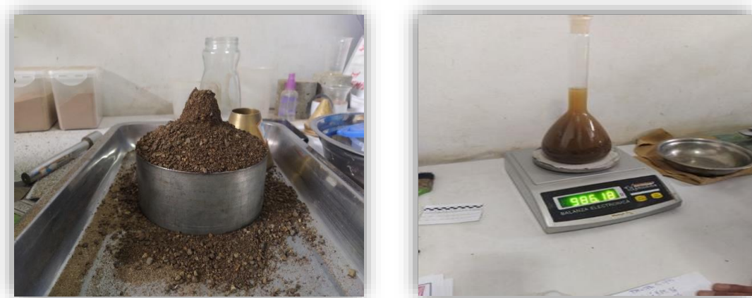
Figura 14. Ensayo de absorción y peso específico del agregado grueso.
