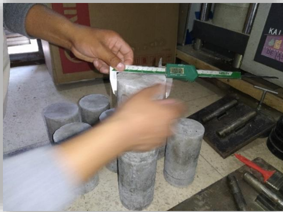
Fotografía 36-37. Proceso de recolección de datos de los testigos para el ensayo a compresión y flexión en laboratorio.
