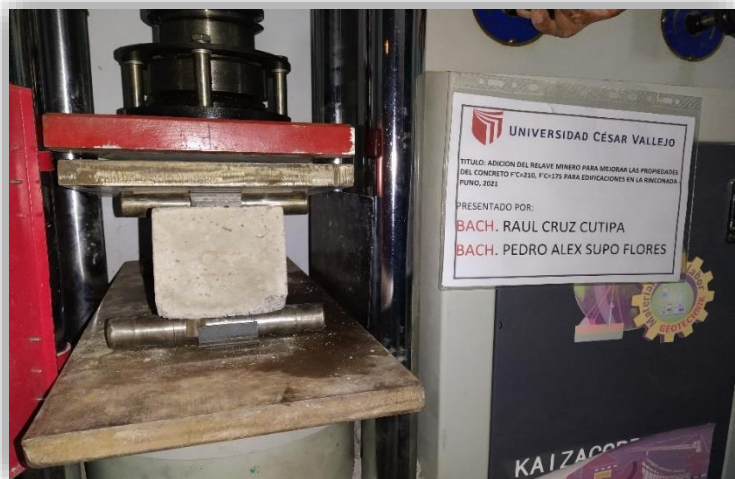
Fotografía 41. Proceso de rotura ensayo a flexión.
