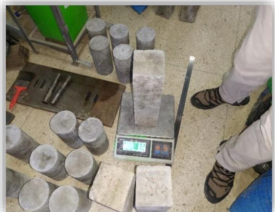
Fotografía 38-39. Proceso de recolección de datos peso y medidas de los testigos en laboratorio
