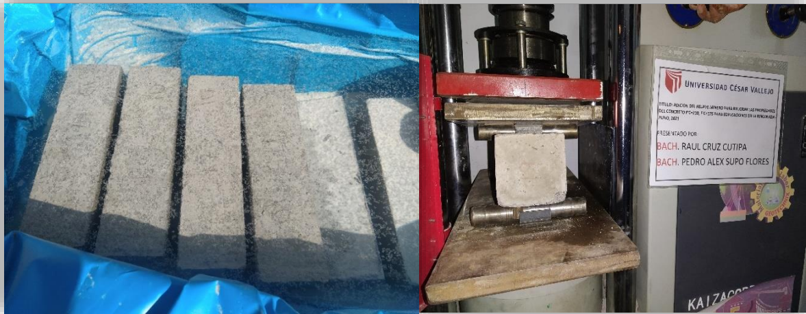
Figura 26. Vigas para el ensayo resistencia a flexión
