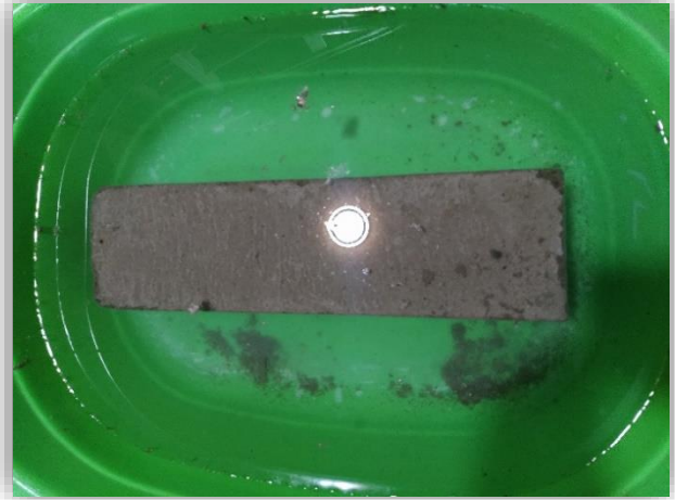
Fotografía 29-30. Curado de las probetas vigas ensayo a flexión.
