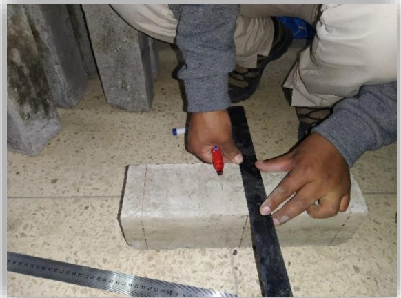
Fotografía 36-37. Proceso de recolección de datos de los testigos para el ensayo a compresión y flexión en laboratorio.
