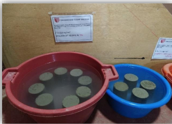
Fotografía 31-32. Proceso de curado 7, 14, 28 días de probetas cilíndricas.
