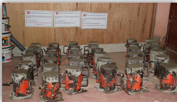
Fotografía 27-28. Moldes de probetas para el ensayo a compresión del concreto.
