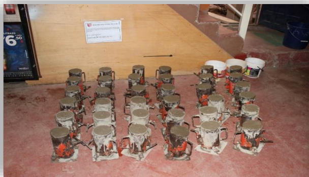
Fotografía 25-26. Vaciado de concreto F'c= 175 kg/cm 2 con adición de relave minero en moldes para compresión y flexión.
