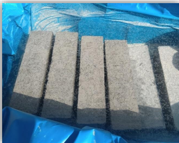
Fotografía 33. Proceso de curado 7, 14, 28 días de probetas vigas ensayo de flexión.
