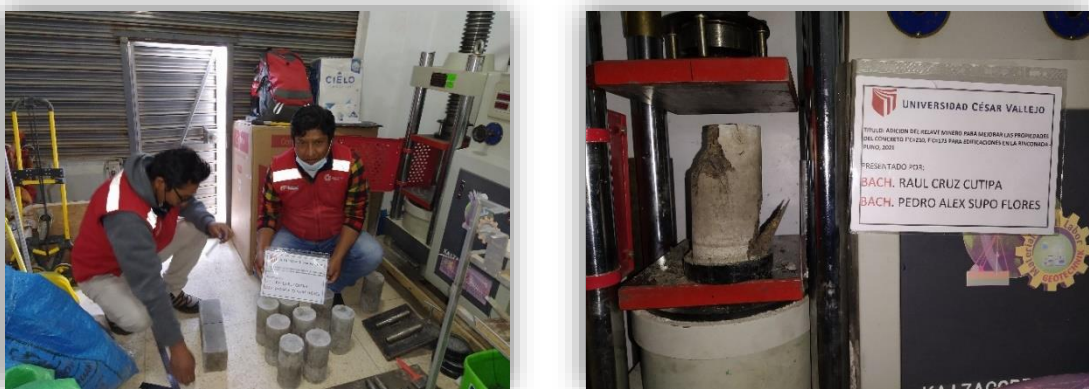
Figura 23. Ensayo a compresión de testigos cilíndricos con adición de relave minero
