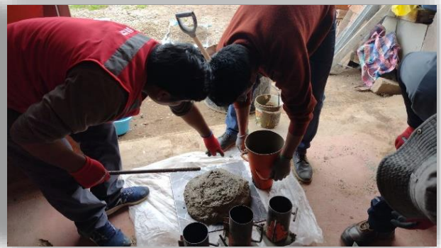
Fotografía 23-24. Selección del material para el diseño de mezclas F'c=175 kg/cm 2 .
