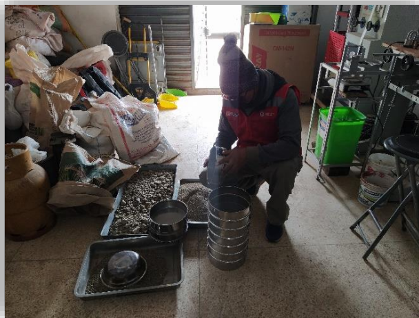
Fotografía 7. Tamizado del agregado fino.
