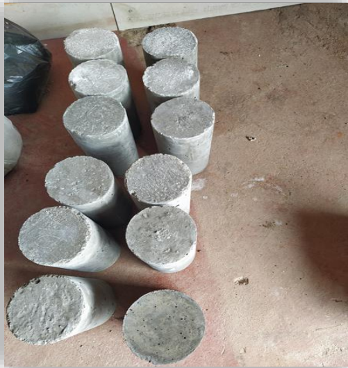
Fotografía 34-35. Briquetas para el ensayo a compresión en laboratorio edad de 28 días.
