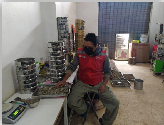
Fotografía 9 - 10. Separación de los agregados fino y grueso
