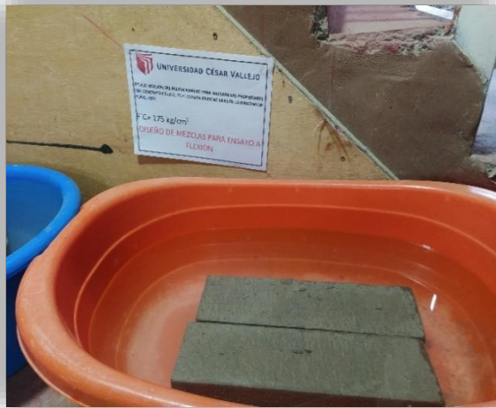
Fotografía 29-30. Curado de las probetas vigas ensayo a flexión.
