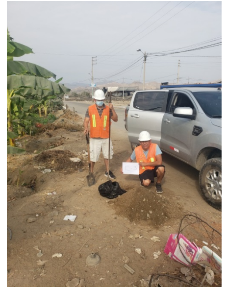
Foto 21. Excavación de la calicata N° 03 para la extracción de la muestra en Prlg. Av. Bombon Coronado
