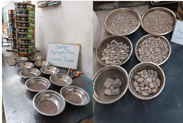
Figura 04. Ensayo granulométrico de los agregados finos y gruesos del yacimiento Yocará
