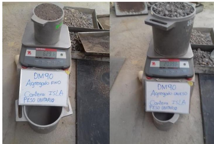
Figura 09. Ensayo peso unitario de los agregados finos y gruesos de la cantera Isla
