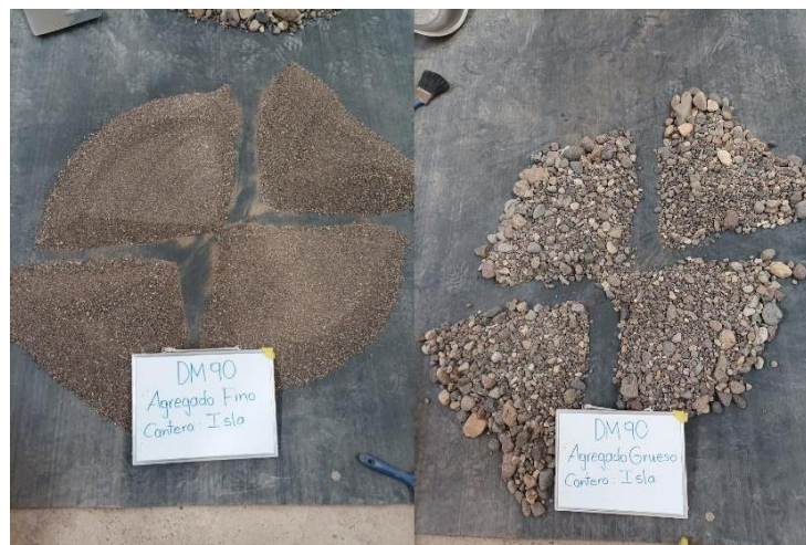
Figura 03. Cuarteo de agregado fino y grueso de la cantera Isla
