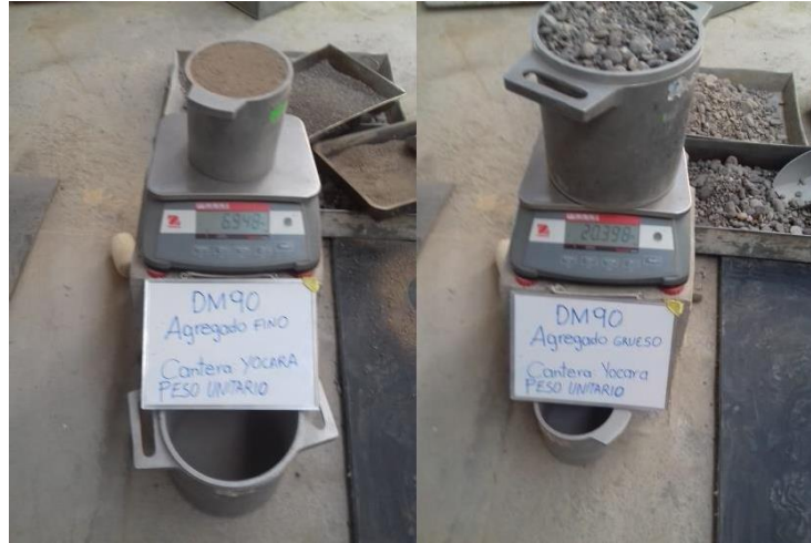
Figura 08. Ensayo de peso unitario de los agregados finos y gruesos de la cantera Yocará
