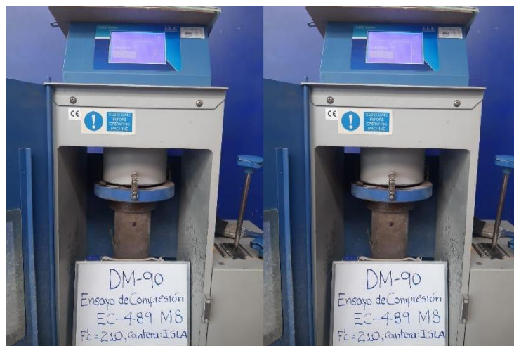
Figura 11. Ensayo a la resistencia a la compresión de las cateras Isla y Yocará a los 7 días de edad
