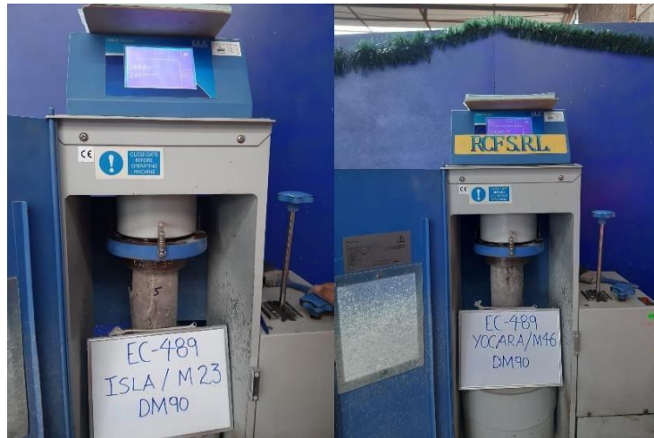
Figura 13. Ensayo a la resistencia a la compresión de las cateras Isla y Yocará a los 28 días de edad
