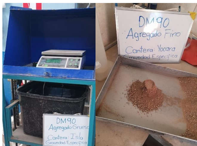
Figura 07. Ensayo de gravedad específica de los agregados finos y gruesos de la cantera Isla
