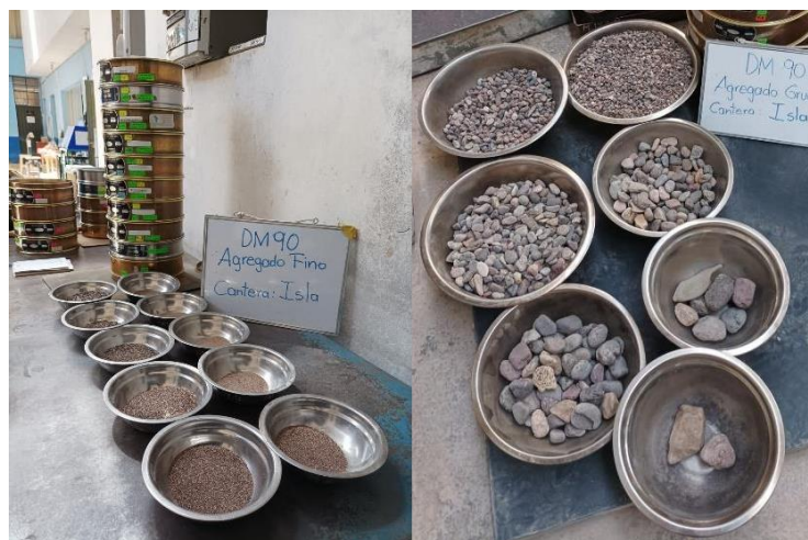
Figura 05. Ensayo granulométrico de los agregados finos y gruesos de la cantera Isla
