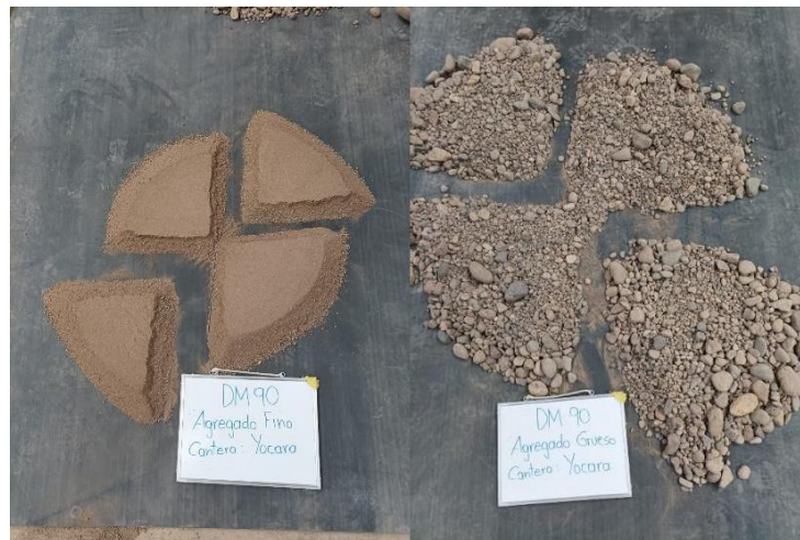
Figura 02. Cuarteo de los agregados de la cantera Yocará
