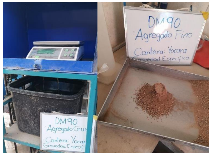
Figura 06. Ensayo de gravedad específica de los agregados finos y gruesos de la cantera Yocará
