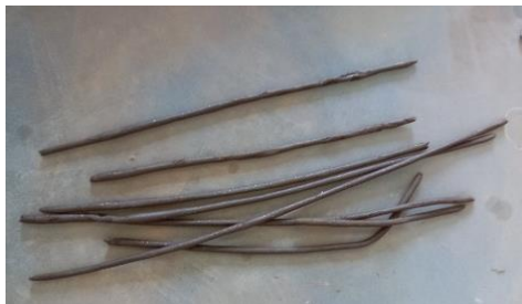
Figura 31: Rollitos de 3mm límite plástico
