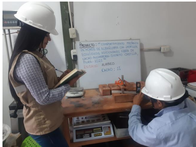
Figura 42: Alabeo de ladrillo con adición de fibra cacao 1%
