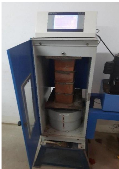
Figura 14: Compresión axial en pilas
