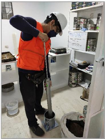
Ensayo Proctor Modificado C-1 + 10.5% Cloruro de Sodio
