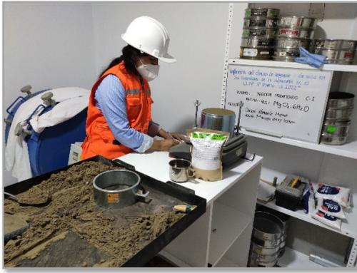
Ensayo Proctor Modificado C-1 + 10.5% Cloruro de Magnesio
