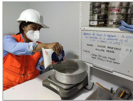
Preparacion del Cloruro de Sodio para su adicion a la muestra de suelo.
