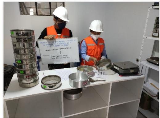
**Figura 14.** Ensayo granulométrico Calicata N°3 malla N°6
