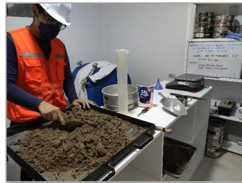
Ensayo Proctor C-1 + 8.5% Cloruro de Sodio
