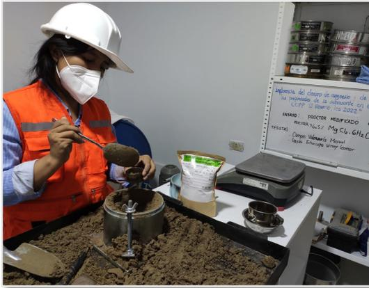
**Figura 17.** Extracción de muestra para cálculo de contenido de humedad
