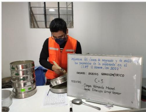
**Figura 13.** Ensayo granulométrico Calicata N°3 malla N°30
