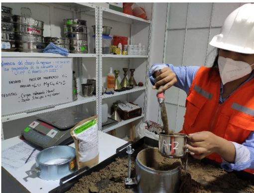
Ensayo Contenido de Humedad. Cloruro de Magnesio
