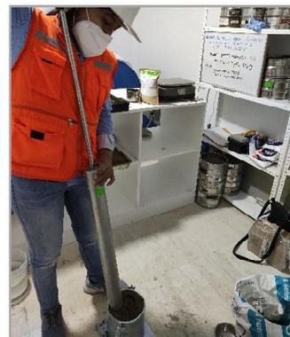
Ensayo Proctor C-1 + 6.5% Cloruro de Magnesio
