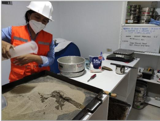
Ensayo Proctor Modificado C-1 + 6.5% Cloruro de Sodio
