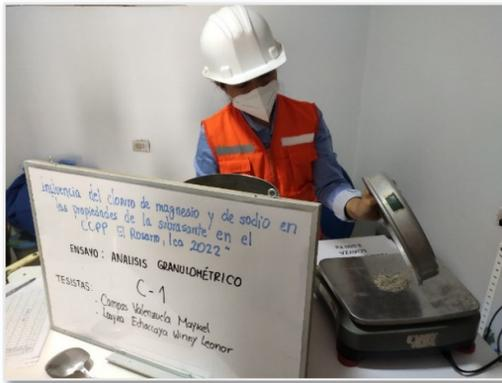
**Figura 11.** Ensayo granulométrico Calicata N°1
