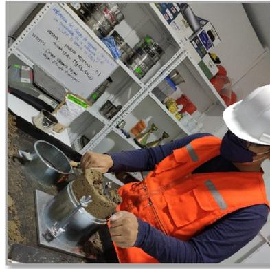
Ensayo Proctor Modificado C-1 + 8.5% Cloruro de Magnesio
