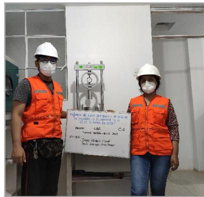
Ensayo CBR C-1 + 10.5% Cloruro de Sodio
