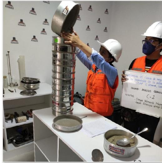
**Figura 12.** Ensayo granulométrico Calicata N°2
