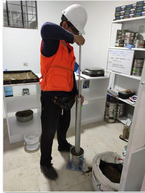
**Figura 21.** Compactación con pistón del espécimen muestra patrón + 8.5% NaCl
