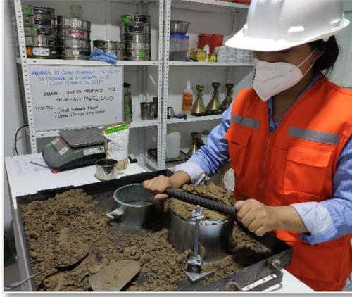
**Figura 20.** Enrazado del espécimen muestra patrón + 6.5% MgCl<sub>2</sub>·6H<sub>2</sub>O
