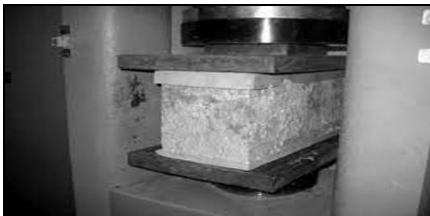
Figura 16. Ensayo de resistencia a la compresión.
