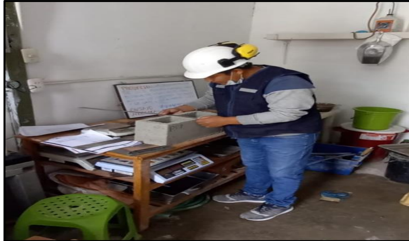
Figura 39. Ensayo de Variación dimensional al bloque de concreto.
