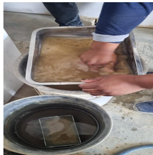
Ensayo de Granulometría de los agregados para su determinación por tamaño de los granos y ver los porcentajes retenidos en los tamices.
