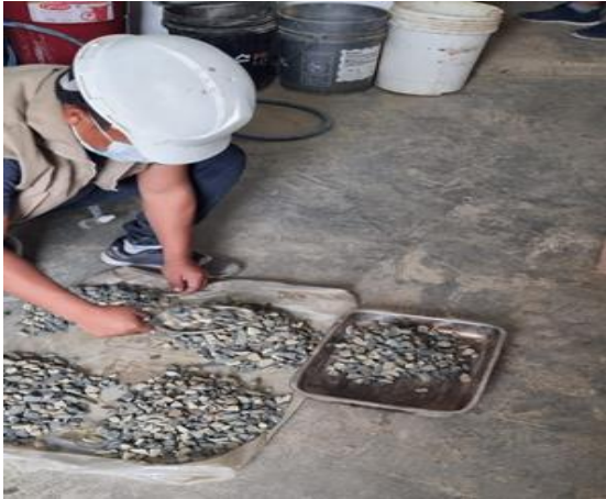
Estudio de suelos (cuarteo) de los agregados para la optencion de muestras mas pequeñas y representativas.
