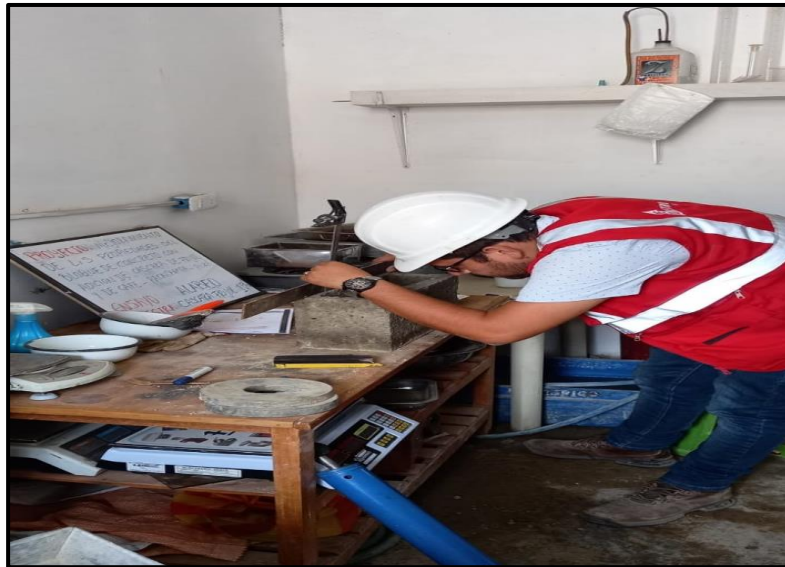
Figura 41. Ensayo de alabeo al bloque de concreto.
