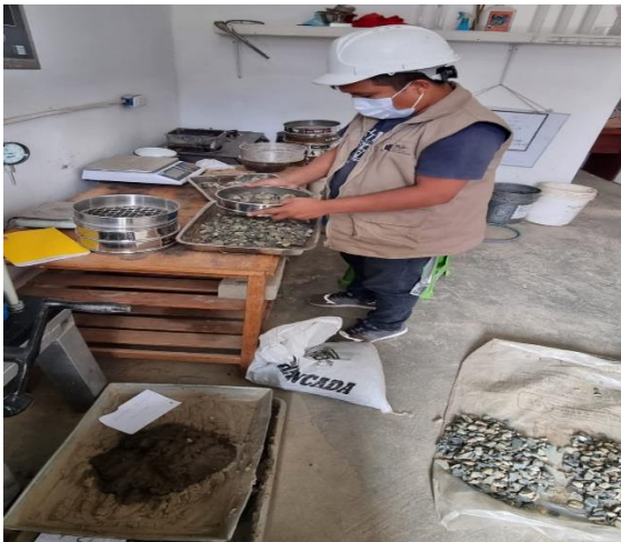
Ensayo de Granulometría de los agregados para su determinación por tamaño de los granos y ver los porcentajes retenidos en los tamices.
