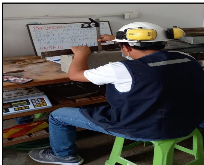
Figura 43. Ensayo de Alabeo al bloque de concreto.
