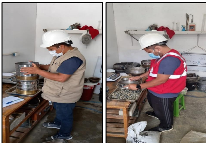
Figura 32. Tamizado de los agregados.
