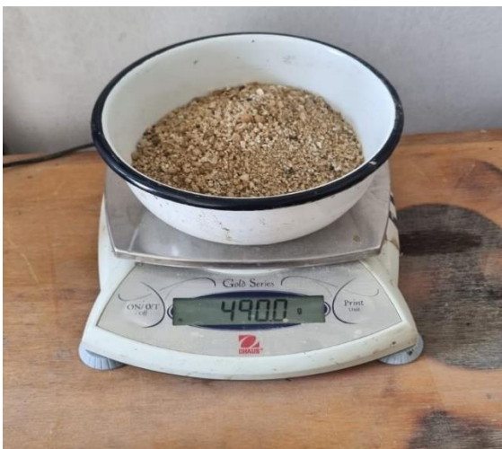
Ensayo de Granulometría de los agregados para su determinación por tamaño de los granos y ver los porcentajes retenidos en los tamices.
