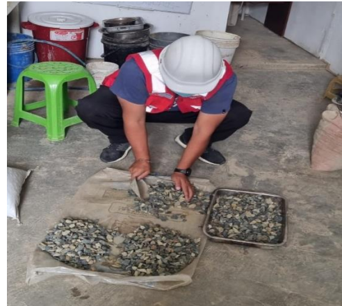
Estudio de suelos (cuarteo) de los agregados para la optencion de muestras mas pequeñas y representativas.
