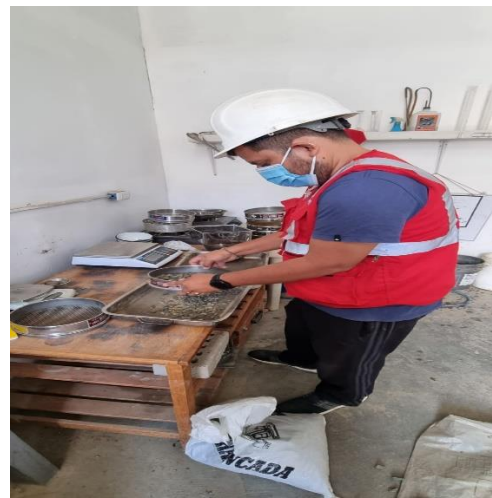
Ensayo de Granulometría de los agregados para su determinación por tamaño de los granos y ver los porcentajes retenidos en los tamices.
