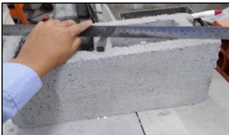
Figura 15. Ensayo alabeo (determinación concavidad y convexidad)
