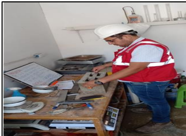
Figura 36. Ensayo de Variación dimensional al bloque de concreto.
