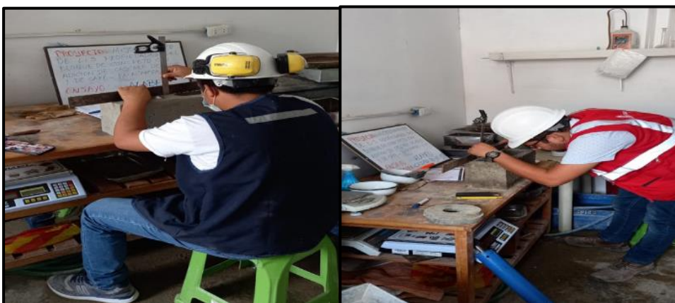
Figura 14. Ensayo de variación dimensional del bloque de concreto.
