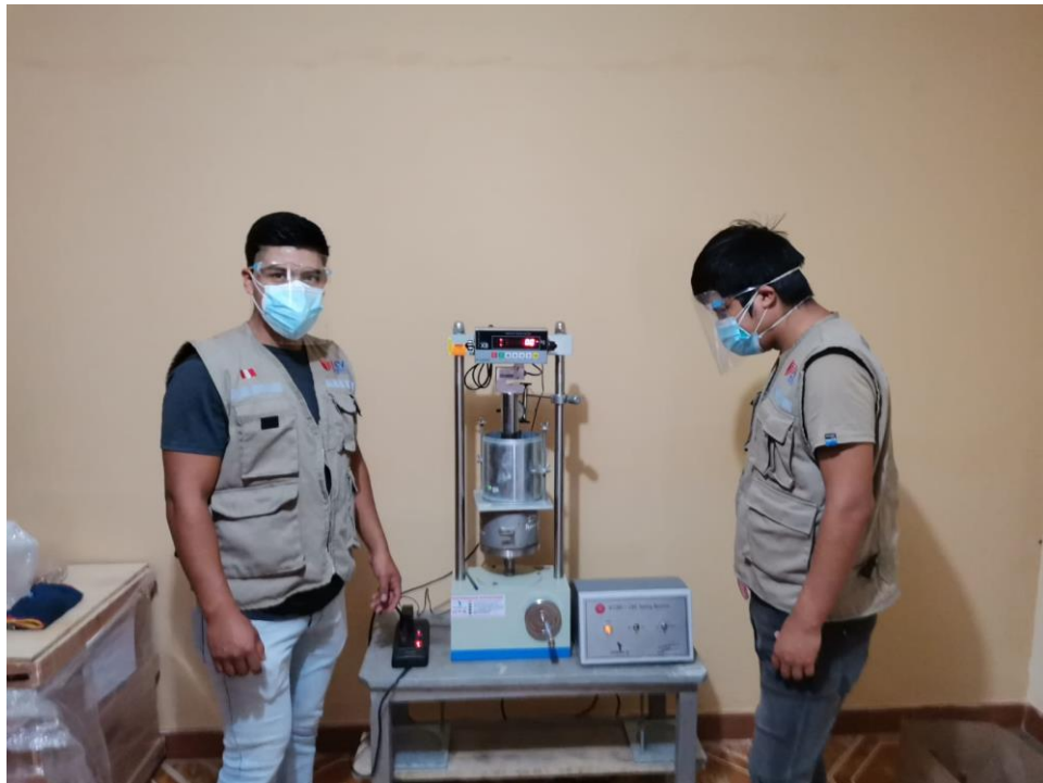
Fotografía N° 15 Realizando el ensayo de California Bearing Ratio
