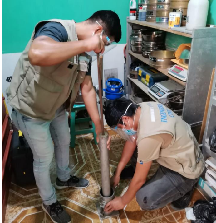
Fotografía N° 15 Realizando en ensayo de Proctor Modificado Método A.
