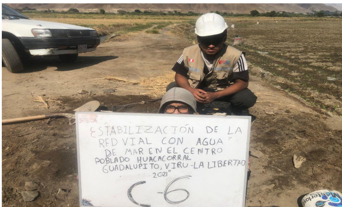
Fotografía N° 08. Finalizando la calicata N° 06 para la obtención de muestras del Centro Poblado Huacacorrall.
