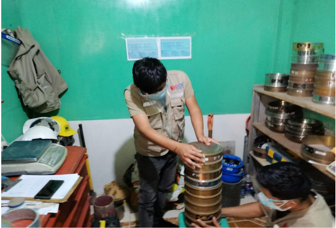
Fotografía N° 11 Realizando el análisis de granulométrico.
