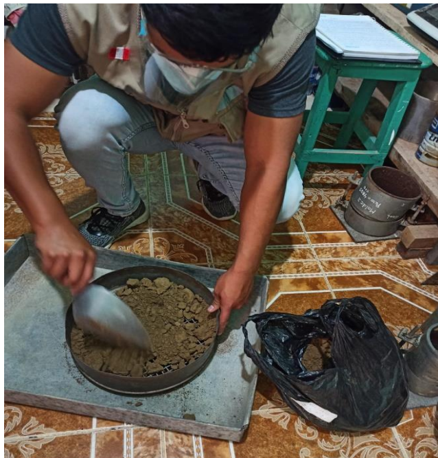
Fotografía N° 14 Realizando el análisis según el tamaño de partícula predominante para poder saber si es método A – B - C de acuerdo a eso se escoge el tamaño de molde — 4 pulgadas si es método A - B y 6 pulgadas si es método C
