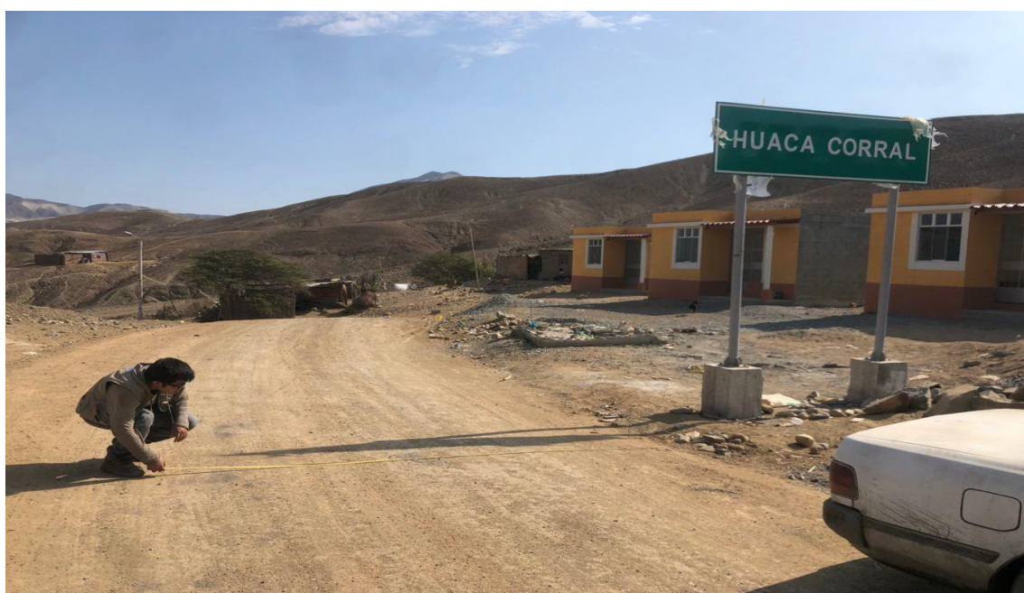
Fotografía N° 02. Realizando la respectiva medida del ancho de las calles de la entrada al Centro Poblado Huacacorral que está constituido por 4.50 metros de ancho.
