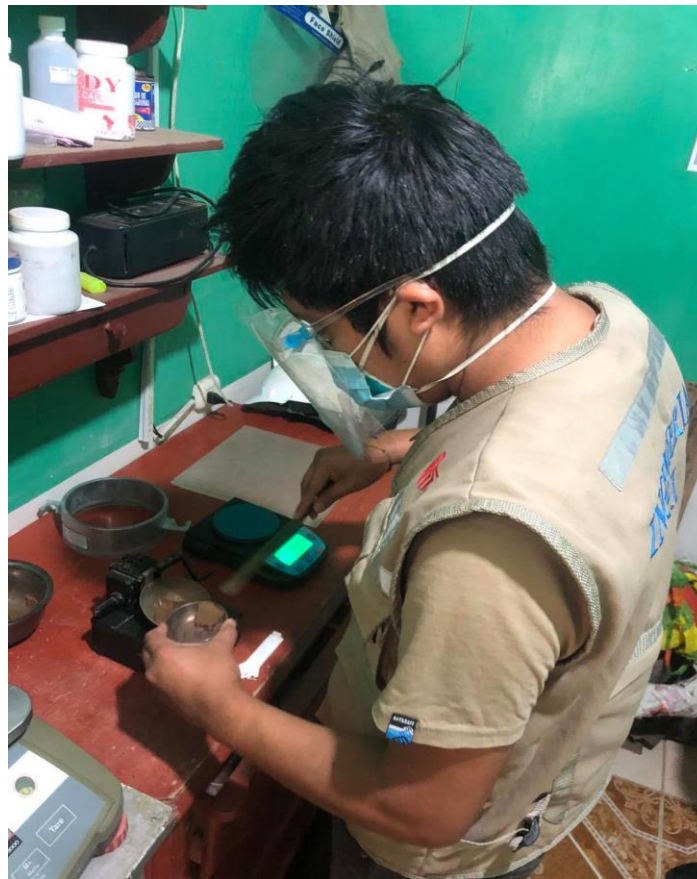
Fotografía N° 12 Realizando el análisis de limite líquido.
