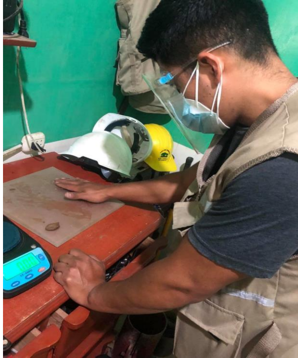
Fotografía N° 13 Realizando el análisis de limite plástico.
