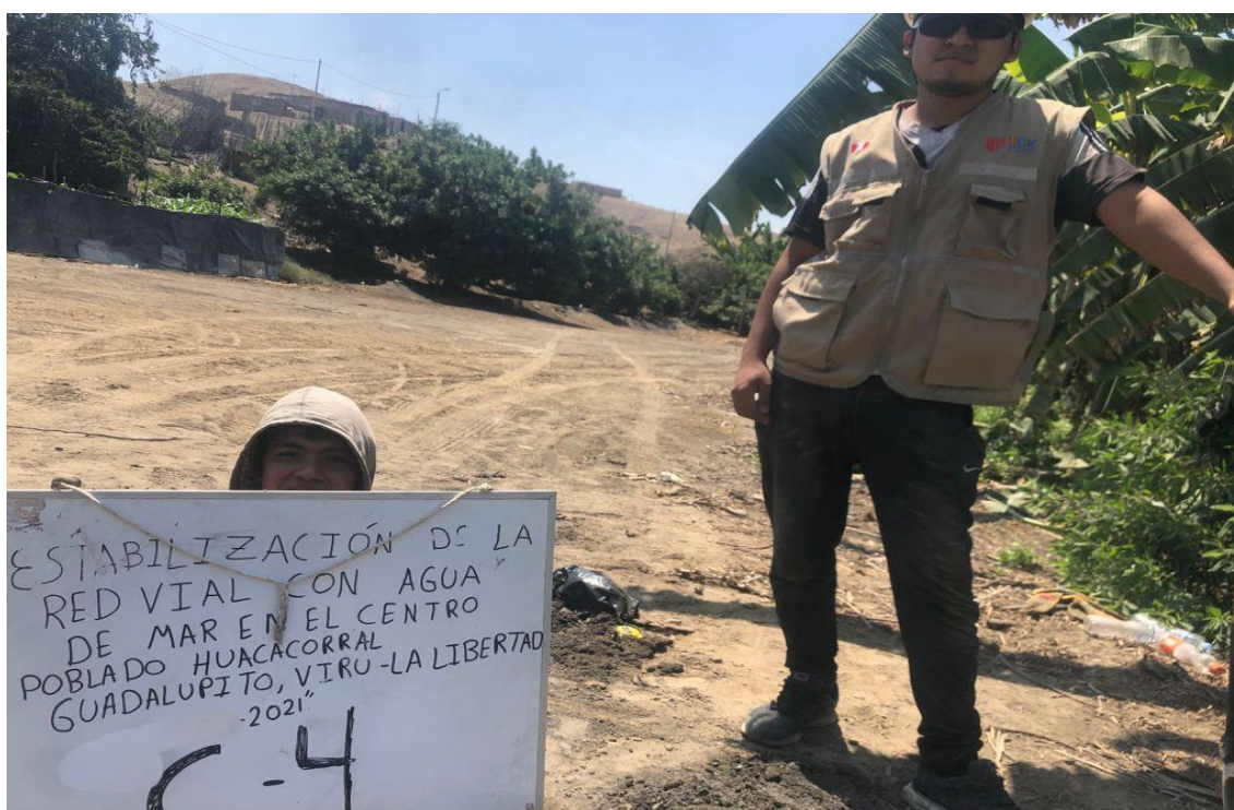
Fotografía N° 06. Finalizando la calicata N° 04 para la obtención de muestras del Centro Poblado Huacacorral.
