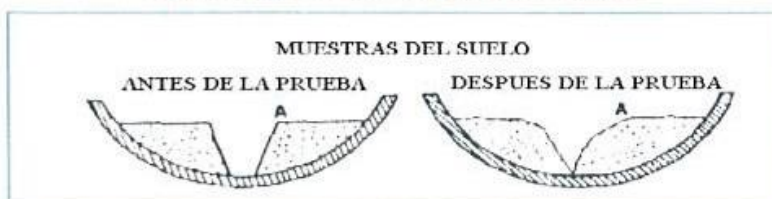
Figura 1: Aparato manual para límite líquido
