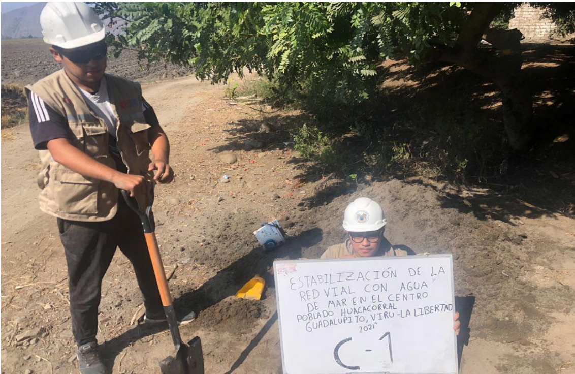
Fotografía N° 03. Finalizando la calicata N°01 para la obtención de muestras del Centro Poblado Huacacorrall.
