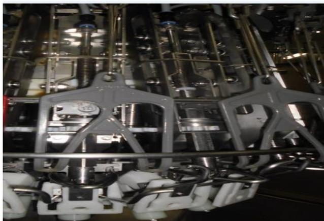
Figura N° 22: Maquina automática de corte de cloaca.
