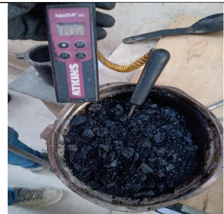
Fotografía 4. Control de la temperatura de la mezcla asfáltica.
