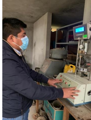
Fotografía 16. Ensayo de las briquetas con asfalto modificado.
