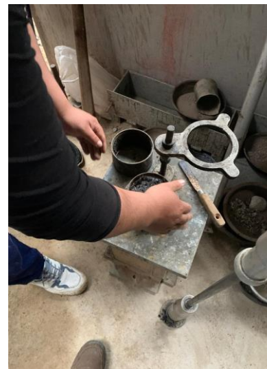
Figura 25. Compactación de las briquetas de asfalto modificado.
