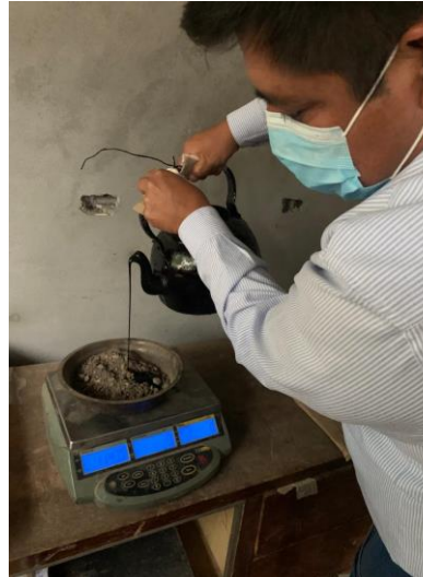
Figura 12. Adición de la mezcla asfáltica.
