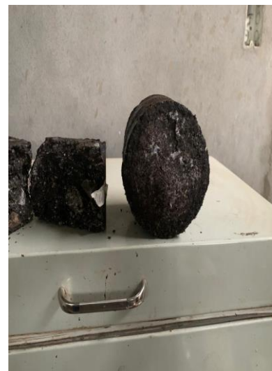
Figura 30. Briquetas roturadas después del ensayo Marshall.
