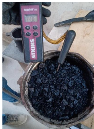
Figura 31. Control de la temperatura del asfalto modificado.
