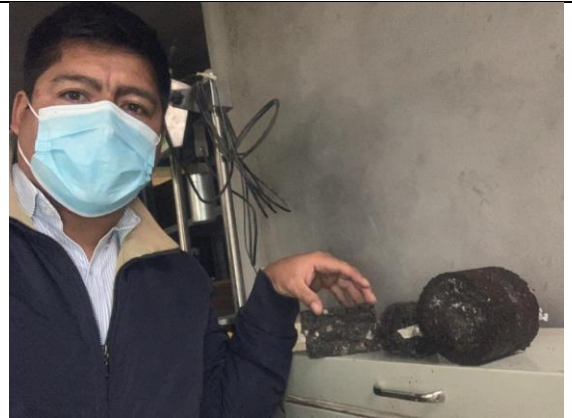
Fotografía 20. Vista de las briquetas de asfalto modificado después del ensayo Marshall.
