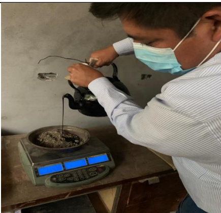
Fotografía 3. Adición del cemento asfáltico.
