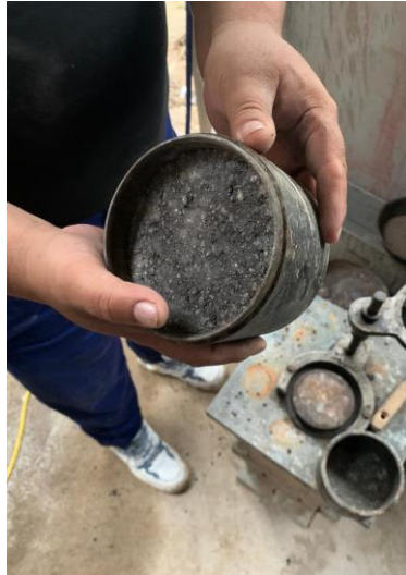
Figura 26. Extracción de las briquetas del molde.
