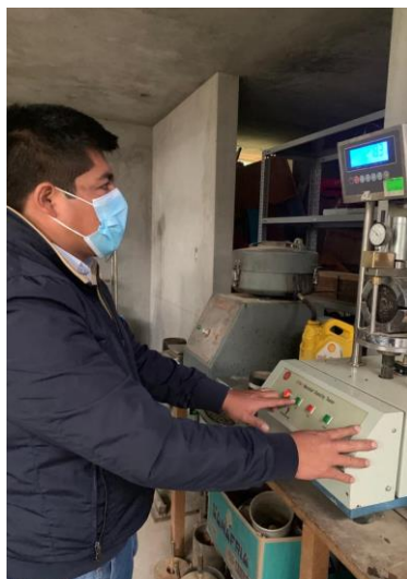
Figura 29. Ejecución del ensayo Marshall de la mezcla asfáltica modificada.
