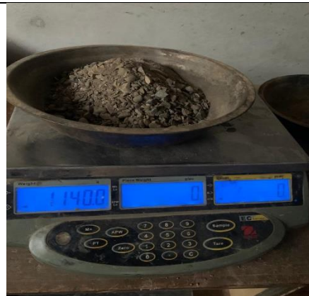
Fotografía 2. Pesaje de los agregados de la mezcla asfáltica.
