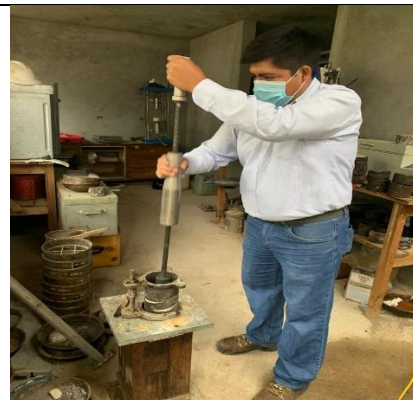
Fotografía 6. Compactación de las mezclas asfálticas.
