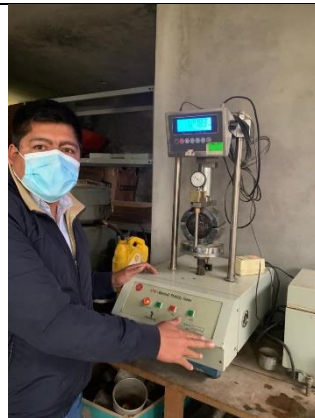
Fotografía 18. Control del ensayo de Marshall a las briquetas.
