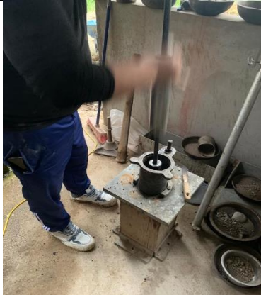
Fotografía 7. Compactación de las muestras de asfalto modificado.
