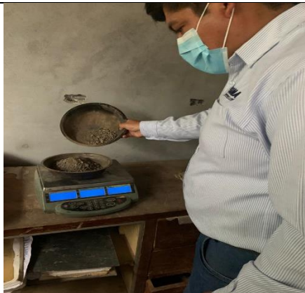
Fotografía 1. Preparación de la mezcla asfáltica.
