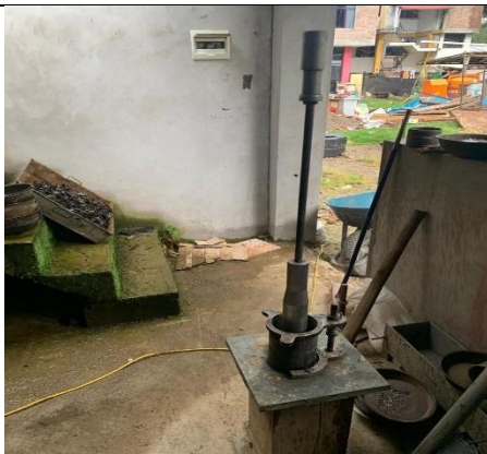
Fotografía 5. Vista de los instrumentos de compactación.
