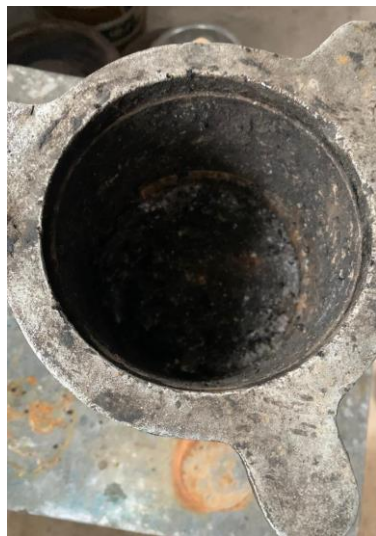
Figura 24. Vista del molde para la elaboración de briquetas.
