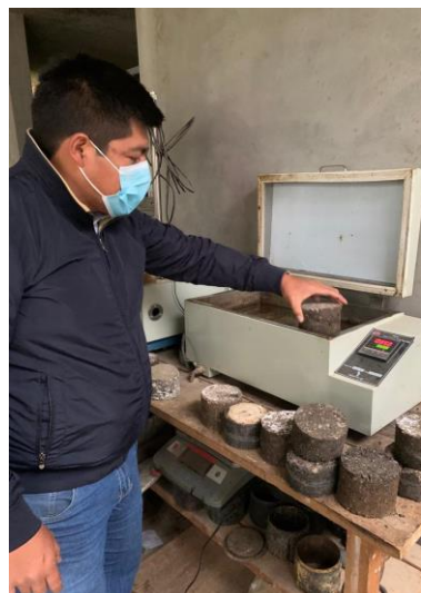
Figura 15. Adición de la mezcla asfáltica.
