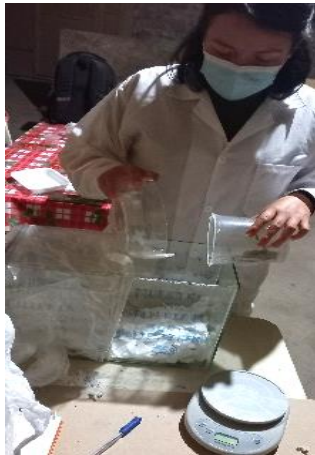
Visualización de colocación del poliestireno y Galleria mellonella en la Prueba de 16 horas.
