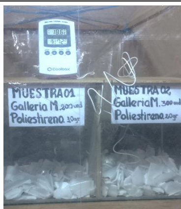
Toma de temperatura y humedad relativa de la Pre prueba 8 horas.
