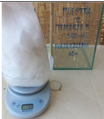
Pesaje de Polietileno para su posterior disposición al contenedor para la prueba de 32 horas.
