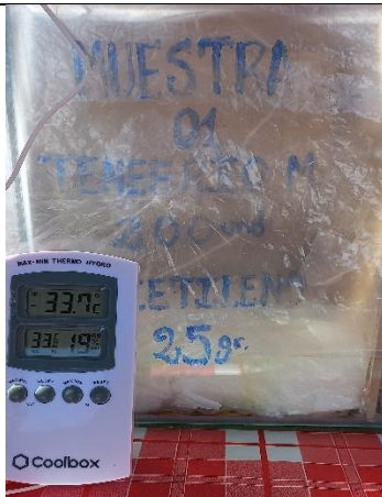
Toma de Temperatura ( ^{\circ}\text{C} ) y Humedad Relativa % para la prueba de 16 horas.
