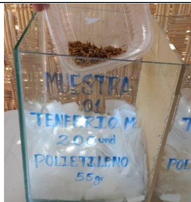
Colocación de Tenebrio molitor al contenedor con 55 gr. de polietileno en la prueba de 32 horas.
