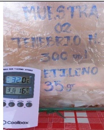
Toma de Temperatura ( ^{\circ}\text{C} ) y Humedad Relativa % para la prueba de 16 horas.
