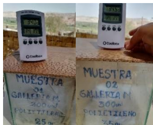
Visualizacionn de la toma de temperaturas de ingreso del polietileno en la prueba de 16 horas.
