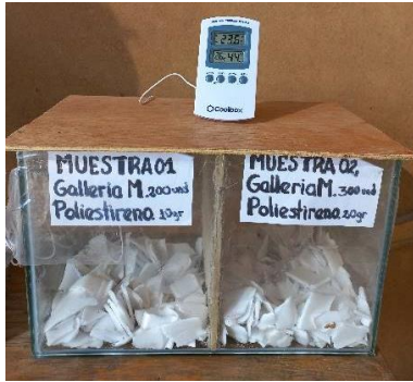
Toma de la temperatura final de la Pre prueba 8 horas de Galleria mellonella - poliestireno.
