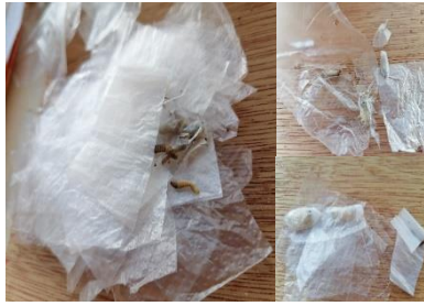
Visualización del consumo del polietileno por la Galleria mellonella en la prueba de 16 horas.
