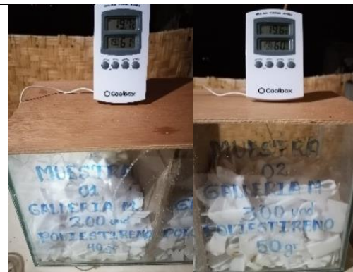
Toma de temperatura y humedad relativa del poliestireno en la prueba de 24 horas.
