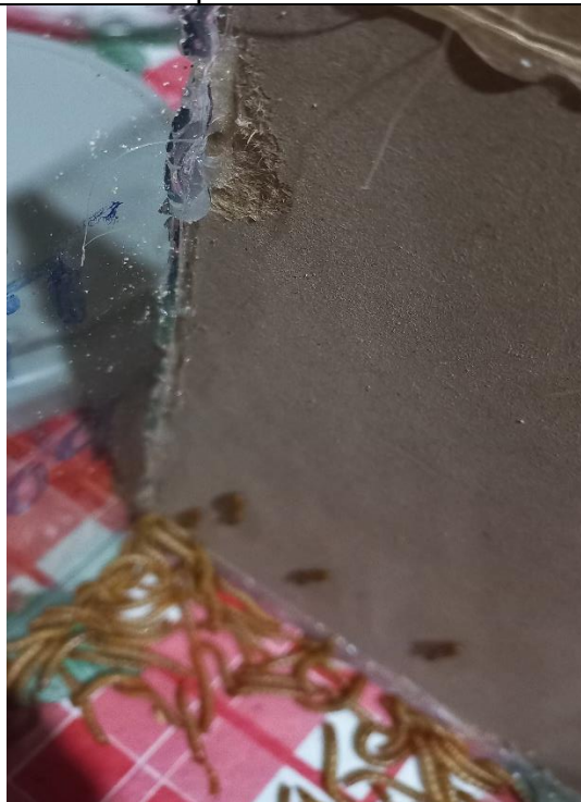
Se observa evidencia de consumo de madera tipo MDF por la especie Tenebrio molitor .
