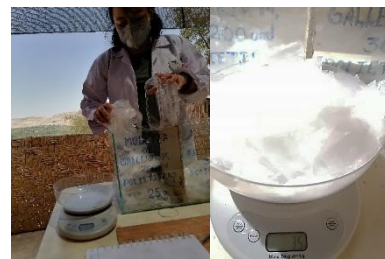
Visualizacion de la colocacion del polietileno para la prueba de 16 horas.
