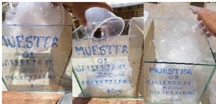
Visualización de la colocación del polietileno y la Galleria mellonella en los contenedores de vidrio para la Pre prueba de 8 horas.
