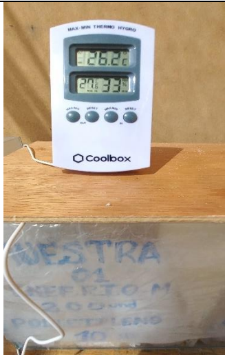
Toma de Temperatura ( ^{\circ}\text{C} ) y Humedad Relativa % para la prueba de 8 horas.
