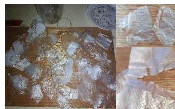
Visualización del consumo de polietileno por Galleria mellonella en la prueba de 32 horas.
