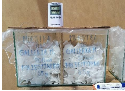
Visualización de la toma de temperatura y humedad relativa de ingreso del poliestireno para la prueba de 32 horas.
