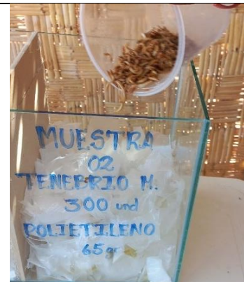
Colocación de Tenebrio molitor al contenedor con 65 gr. de polietileno en la prueba de 32 horas.
