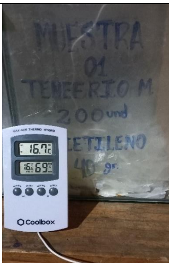
Toma de Temperatura ( ^{\circ}\text{C} ) y Humedad Relativa (%) para la prueba de 24 horas.
