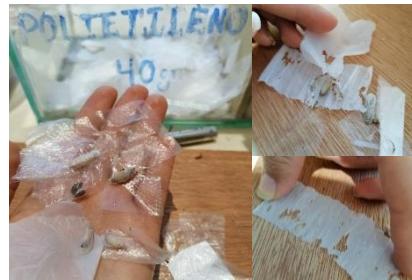
Visualización del consumo de polietileno por la Galleria mellonella en la prueba de 24 horas.
