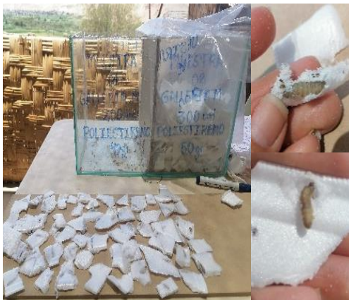
Visualización del consumo del poliestireno por Galleria mellonella en la prueba de 24 Horas.
