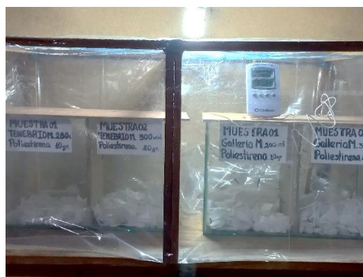
Visualización de la toma de temperaturas con el termohigrómetro.
