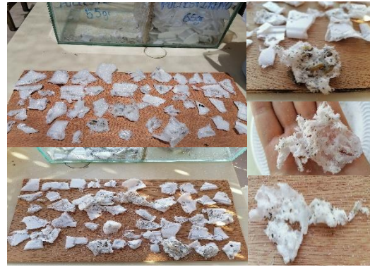
Visualización del consumo de poliestireno por la Galleria mellonella en la prueba de 32 horas.
