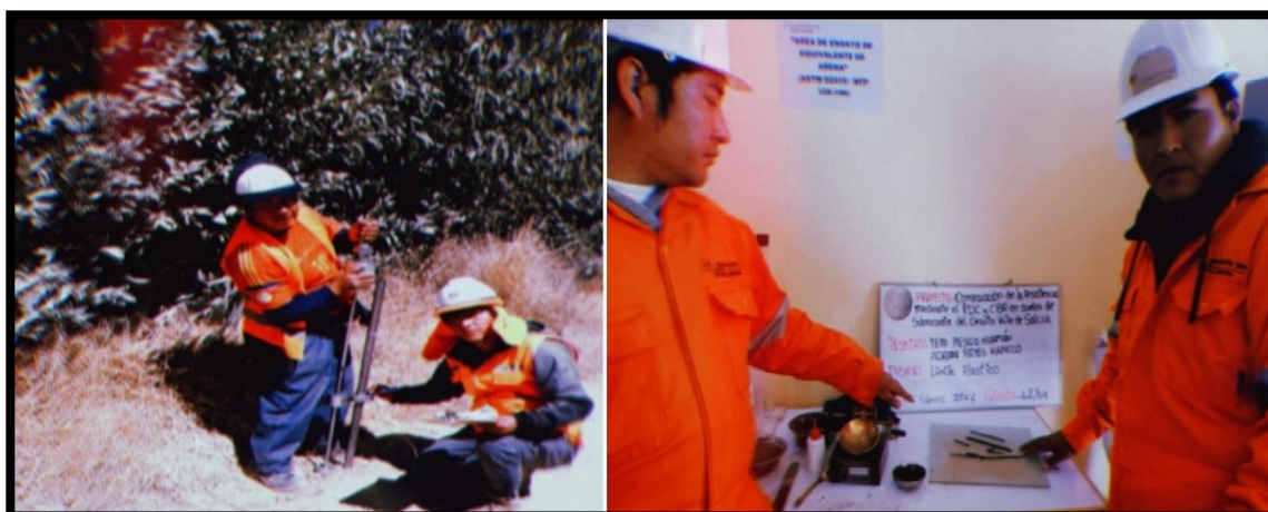
Figura 22. Ensayo de PDC in situ y ensayo de LL, LP
