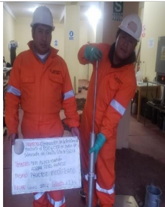
Ensayo Proctor modificado
