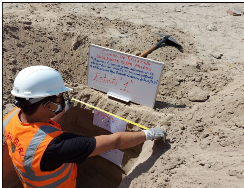
Figura 11. Medición de calicata.
