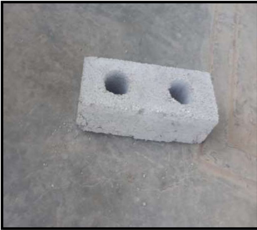
FOTOGRAFÍA 16. Muestra luego del ensayo de resistencia a la compresión.
