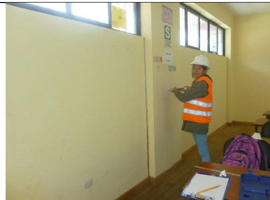
Figura. .Ensayos de esclerometría en el punto C-4
