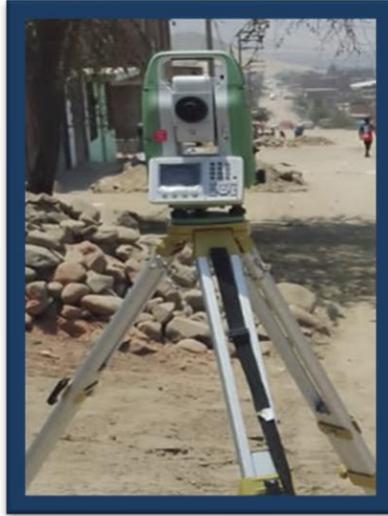
**FIGURA 2.** Estación Total Leica TS07
