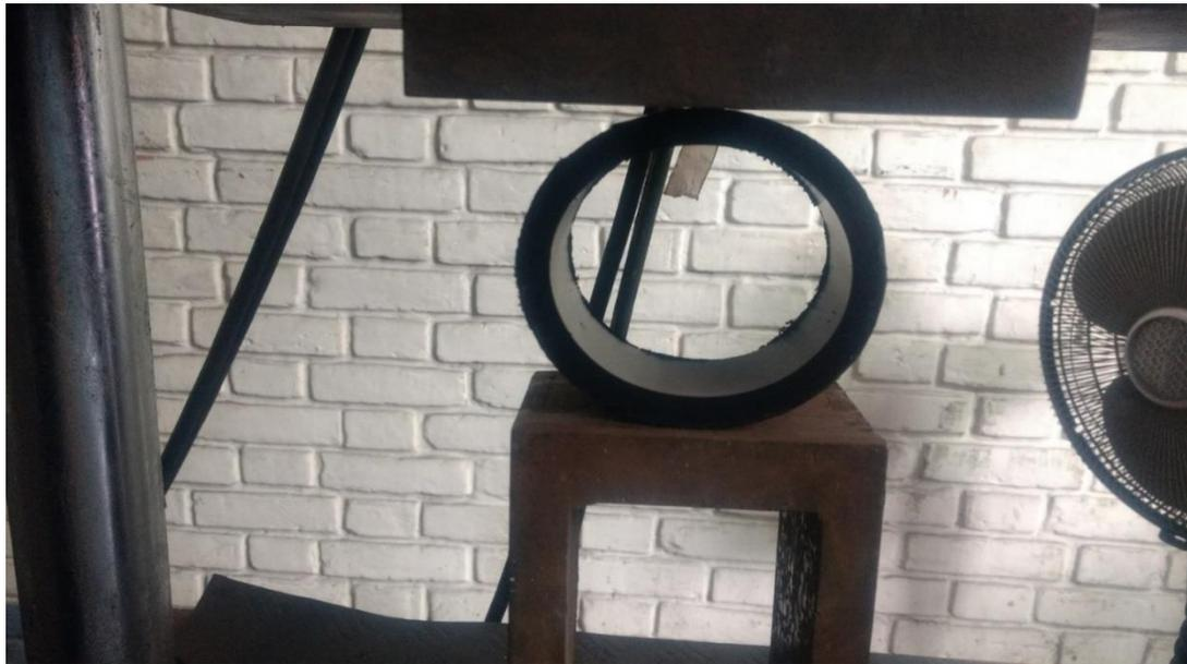
**ANEXO 19.** Deformación de la tubería de polietileno de alta densidad, según el ensayo de aplastamiento
