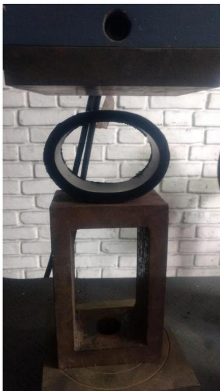
**ANEXO 18.** La carga se aplicó de forma uniforme y centrada sobre la parte recta del exterior del tubería de polietileno de alta densidad
