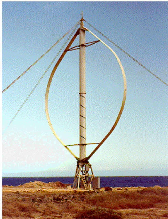
Fig.Nº9: Aerogenerador de eje vertical
