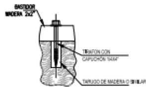
DETALLE 004: TIRAFON DE ANCLAJE
