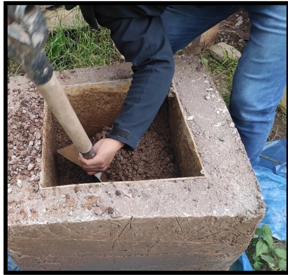
Figura 24, desencofrado de moldes de concreto con caucho reciclado.
