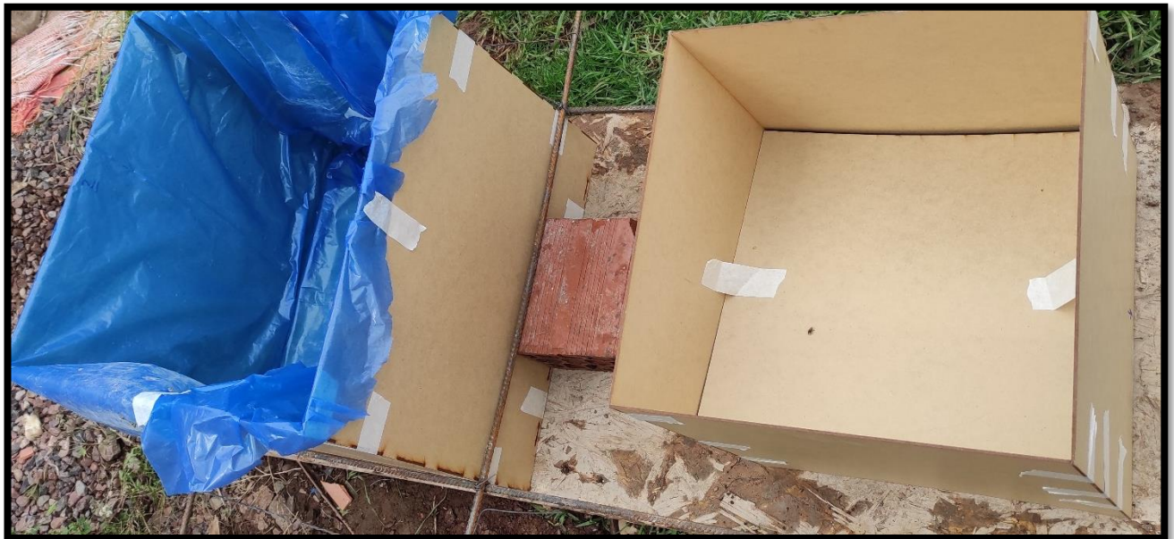
FOTOGRAFIA 4: moldes de placas en forma de cubo listos para ser vaciados
