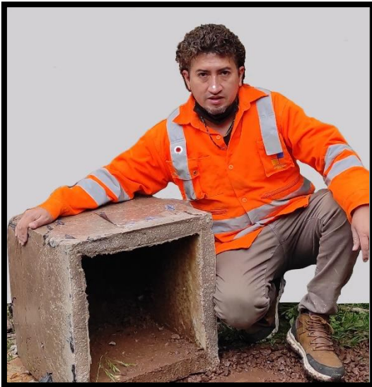
Figura 24, desencofrado de moldes de concreto con caucho reciclado.
