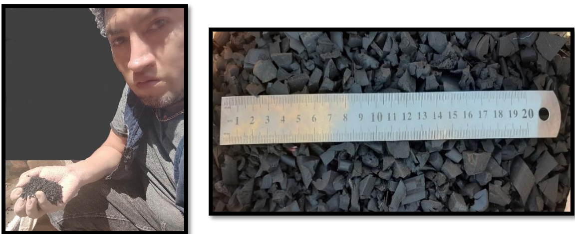
figura 18. Se observan dos figuras, la primera nos muestra el caucho fino obtenido, y en la segunda figura el caucho molido artesanalmente.
