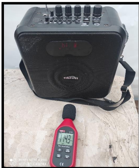
Figura 25. Sonido patrón de 400 a 600 Hz, y con 114.3 dB de sonido sin barrera de concreto.
