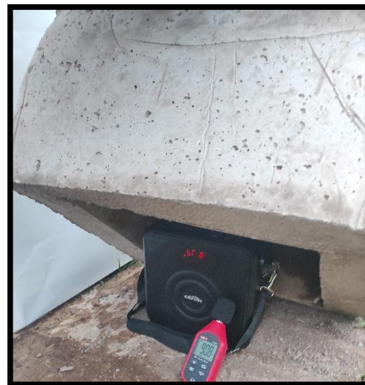
Figura 25. Sonido patrón de 400 a 600 Hz, y con 114.3 dB de sonido sin barrera de concreto.
