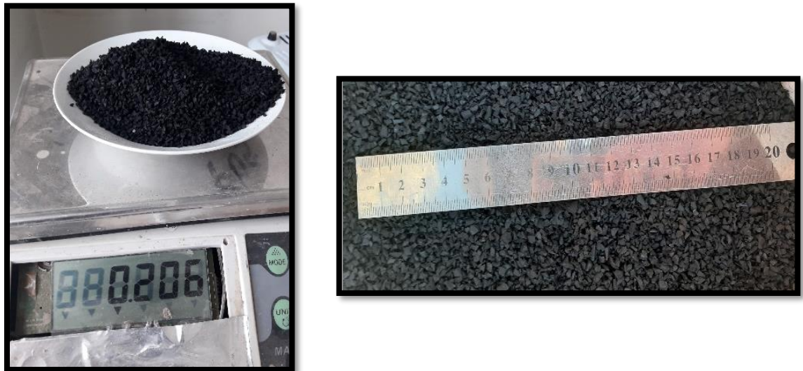
Figura 19, Pesaje del caucho y la medición del caucho fino
