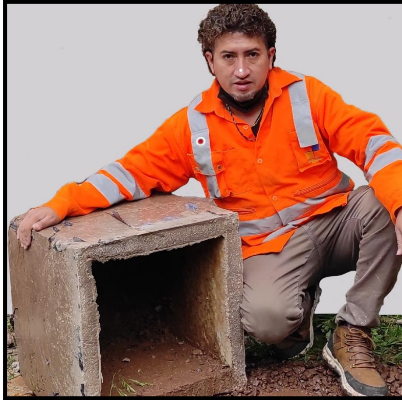
FOTOGRAFIA 7: desencofrado de los moldes tras 28 días de fragua
