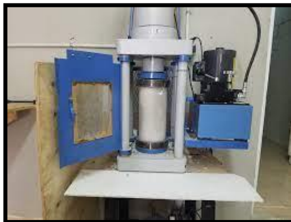
Figura 16, ensayo a la compresión, sometido a los 28 días.
