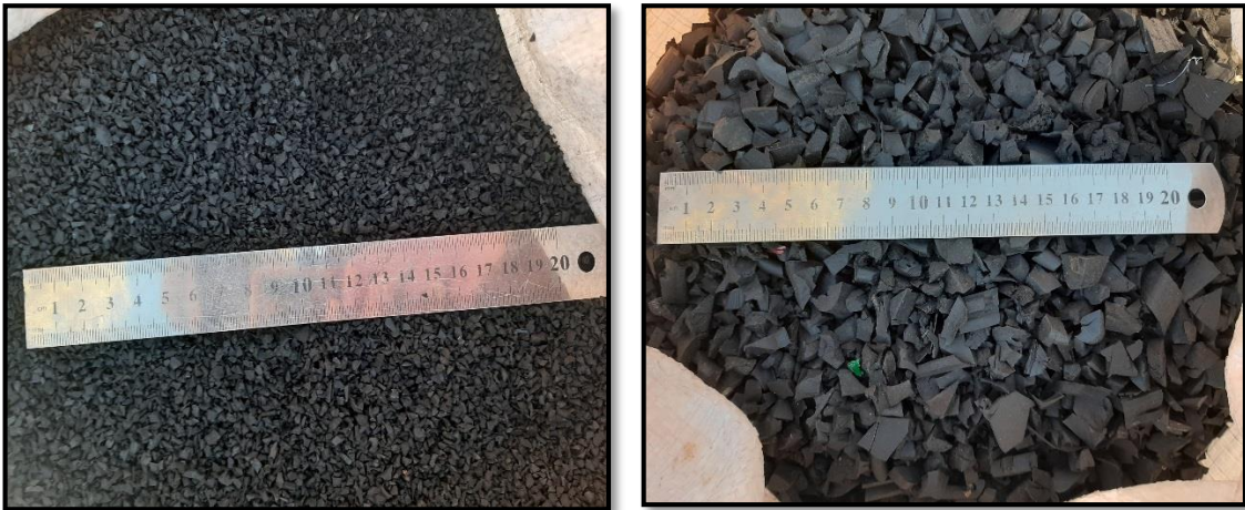
Figura 4. Partículas de caucho reciclado después de los procesos de trituración mecánica.
