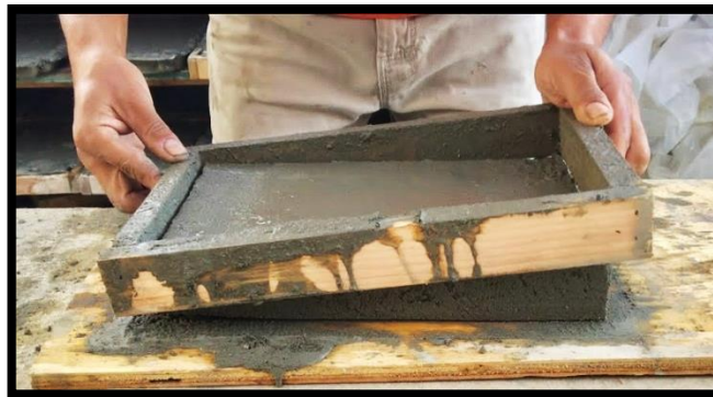
Figura .10 Colocación de la mezcla en los moldes
