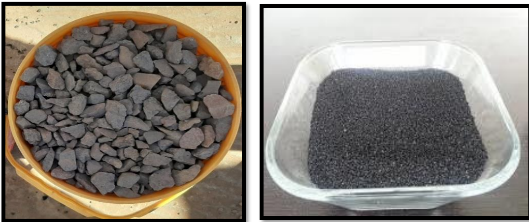
Figura 8. se observa piedra chancada y caucho molido
