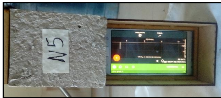
Figura 13. Prototipo para el ensayo de sonido con concreto y caucho
