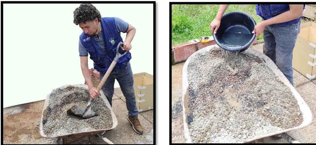
Figura 22. Mezcla manual según los resultados obtenidos del cálculo del volumen y peso del caucho y el diseño de mezcla obtenido
