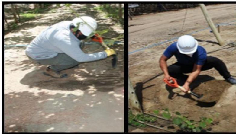
**Figura 17. Limpieza de los puntos de muestreo y extracción de muestras**
