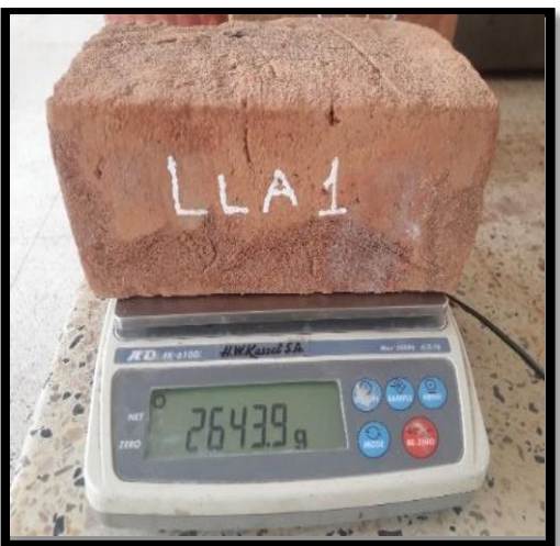
Pesado de ladrillo seco, de la ladrillera Los Aquijes.
