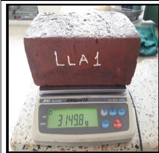
Pesado de ladrillo húmedo, de la ladrillera Los Aquijes.
