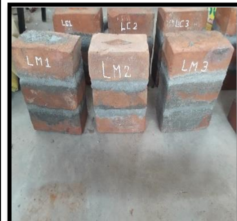
Se realizó el ensayo de Compresión en pilas de las 05 ladrilleras en el laboratorio.
