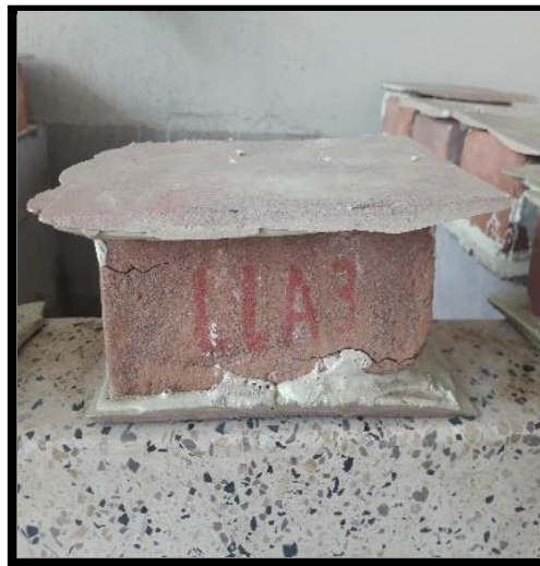
superior e inferior, antes del ensayo a la Compresión.
