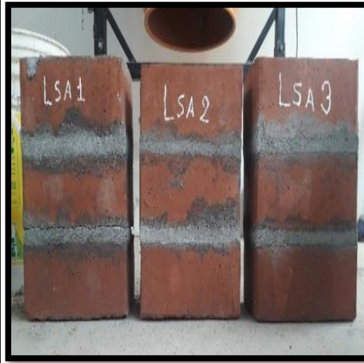
Ensayo de Compresión en pilas de la ladrillera Santa Angelica.
