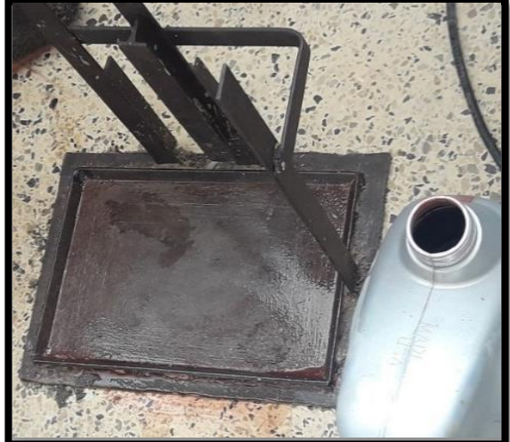
Vaceado del camping a un molde para luego asentar el ladrillo y tener una superficie uniforme.
