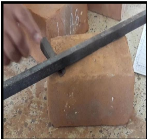
Medición de la altura del ladrillo, para el ensayo de variación dimensional.
