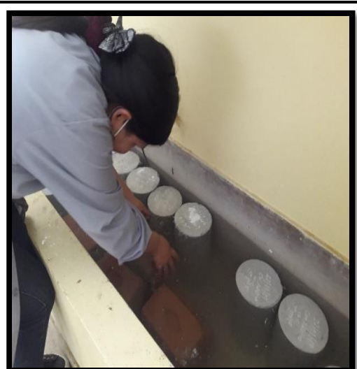
Introducción de los ladrillos a la poza de agua, durante 24 horas, para el ensayo de Absorción.
