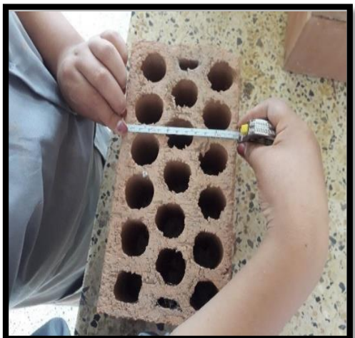
Medición del ancho del ladrillo, para el ensayo de variación dimensional.
