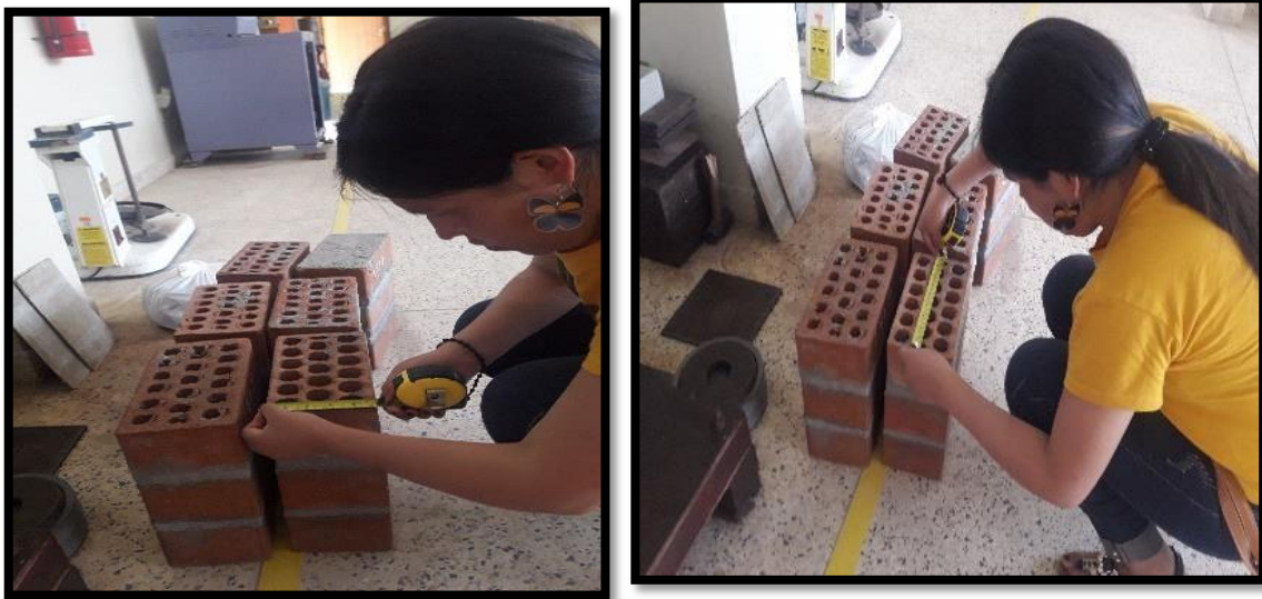
Figura 18. Medición de las dimensiones del prisma
