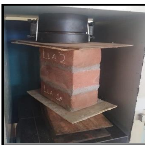
Ensayo de Compresión en pilas.
