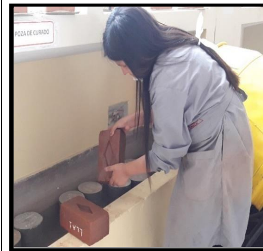
Retiro de los ladrillos de la poza de agua.
