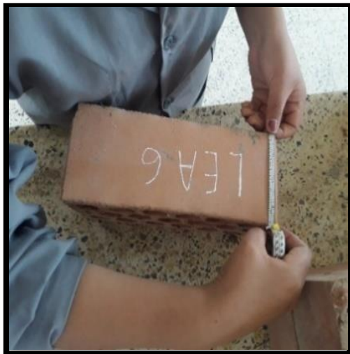
Medición de la altura del ladrillo, para el ensayo de variación dimensional.
