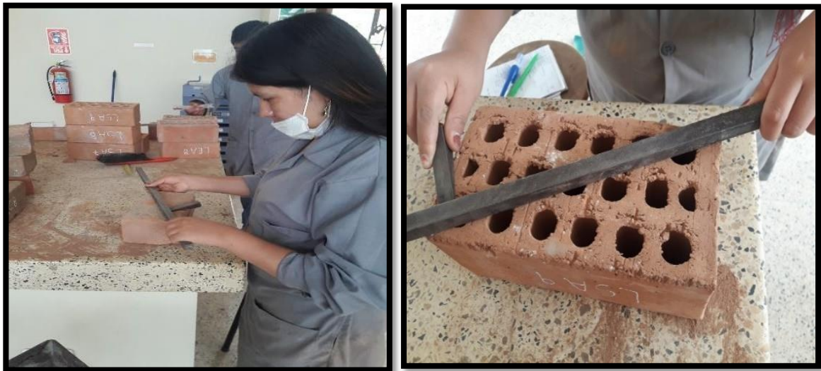
Figura 16. Midiendo la concavidad del ladrillo, con la cuña metálica
