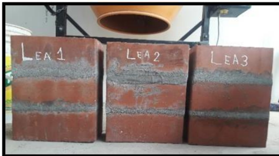
Figura 6. Ensayo de prisma de la ladrillera industrial Fuente: Elaboración propia
