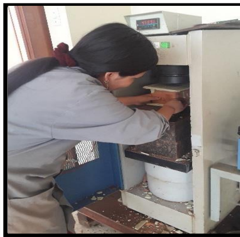
Vista panorámica que se realizó el ensayo de Resistencia a la Compresión.
