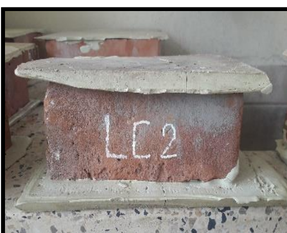
Bañado del ladrillo Canales, parte superior e inferior, antes del ensayo a la Compresión.
