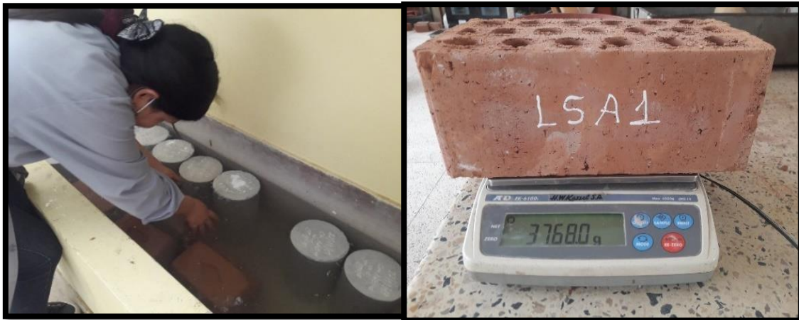
Figura 12. Introduciendo los ladrillos a la poza de agua y pesaje de ladrillo húmedo
