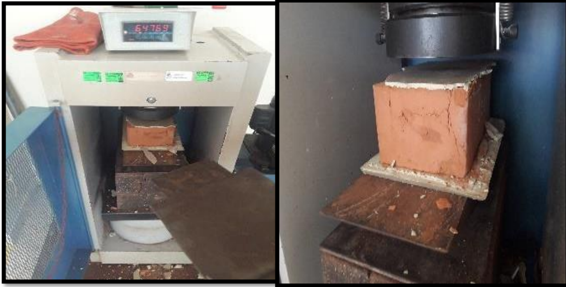
Figura 10. Prueba de esfuerzo a la compresión
