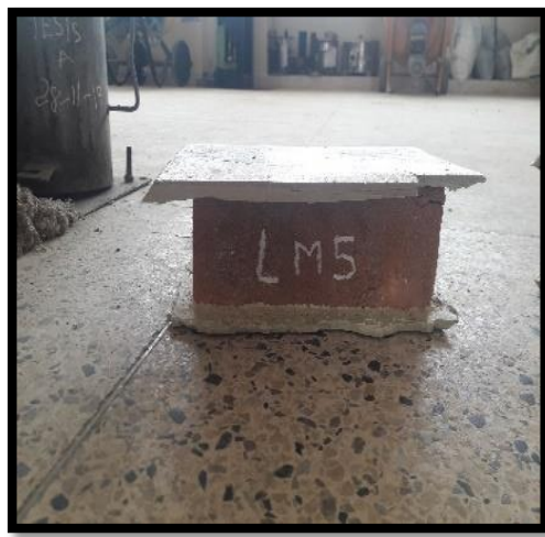
e inferior, antes del ensayo a la Compresión.
