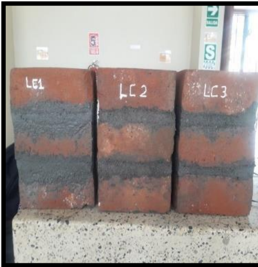
Ensayo de Compresión en pilas de la ladrillera Canales
