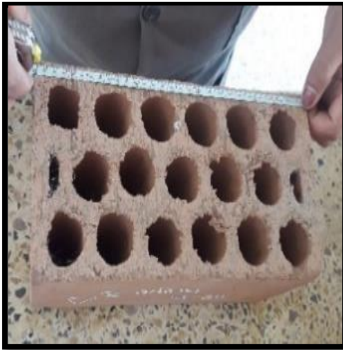
Medición del largo del ladrillo, para el ensayo de variación dimensional.
