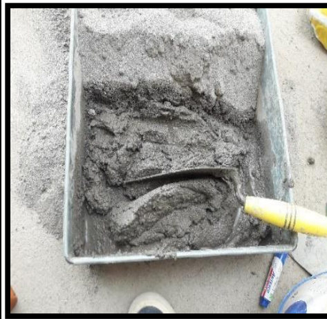
Mezcla del mortero para el ensayo de Compresión en pilas.
