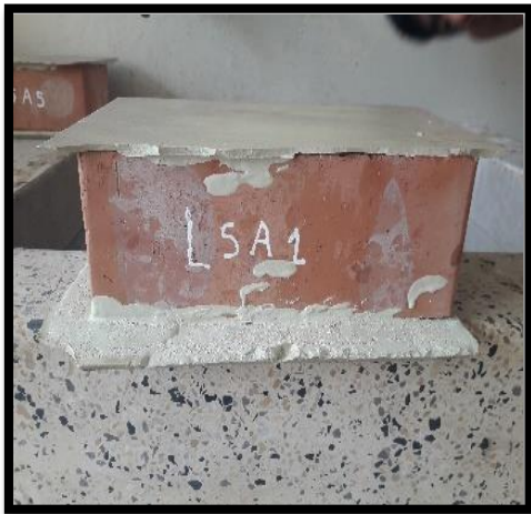
Bañado del ladrillo Santa angelica, parte superior e inferior, antes del ensayo a la Compresión.
