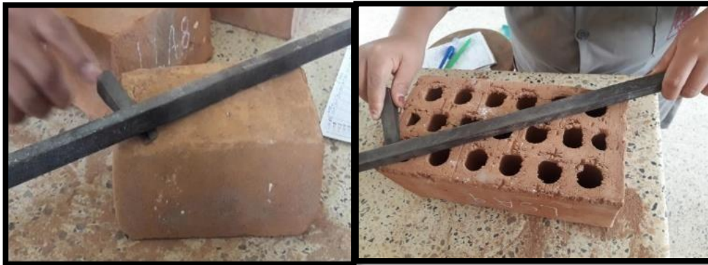
Figura 2. Medición del alabeo en unidades de albañilería.
