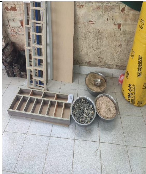
Fotografía N°4: porcentajes de mezclas y moldes de 20x10x5cm
