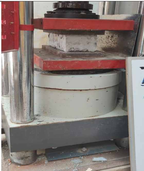
Fotografía N°11: rotura de muestras
