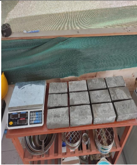
Fotografía N°9: muestras sometidas a ensayo de absorción
