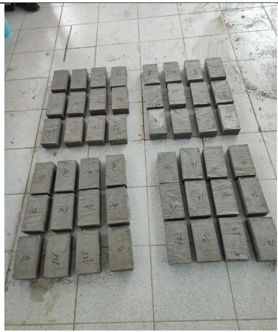
Fotografía N°8: desmoldado de adoquines
