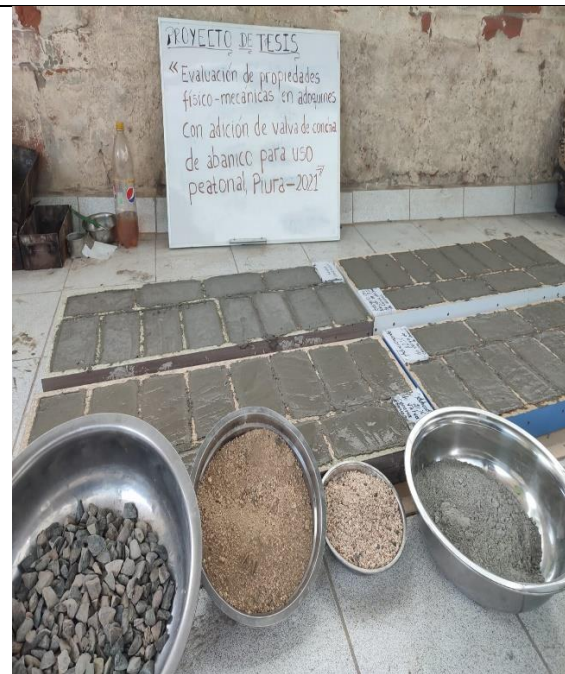
Fotografía N°7: adoquines completamente vaciados
