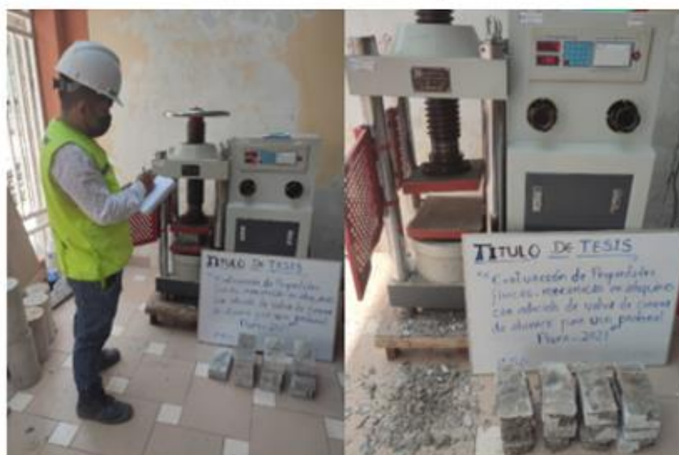
FIGURA 37: ensayo de resistencia a compresion a los 7 dias
