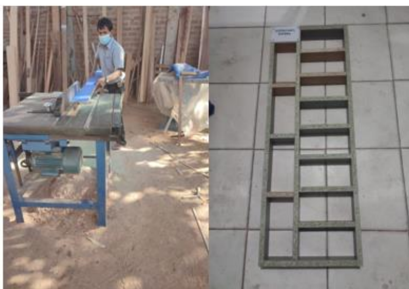
FIGURA 25: elaboración de moldes para los adoquines
