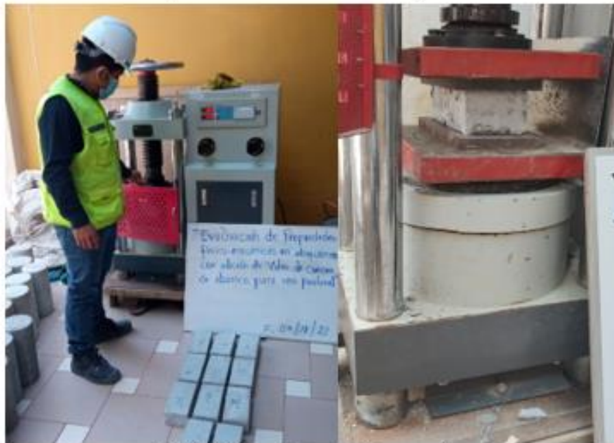
FIGURA 40: ensayo de resistencia a compresión a los 28 días
