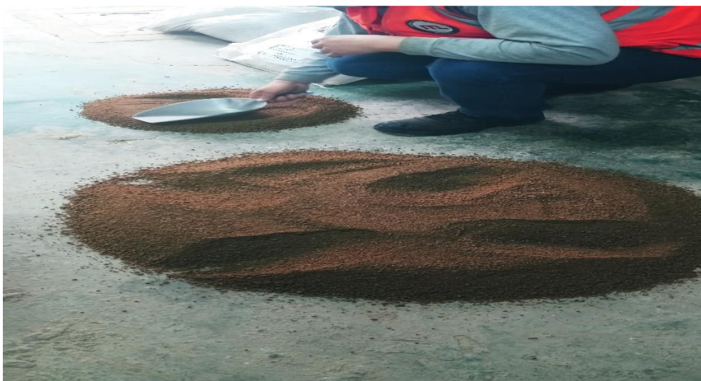
Figura 10. Método de cuarteo para seleccionar muestra representativa.
