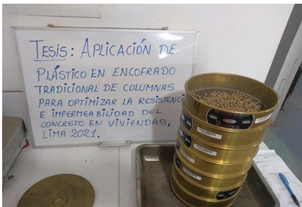
Figura 11. Proceso de tamizado – Método manual.
