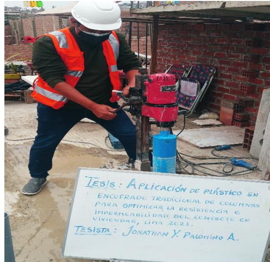
Figura 31. Extracción de testigos diamantinos (14, 21 y 28 días de curado).
