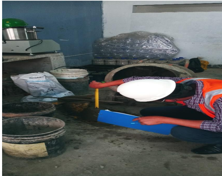
Figura 21. Comprobación del asentamiento 3" a 4" (SI CUMPLE).
