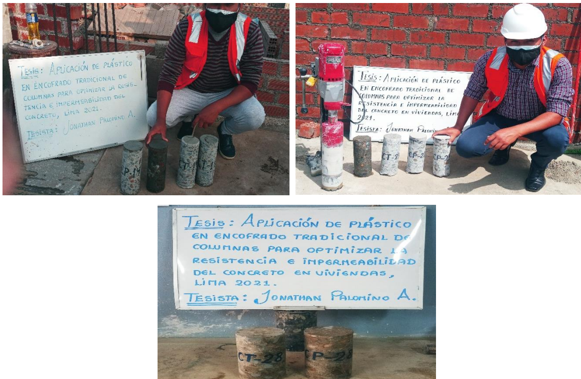
Figura 32. Testigos diamantinos (14, 21 y 28 días de curado).
