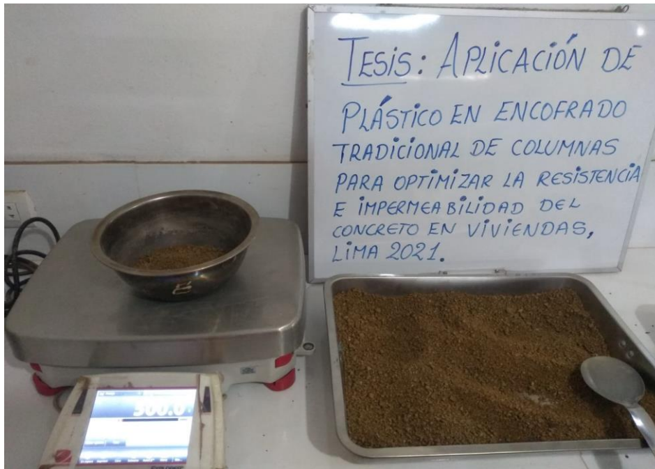
Figura 12. Obteniendo muestra representativa para peso específico.
