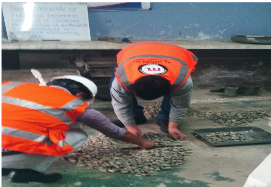
Figura 15. Método de cuarteo para seleccionar muestra representativa.
