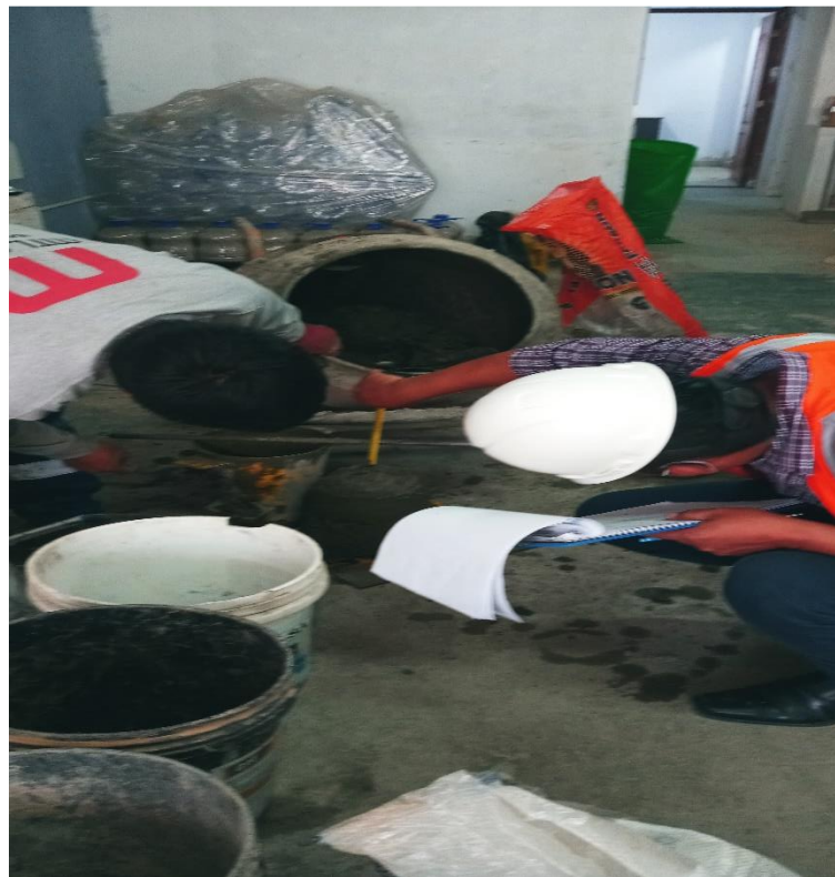
Figura 20. Comprobación del asentamiento 3" a 4" (NO CUMPLE).
