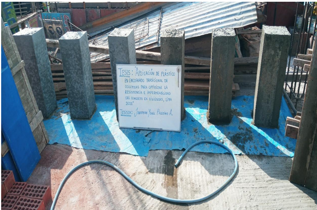
Figura 30. Curado de columnas (14, 21 y 28 días).
