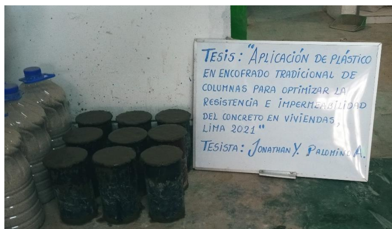
Figura 23. Vaciado de 9 probetas en moldes de 4" x 8".
