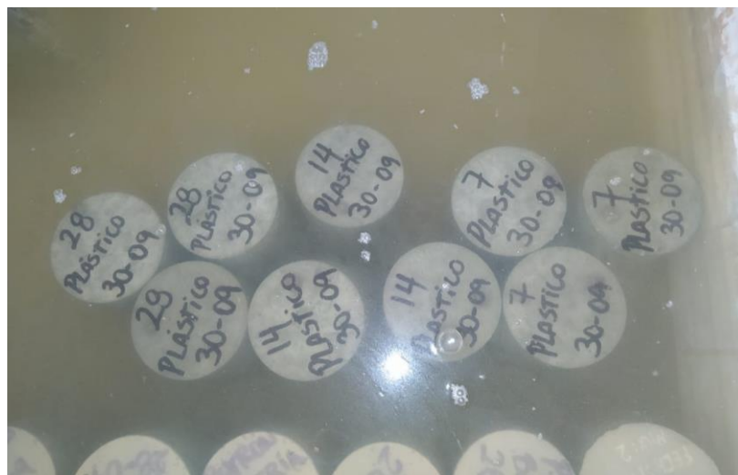
Fig. 25. Curado de las 9 probetas (7, 14 y 28 días de curado).
