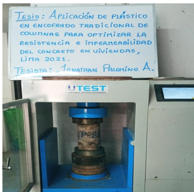
Figura 33. Ensayo de compresión de testigos diamantinos (CT / CP).
