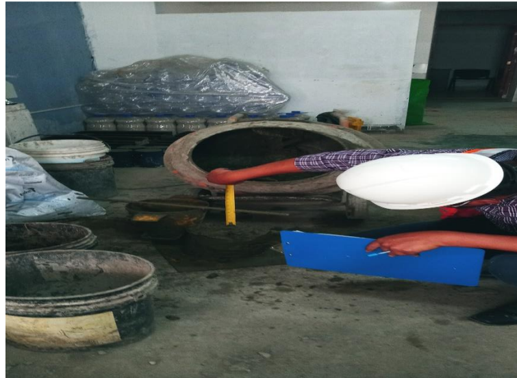
Figura 22. Comprobación del asentamiento 3" a 4" con las nuevas proporciones de agregados (SI CUMPLE).
