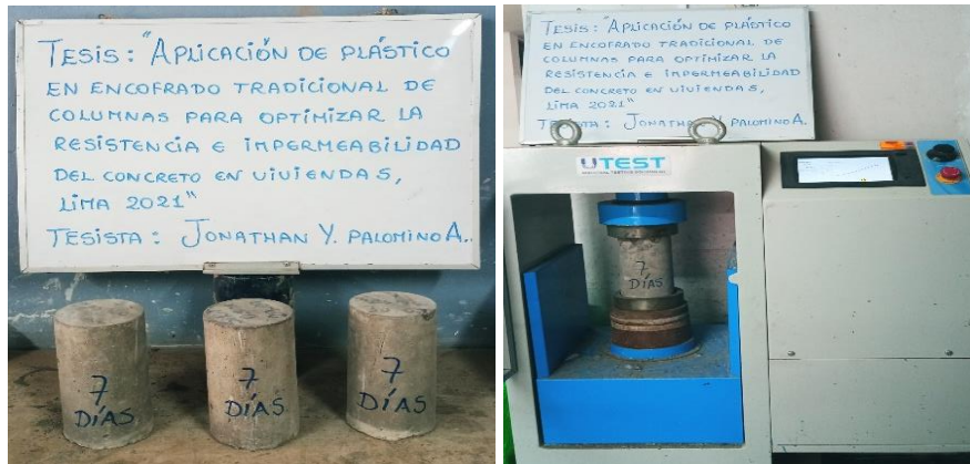
Figura 26. Ensayo compresión 3 probetas (7 días de curado).
