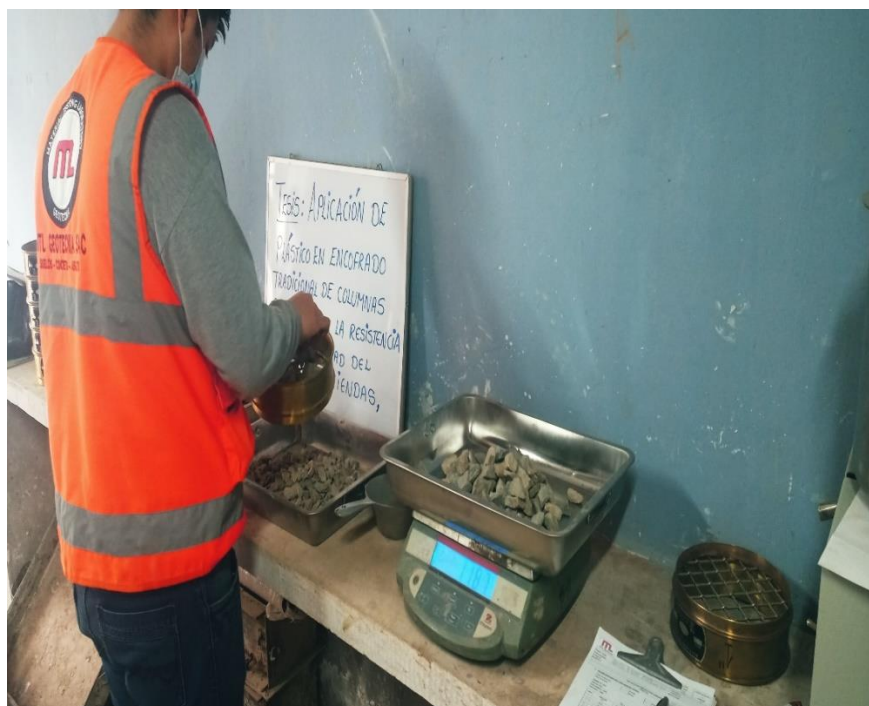
Figura 16. Proceso de tamizado – Método manual.
