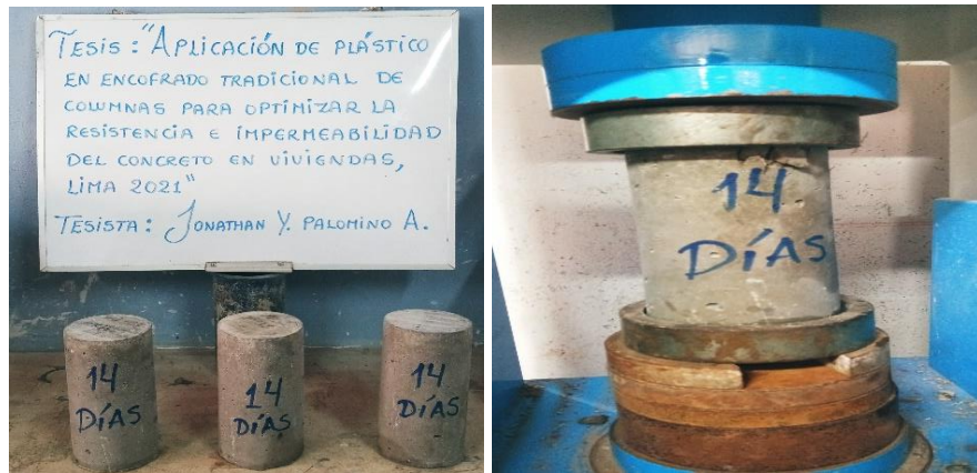
Figura 27. Ensayo compresión 3 probetas (14 días de curado).
