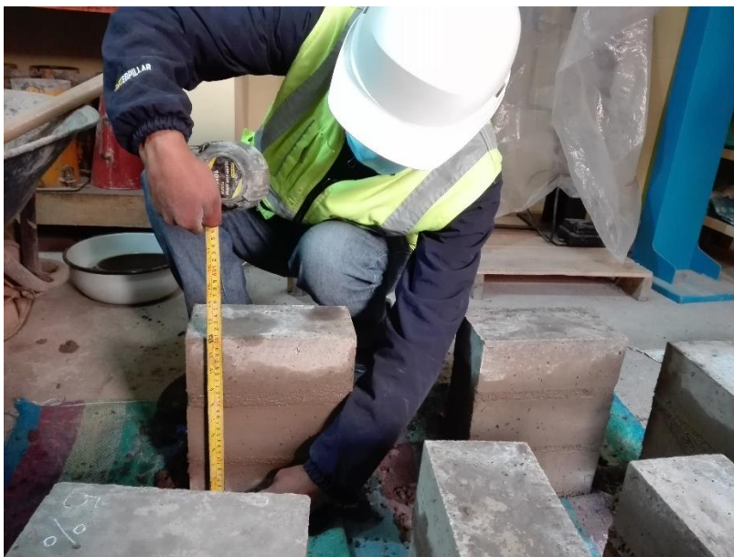
Figura 9: Construcción de pilas de bloque de concreto
