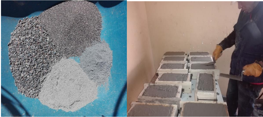
Figura 7: Dosificación y Elaboración de bloques - concreto
