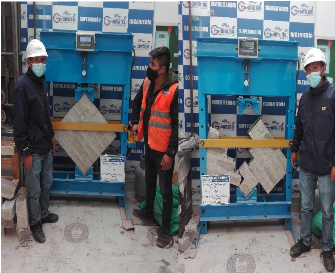
Figura 14: Prueba a compresión diagonal
