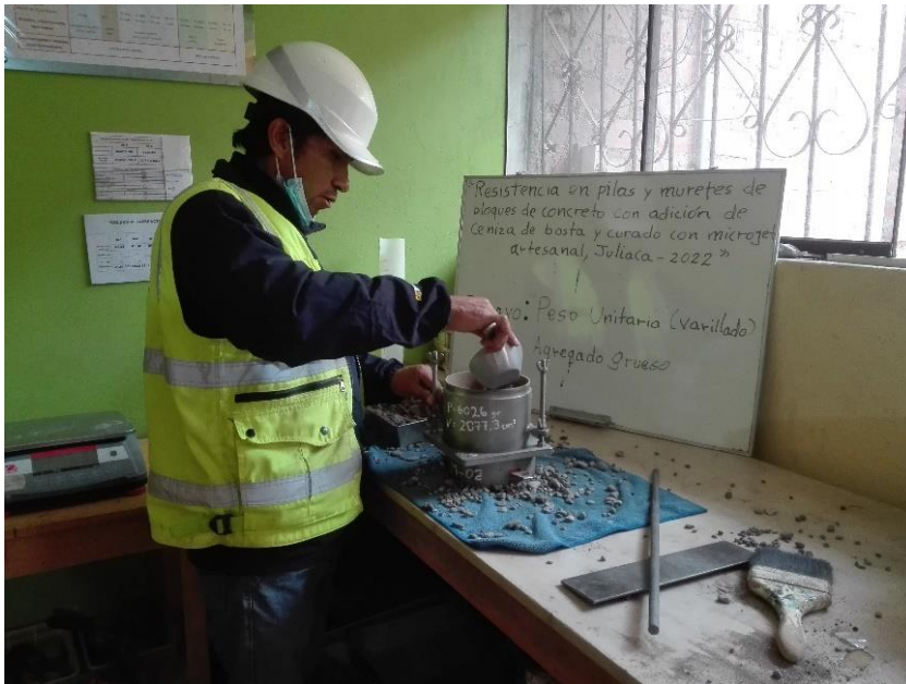
Figura 4: Procedimiento de peso unitario
