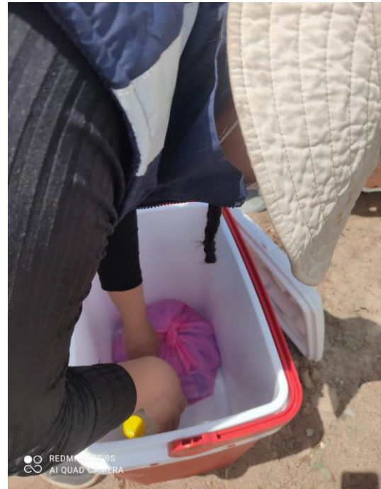
Figura 28. Almacenamiento de muestras en el culer para el traslado al laboratorio.
