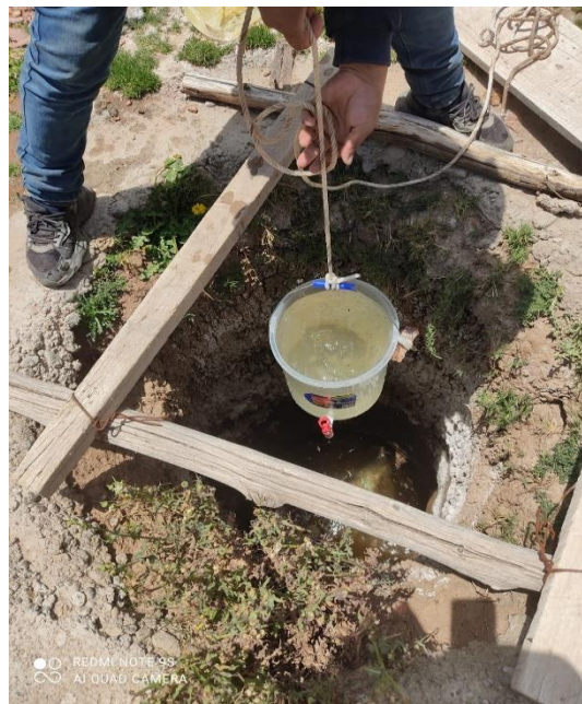
Figura 26. Extracción de muestras los parámetros físicos del pozo
