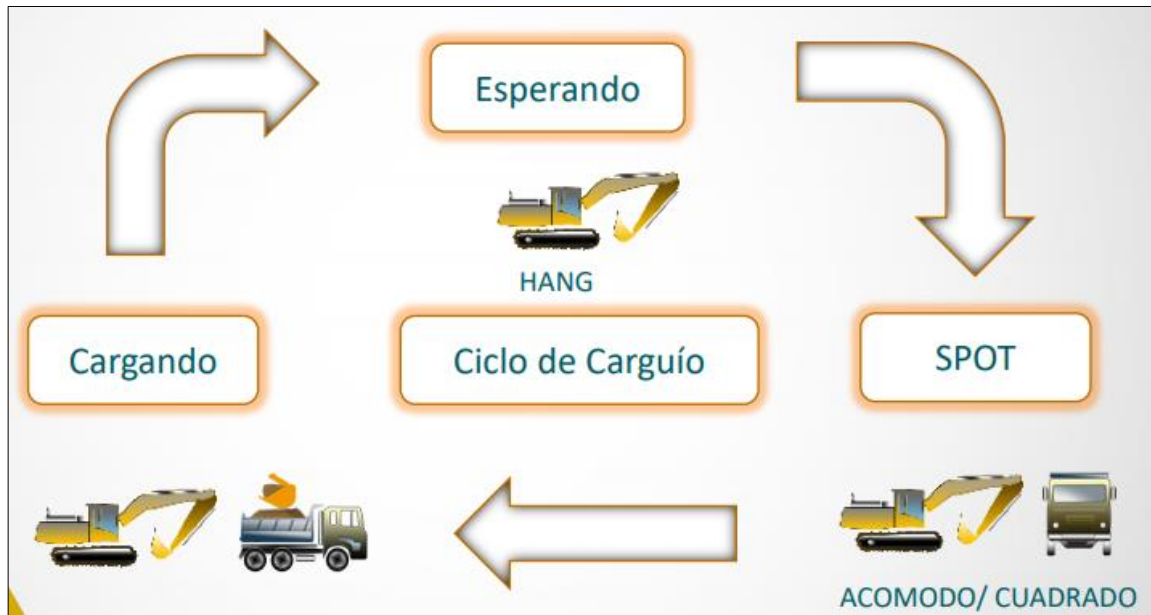
Figura 82. Estado de los equipos con control sense.
