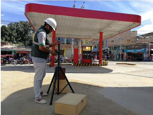
Fotografía 1: Instalación del trípode para la colocación del tren de muestreo para la medición de gases.
