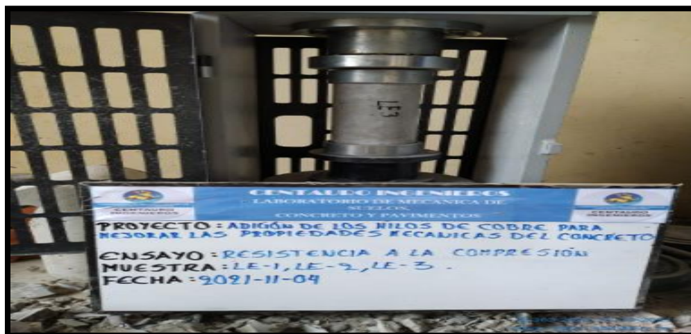
Figura 20. Ensayo de resistencia a la compresión
