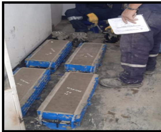
Figura 19. Elaboración de vigas de concreto
