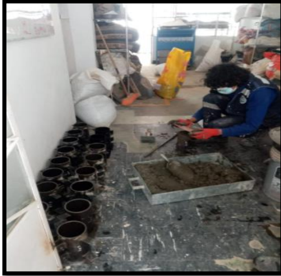
Figura 18. Elaboración de las probetas cilíndricas
