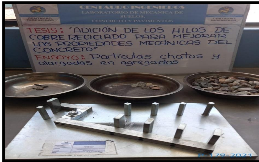
Figura 14. Partículas chatas y alargadas en agregados
