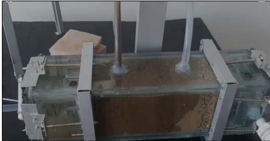
Figura 34: Saturación de la muestra
