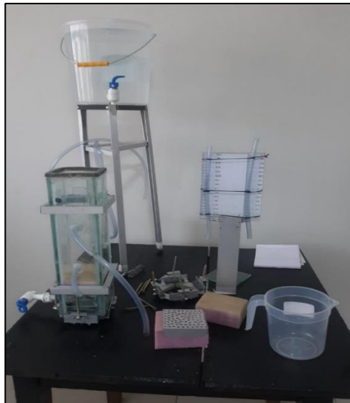
Figura 30: Prototipo de Permeámetro
