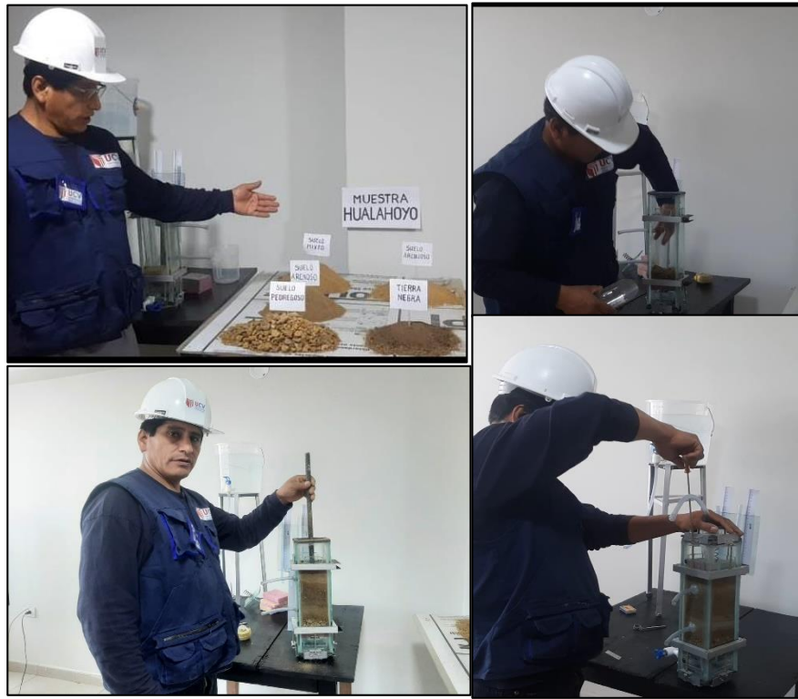
Figura 32: Carga del permeámetro por muestra de suelo.
