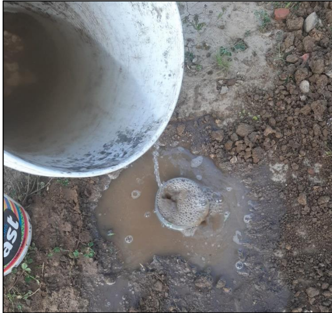
Figura 28: Inicio con la prueba a carga constante
