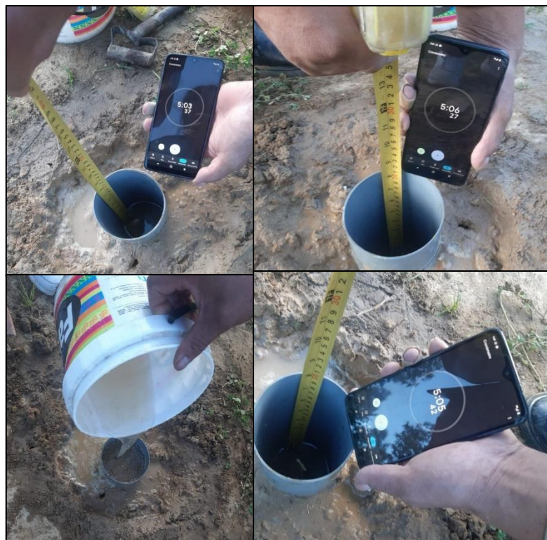
Figura 29: Proceso de medición al llenado de agua a carga constante
