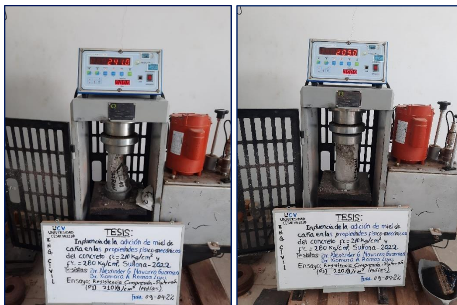
Figura 33: Ensayo de resistencia a la compresión a los 14 días de muestra patrón y dosificadas con miel de caña - f'c=210\text{kg/cm}^2 .
