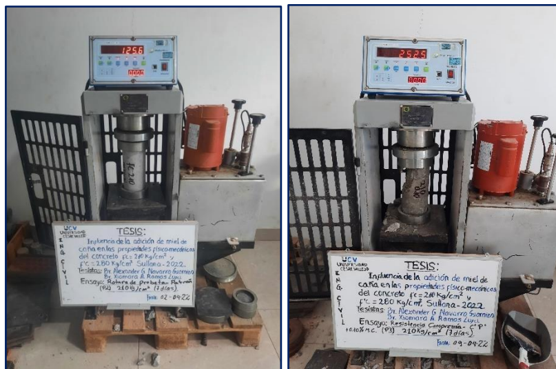
Figura 31: Ensayo de resistencia a la compresión a los 7 días de muestra patrón y dosificadas con miel de caña - f'c=210\text{kg/cm}^2 .
