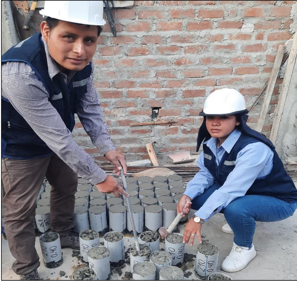
Evidencia N°07: Elaboración de muestras de concreto patrón y dosificadas con miel de caña.
