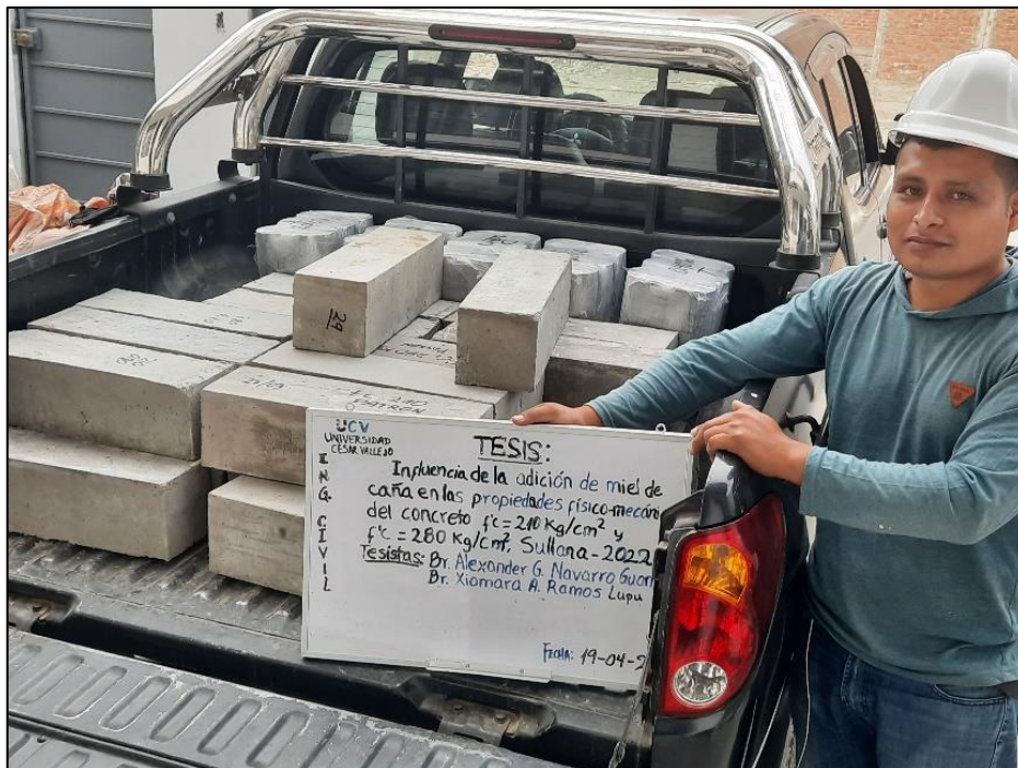
Evidencia N°08: Briquetas y vigas prismáticas para ensayar en Laboratorio.
