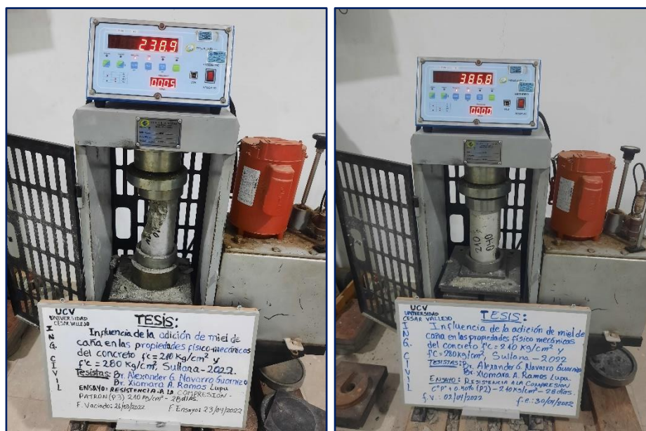
Figura 35: Ensayo de resistencia a la compresión a los 28 días de muestra patrón y dosificadas con miel de caña - f'c=210\text{kg/cm}^2 .
