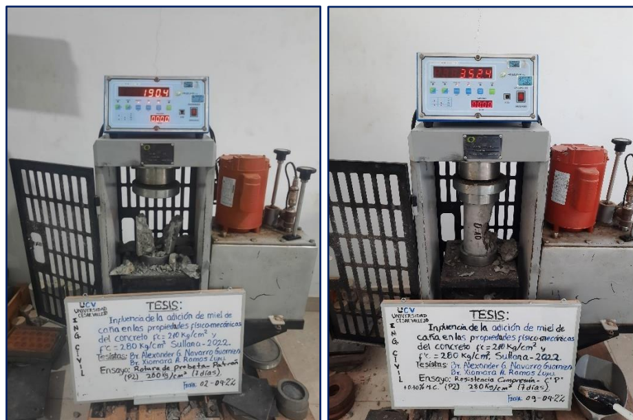
Figura 37: Ensayo de resistencia a la compresión a los 7 días de muestra patrón y dosificadas con miel de caña - f'c=280\text{kg/cm}^2 .
