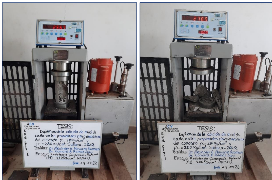
Figura 39: Ensayo de resistencia a la compresión a los 14 días de muestra patrón y dosificadas con miel de caña - f'c=280\text{kg/cm}^2 .
