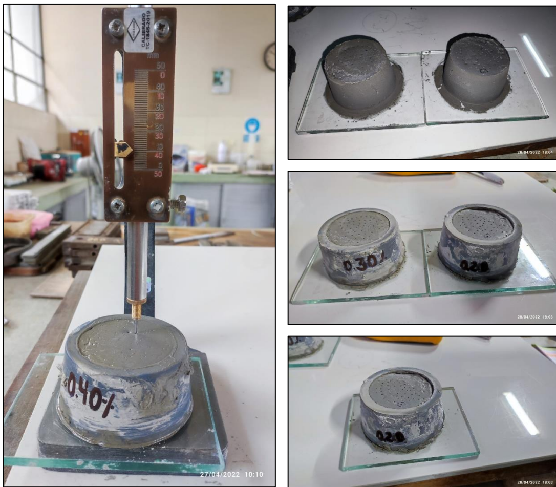
Figura 28: Ensayo de determinación de tiempo de fraguado.
