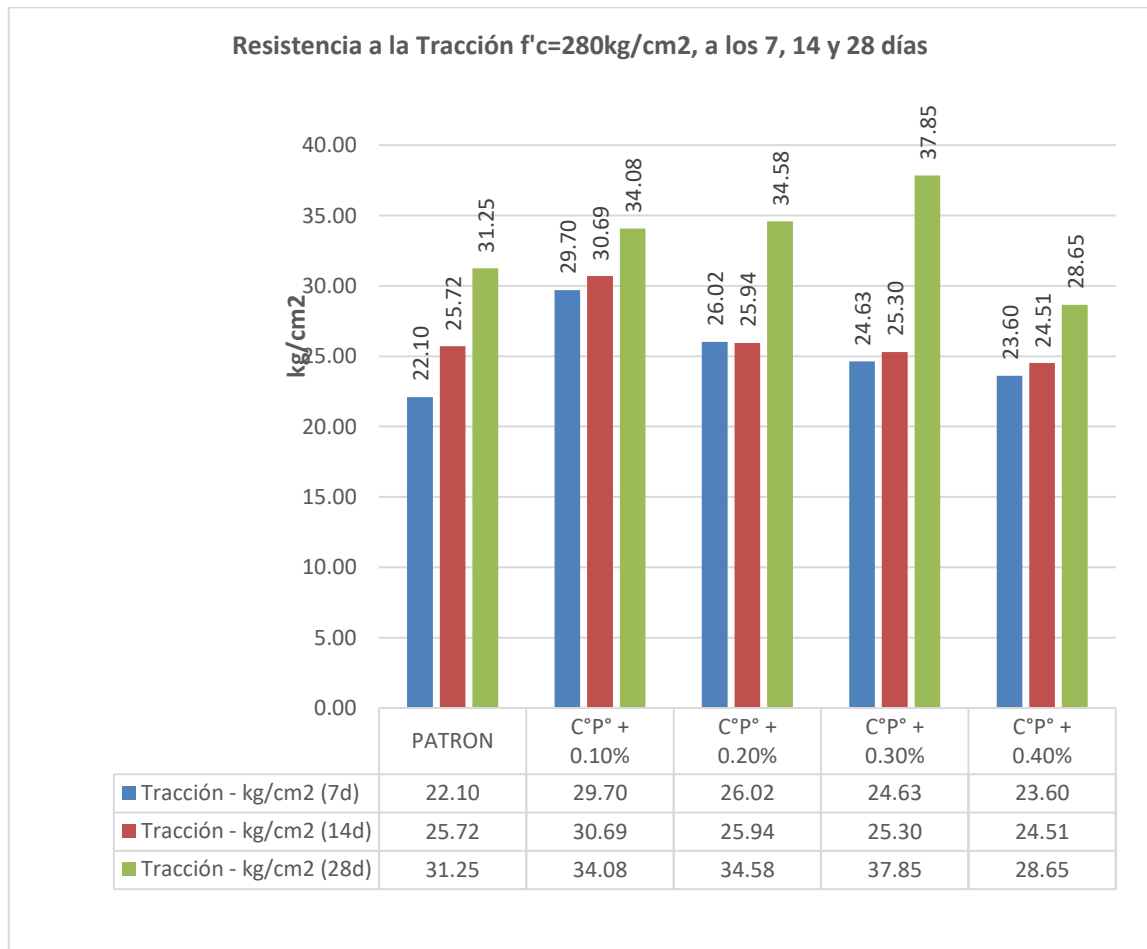
Figura 64: Resistencia a la tracción f'c=280\text{kg/cm}^2 , con dosificaciones de miel de caña.
