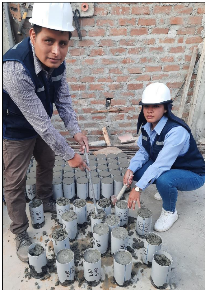
Figura 21: Preparación de briquetas en los moldes de 4"x 8".
