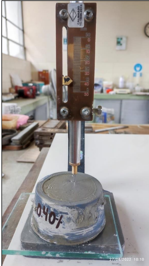
Evidencia N°05: Ejecución de ensayo de determinación de tiempo de fraguado por aguja vicat.
