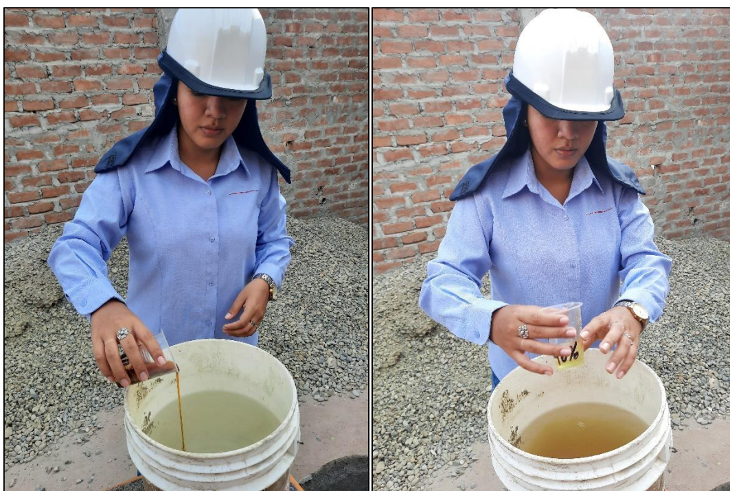
Figura 20: Dilución de la miel de caña en el agua de amasado.
