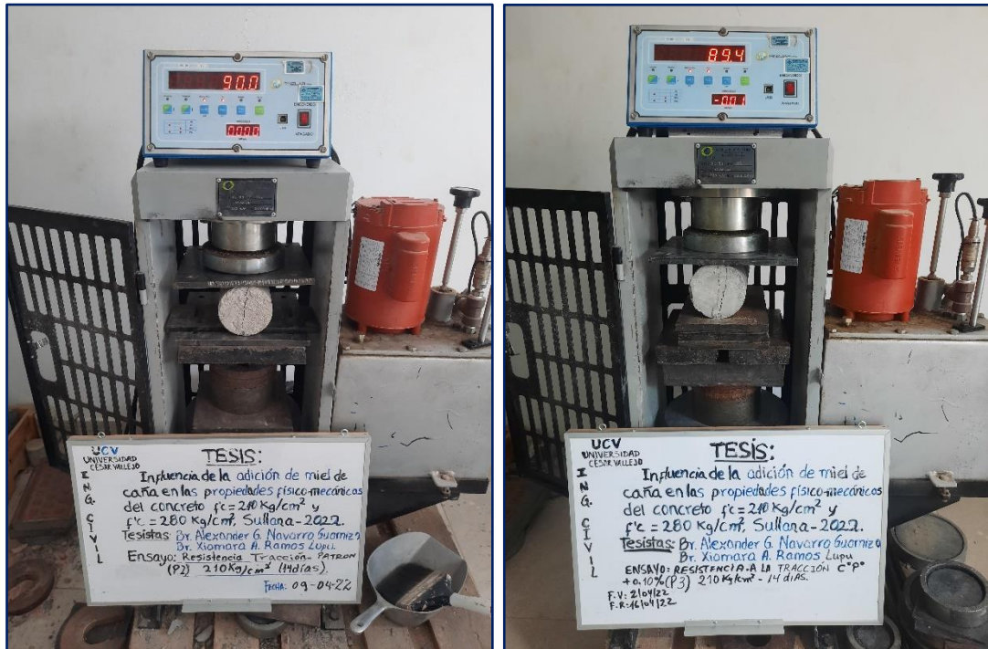
Figura 45: Ensayo de resistencia a la tracción indirecta a los 14 días de la muestra patrón y dosificadas con miel de caña - f'c=210\text{kg/cm}^2 .
