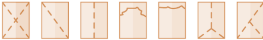
Ejemplos de falla del ensayo de compresión.
