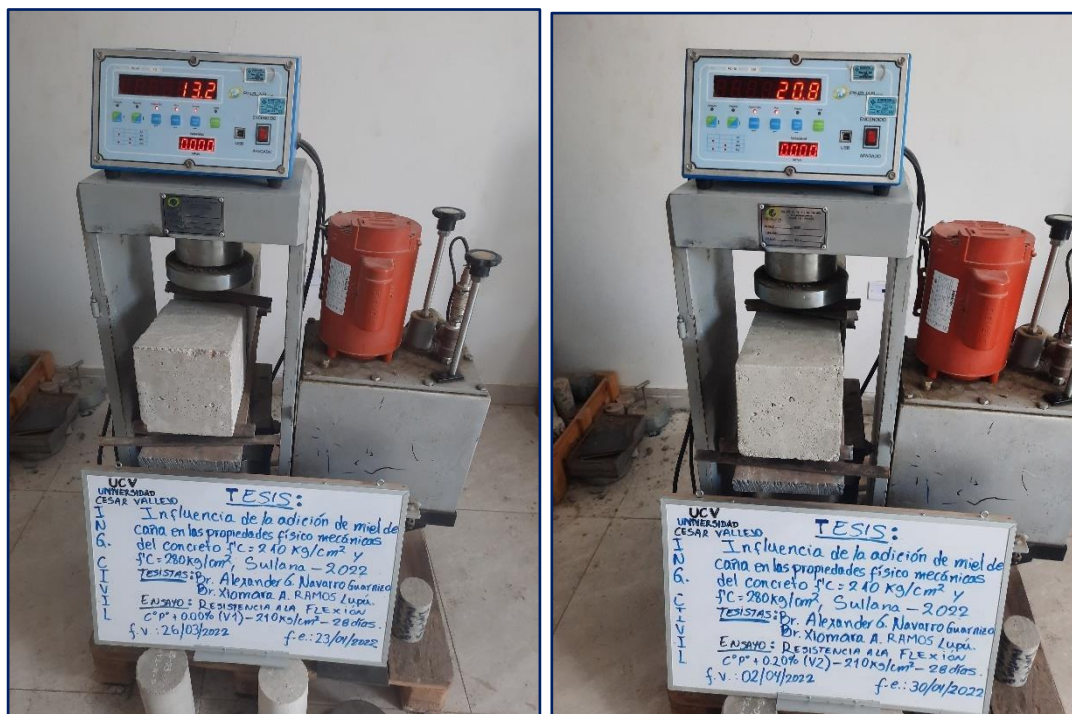
Figura 55: Ensayo de resistencia a la flexión a los 28 días de la muestra patrón y dosificadas con miel de caña - f'c=210\text{kg/cm}^2 .
