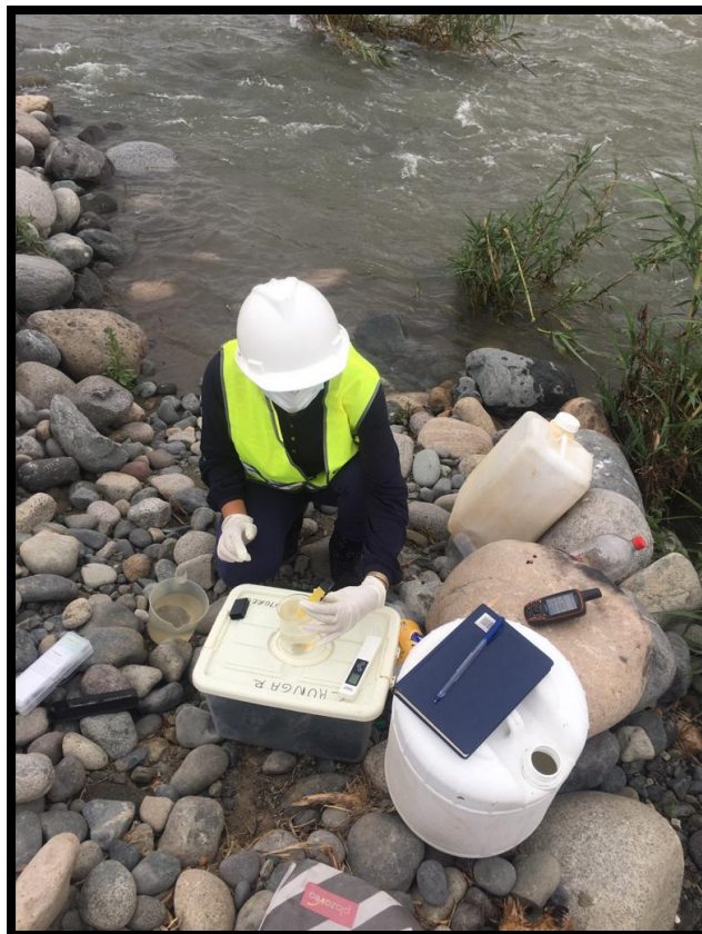
Imagen 26: Muestra de agua bocatoma de Huayan para monitoreo de parámetros en campo
