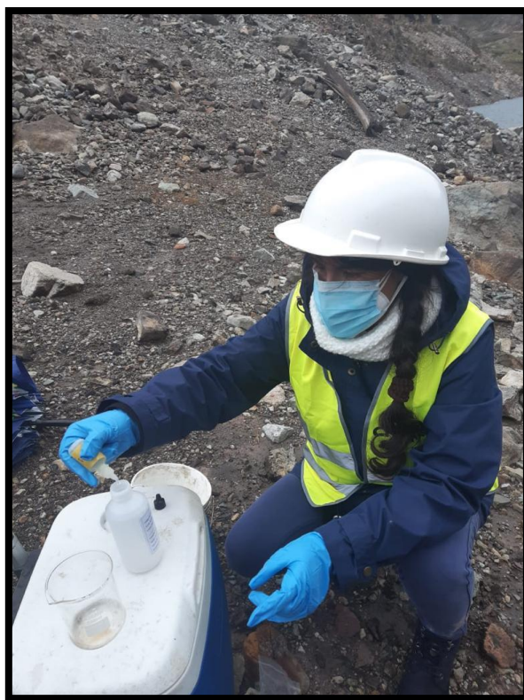
Imagen 17: Agregando preservante \text{HNO}_3 a muestra de agua para conservación hasta entrega en Laboratorio
