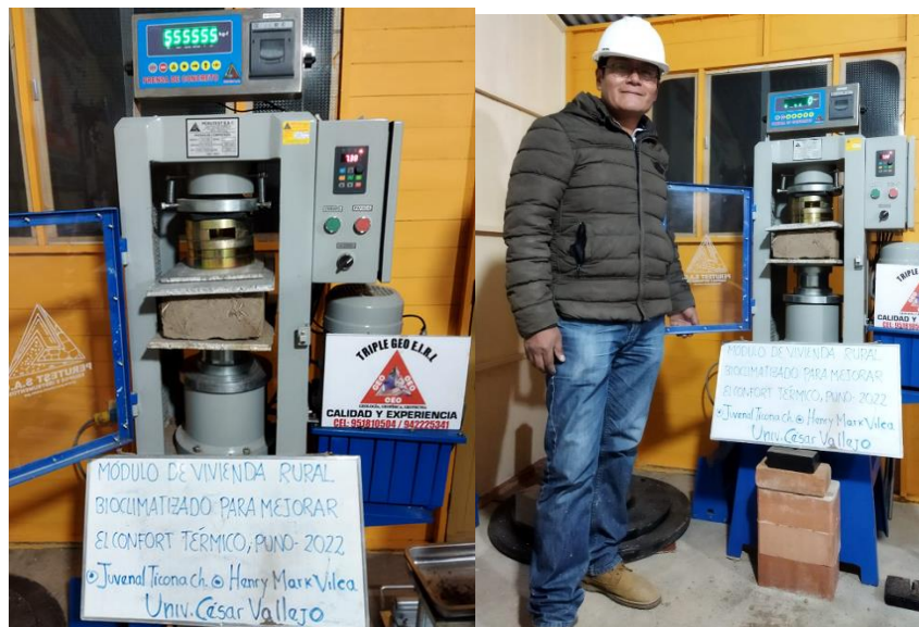
Figura 59: Ensayo a la rotura del adobe
