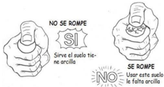
Figura 21: Prueba de resistencia seca Fuente: Norma E.080
