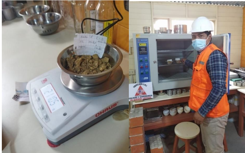
Figura 62: Determinación del contenido de humedad del suelo a intervenir – Viluyo, Pichacani, Puno -2022
