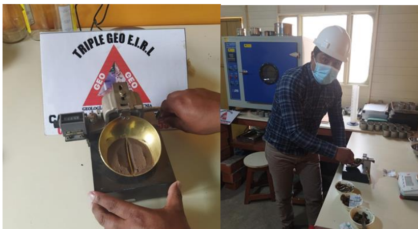
Figura 61: Realización de los ensayos de límites de consistencia, suelo Viluyo
