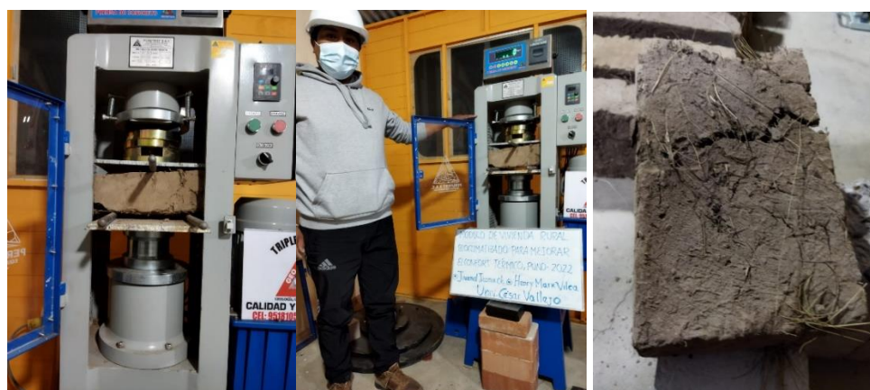
Figura 58: Ensayo de flexión del adobe
