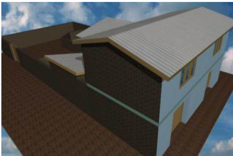
Figura 2: Prototipo de vivienda con adobe PET para mejorar el confort térmico.
