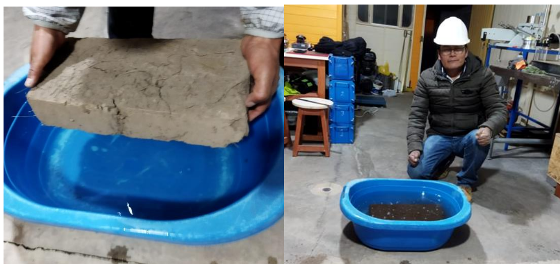
Figura 57: Ensayo de absorción del adobe
