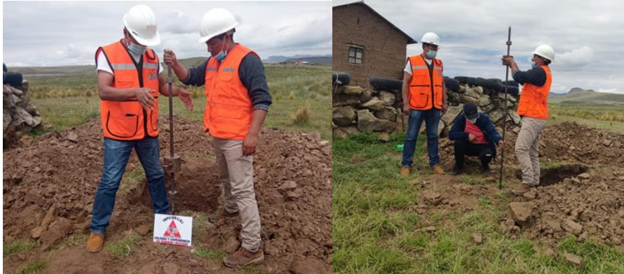
Figura 63: Aplicación del método DPL para determinar capacidad portante del suelo a intervenir – Viluyo, Pichacani, Puno - 2022
