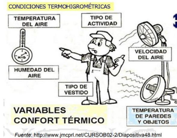
Figura 32: Variables del confort térmico Fuente. Humpiri (2016).
