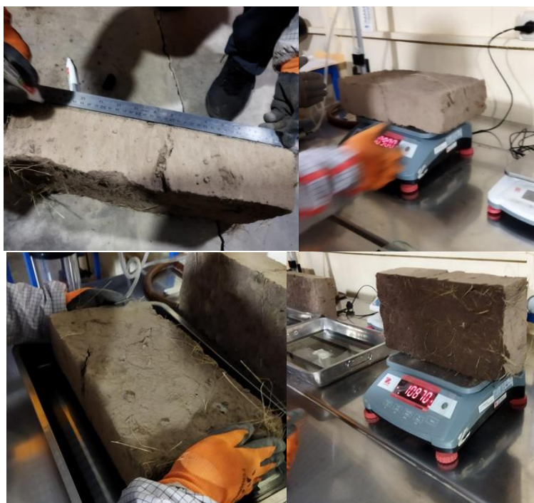
Figura 56: Ensayo de succión del adobe
