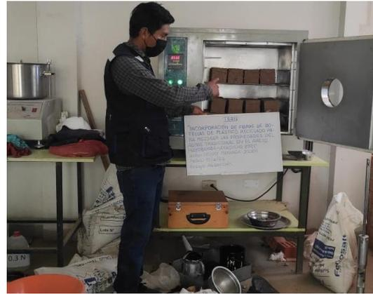
Figura 41. Secado de espécimen cúbicos.
