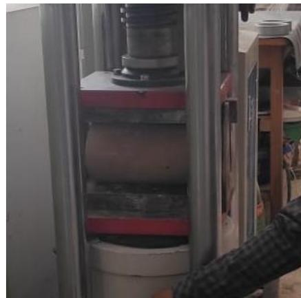
*Figura 55. Inicio de rotura de probeta cilíndrica.*
