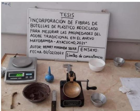
**Figura 26.** Ensayo de límite de
