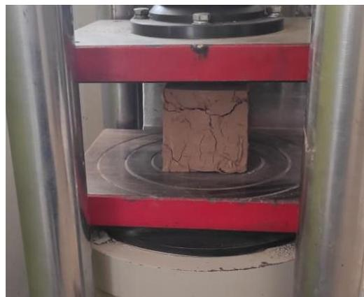
**Figura 51.** Rotura de muestra.
