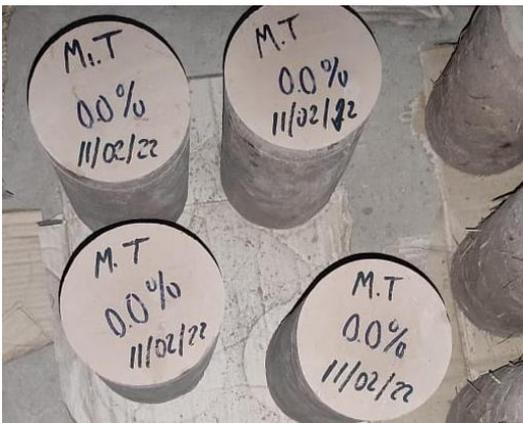
Figura 38. Especímenes cilíndricos con 28 días secadas en un ambiente libre del sol y viento.
