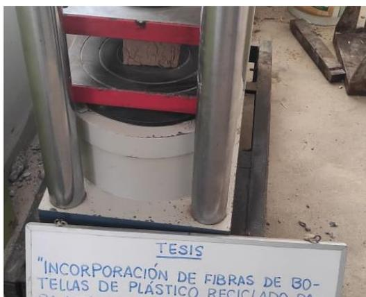
**Figura 50.** Inicio de la rotura de muestra cubicas.
