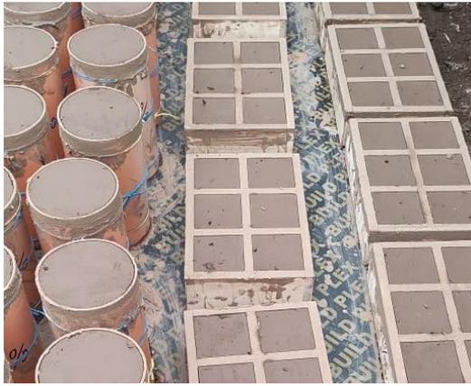
Figura 34. Secado de muestras cúbicas y cilíndricas.
