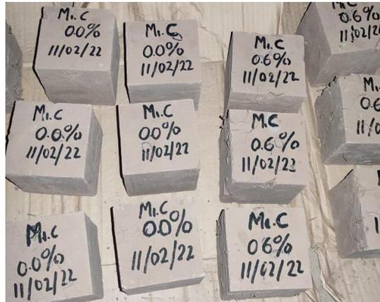
Figura 37. Especímenes cúbicas con 14 días secadas en un ambiente libre del sol y viento.
