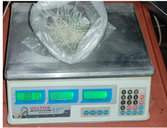
*Figura 29.* Pesado de fibra de botellas de plástico por dosificación.
