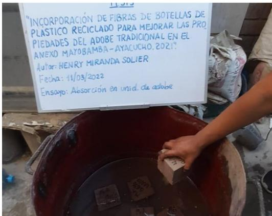
Figura 44. Sumergido de espécimen en agua.
