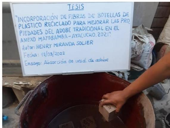
*Figura 17.* Ensayo absorción de agua de los especímenes.
