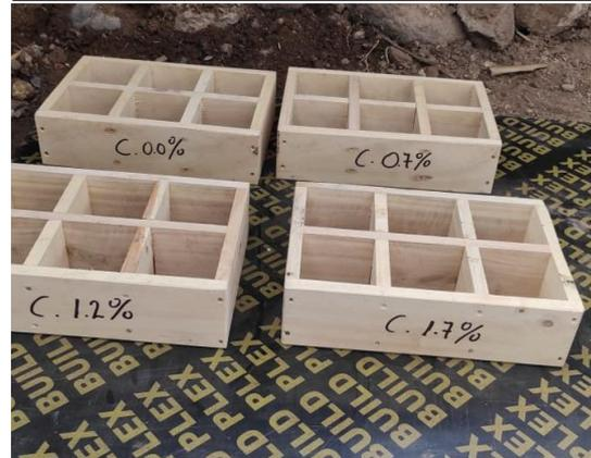
*Figura 31.* Moldes de espécimen para el ensayo de compresión.
