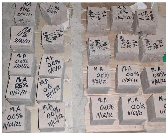
Figura 39. Especímenes cúbicas con 28 días secadas en un ambiente libre del sol y viento.
