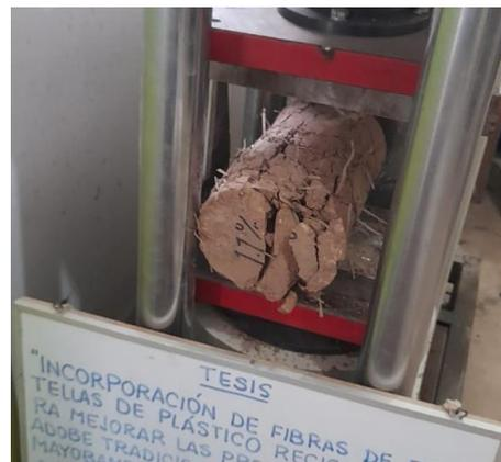
*Figura 57. Rotura de probeta.*
