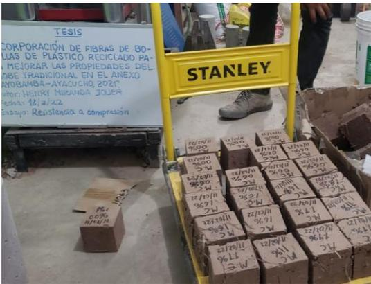
**Figura 48.** Especímenes al con 28 días de secado.
