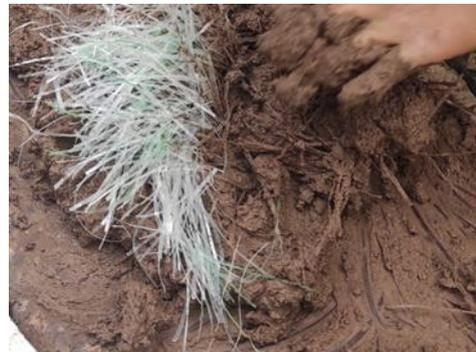
*Figura 3.* Incorporación de fibra de botellas de plástico reciclado al barro según porcentajes.
