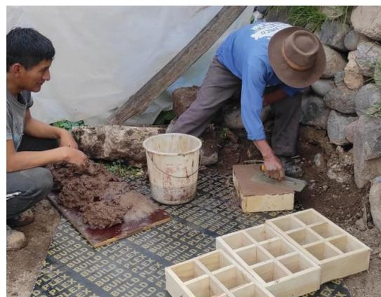
*Figura 33.* Fabricación de muestras cubicas.
