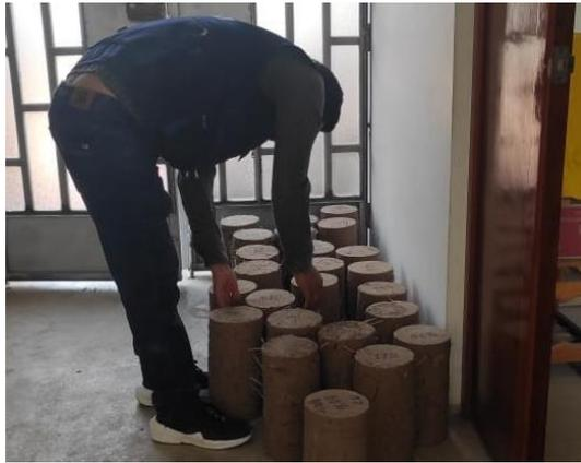
*Figura 52. Secado de muestras cilíndricas.*
