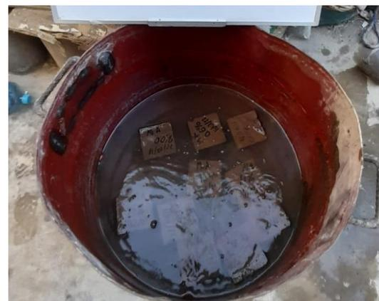
Figura 45. Muestras sumergidas en agua durante 24 horas.
