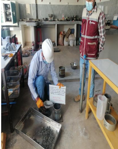
Figura 4.5 Ensayo Proctor Modificado adicionando Escoria de Acero
