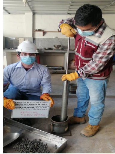
Figura 4.6 Punzonamiento para el ensayo Proctor Modificado
