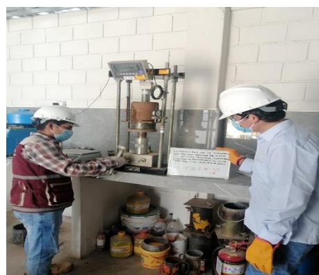
Figura 4.9 Punzonamiento con pistón para el Ensayo de Californian Bearing Ratio
