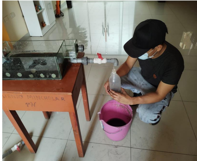
Figura 6: Obteniendo resultados después de remover con cenizas de cacao.
