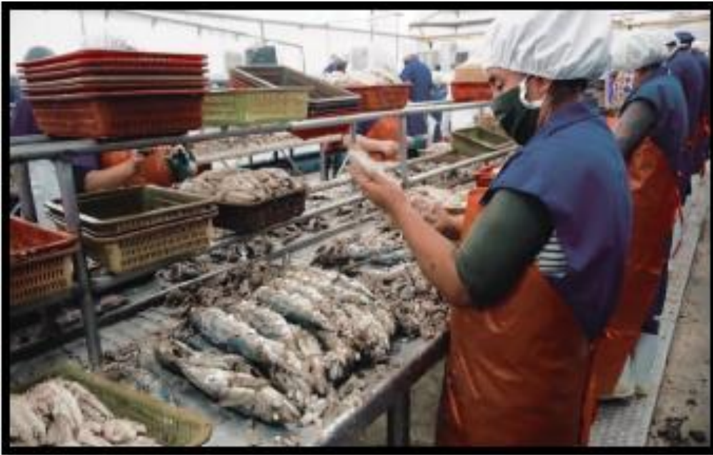
Figura 16. Proceso de fileteado antes de la mejora de métodos de trabajo
